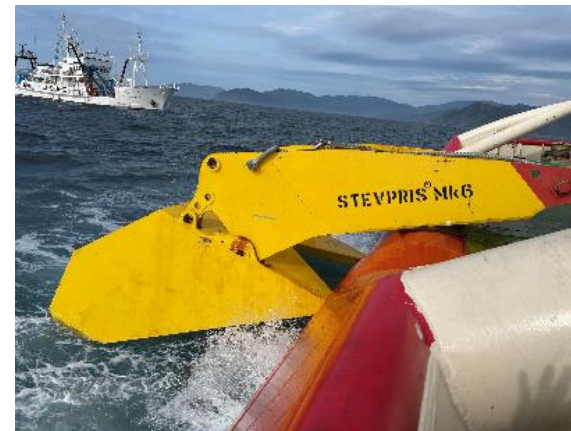
船尾からのアンカー投入状況
