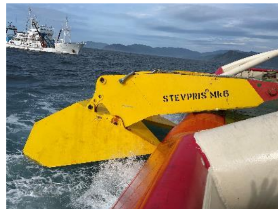
船尾からのアンカー投入状況
