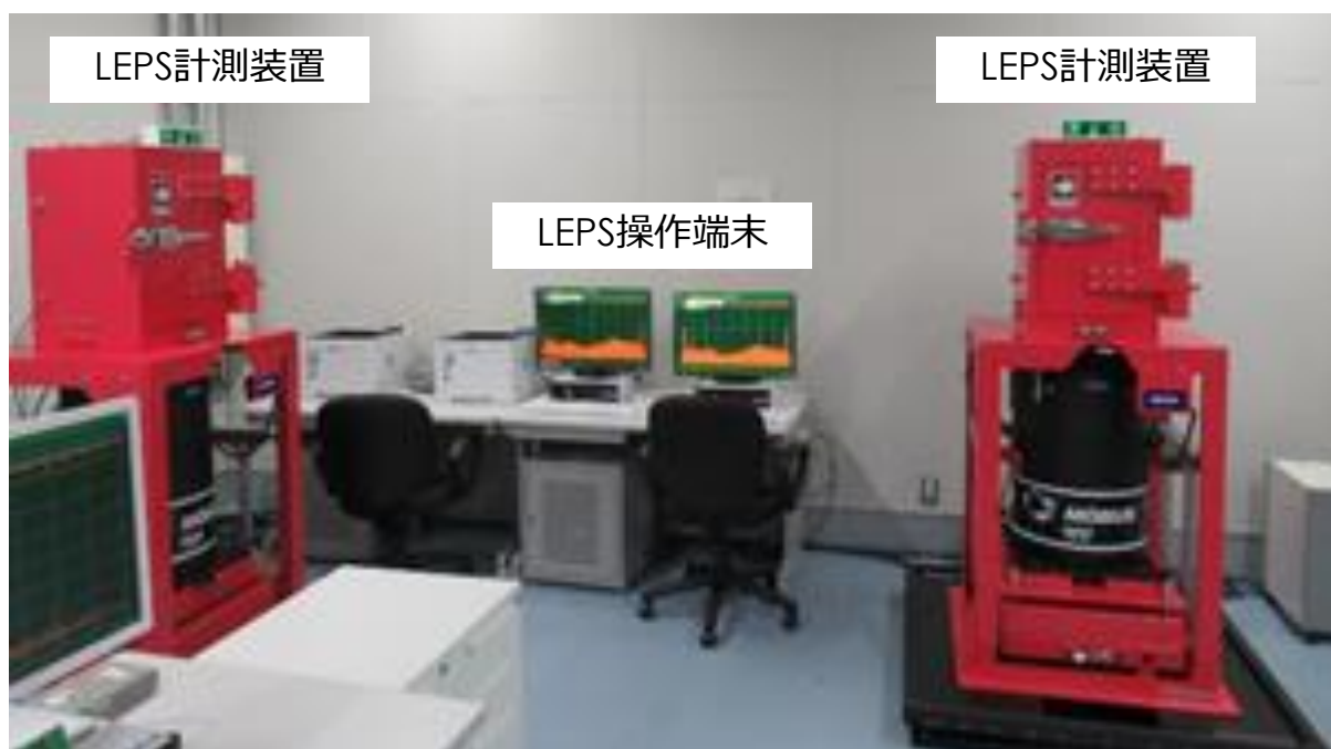
図 24 低エネルギー光子用ゲルマニウム半導体検出器の設置状況(化学分析棟計測室)
