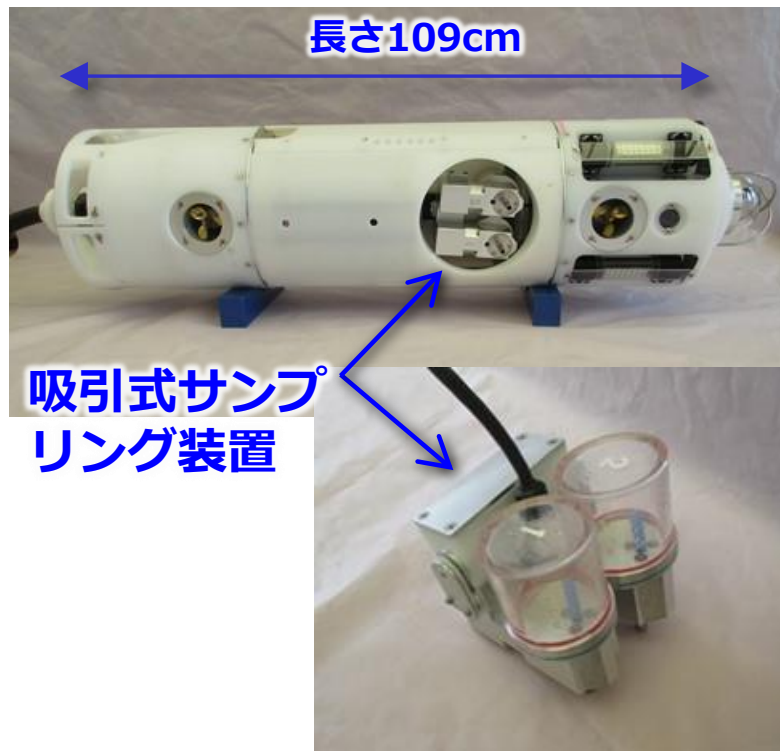
図 15 調査装置ROV-E(堆積物サンプリング用)
