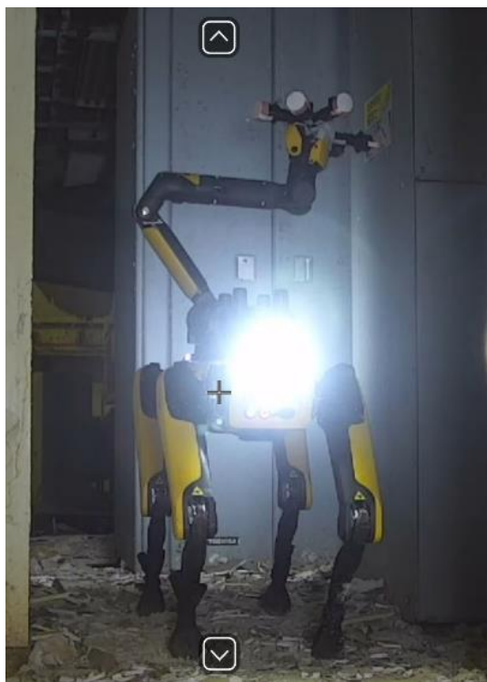
図 27 遠隔操作ロボットによるスミア紙でのふき取り調査
