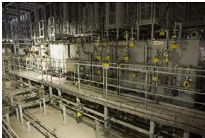
図 1 増設多核種除去設備
