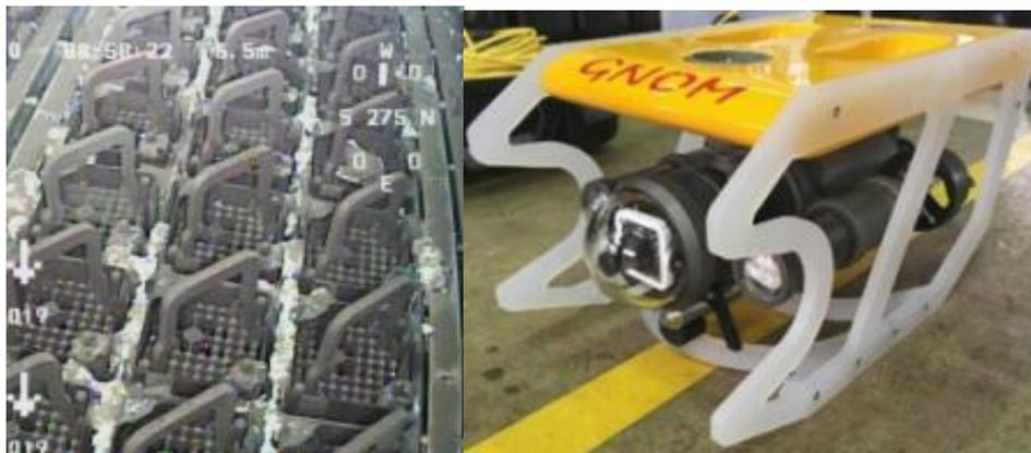
図 15 燃料・燃料ラック上部及び水中ROV
