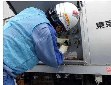
ケーブル接続口確認（電源車操作訓練）
