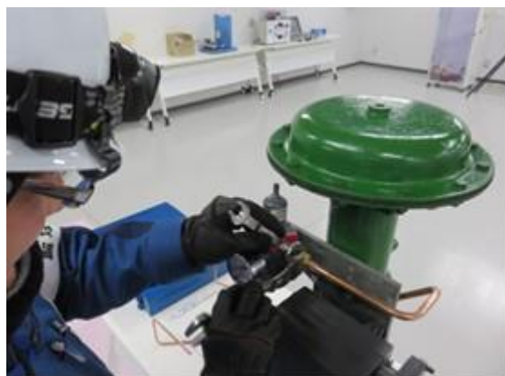
弁・駆動部（AO銅配管加工）訓練
