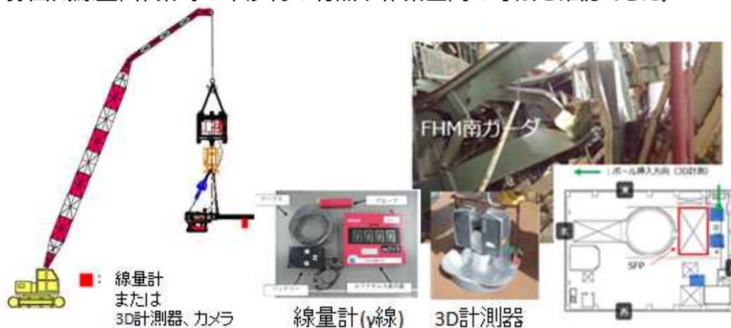
図 1号機オペレーティングフロaSFP周辺の現場調査状況
