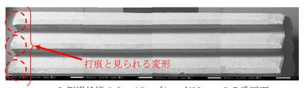
L側過給機のタービンブレードNo. 25受圧面
