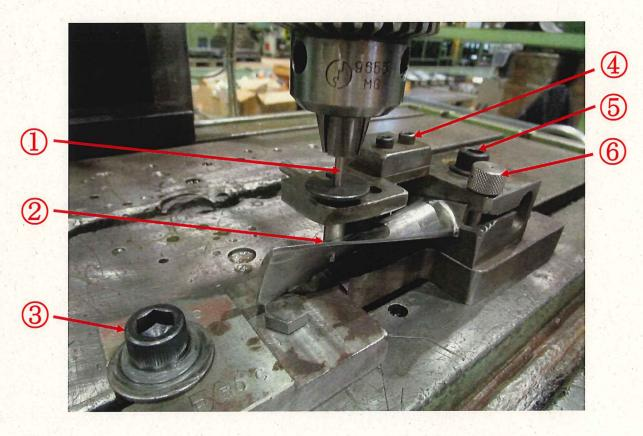
参考 タービンブレードレーシングワイヤ孔加工状況 (再現)
