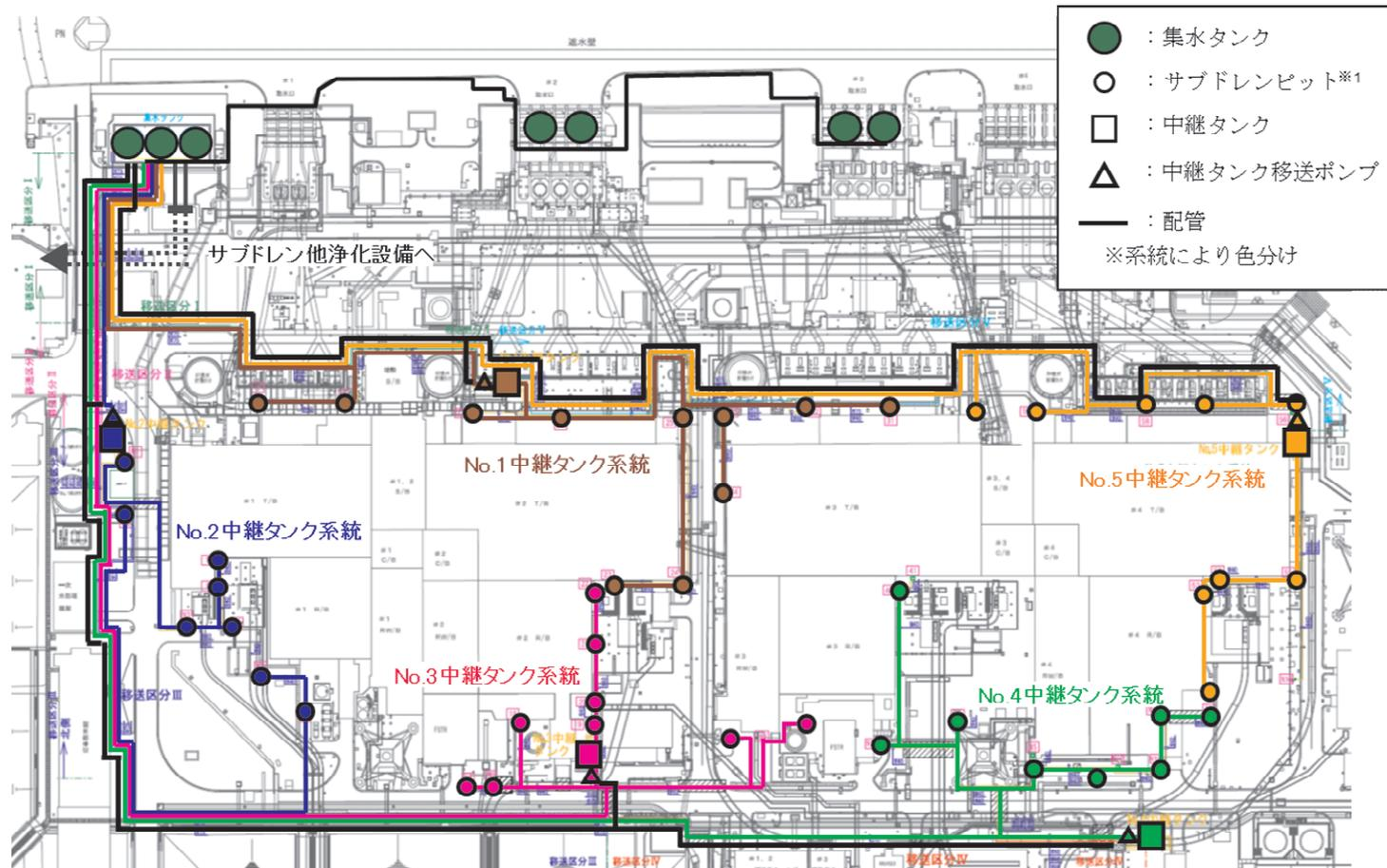
※1 揚水ポンプは、サブドレンピット内部に設置されている。(各ピットに1台ずつ、計45台)
