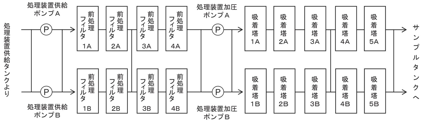
図-3 サブドレン他浄化装置系統構成図
