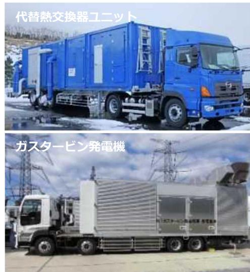
原子炉格納容器の新冷却システム（代替循環冷却系）
