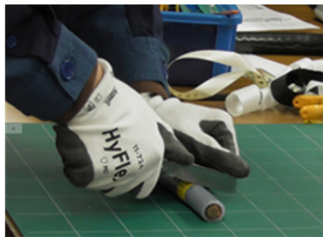
高圧ケーブル接続訓練（左：ケーブル切断・被覆剥ぎ、右：直線接続）
