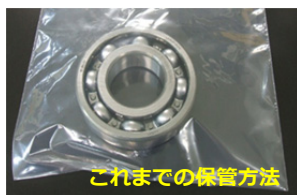
最も有効な手段であった防錆紙と乾燥剤による軸受の保管
