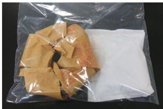
最も有効な手段であった防錆紙と乾燥剤による軸受の保管
