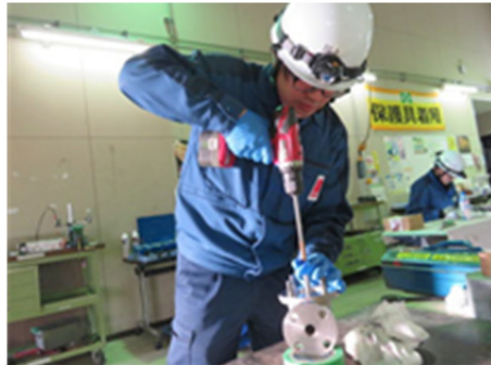
弁分解点検訓練（弁座摺り合わせ）
