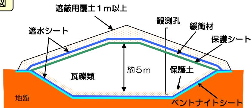
図 覆土式一時保管施設概略図
