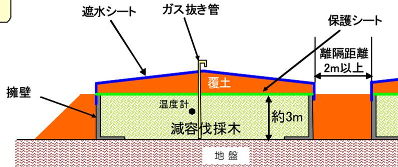
標準断面図 (築堤タイプ) A-A'断面
