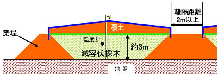
図 伐採木一時保管槽概略図
