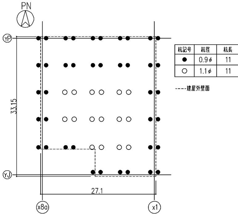
図-17 杭配置図 (G.L. -11.0) (単位 : m)
