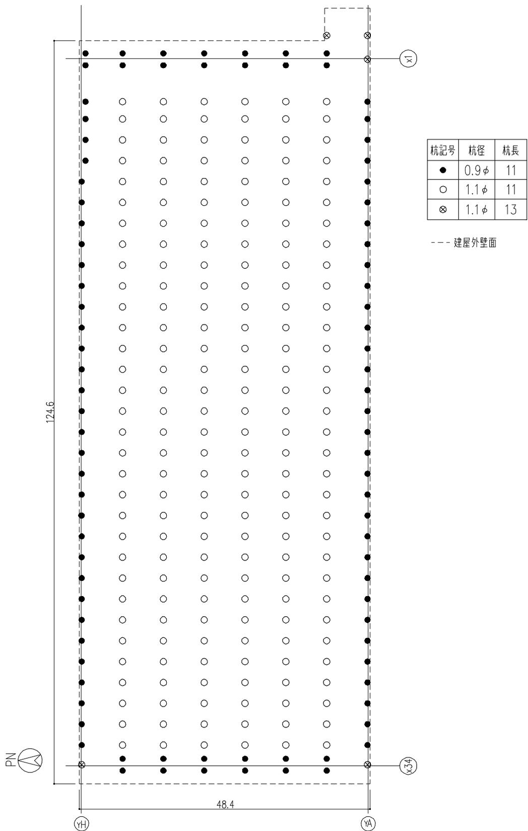
図-1 杭配置図 (G.L. -11.0) (单位 : m)
