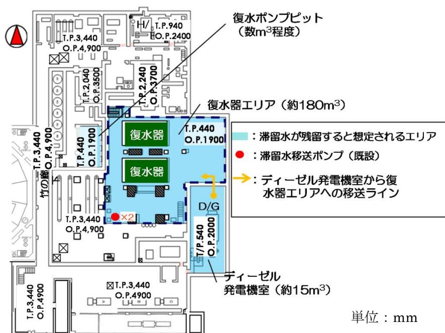
図－1 1号タービン建屋で最低排水レベルまで移送した場合の建屋内滞留水の残水量
