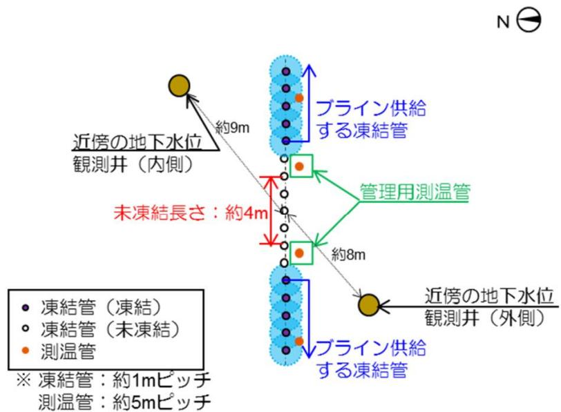
図－11 未凍結箇所の配置（南側）
