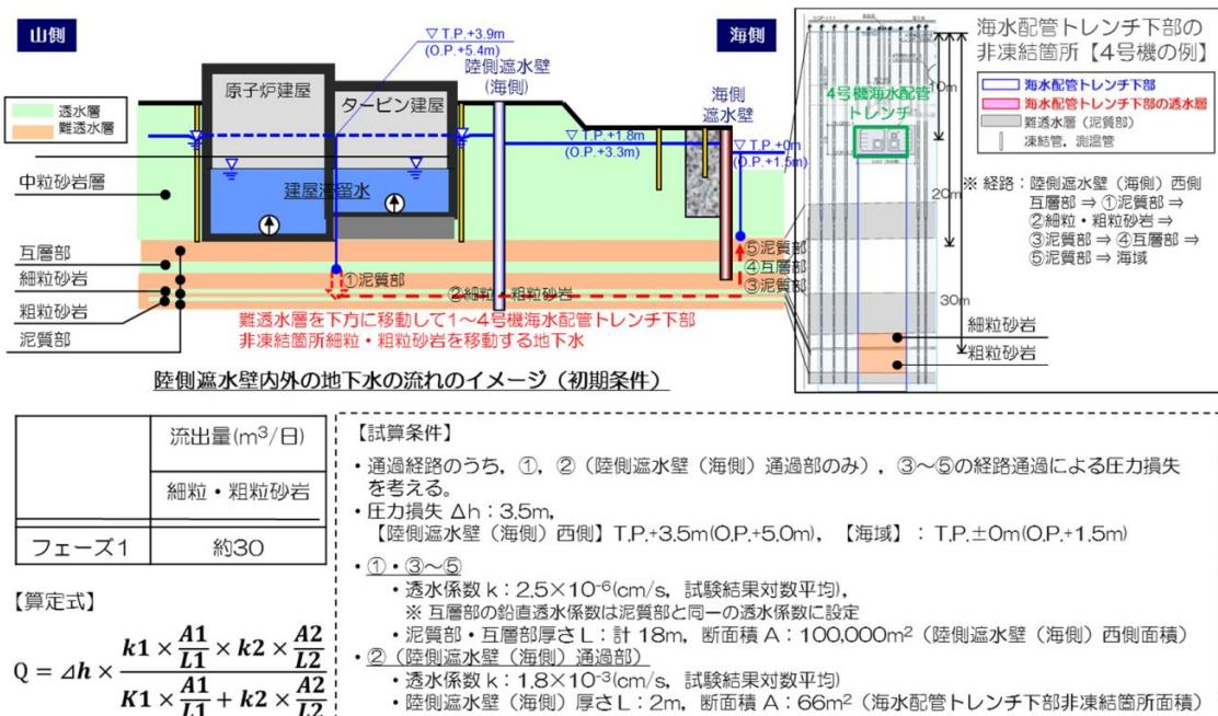
図-5 海水配管トレーンチ下部の非凍結箇所を通じた地下水移動量の想定
