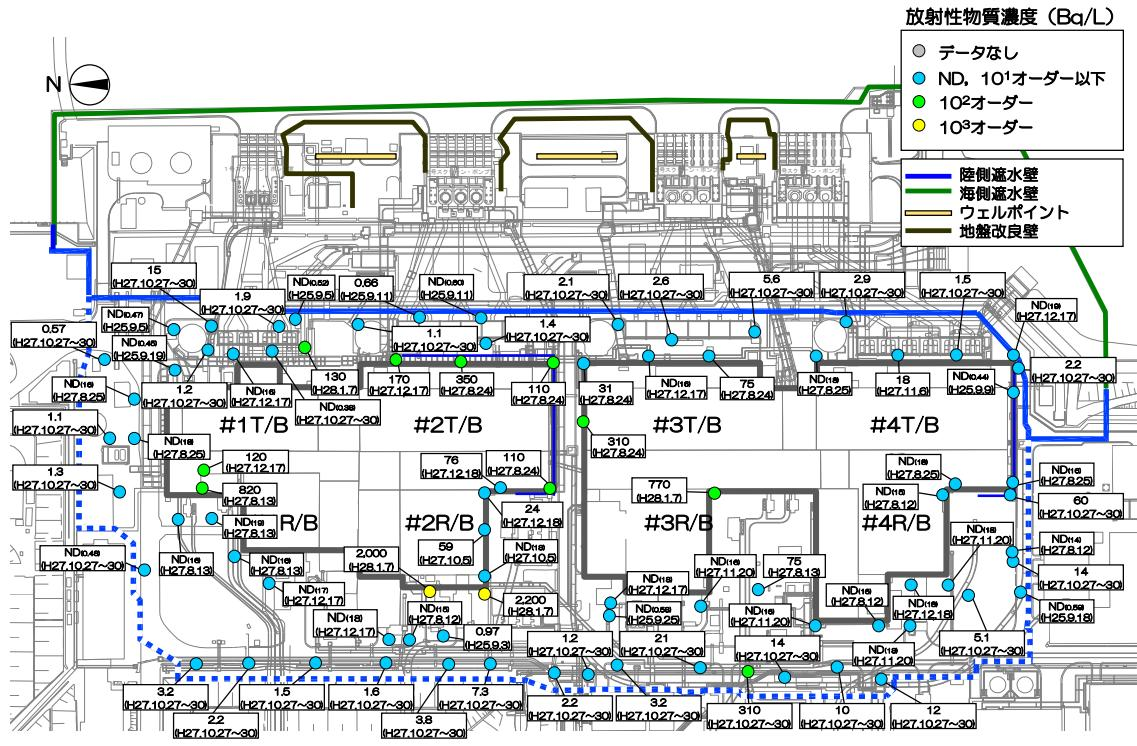
図-2 建屋周辺(海側)の観測井における放射性物質濃度測定結果(2016年1月28日時点)
