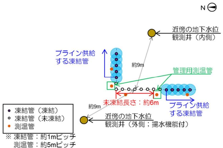
図－6 未凍結箇所の配置（西側①）
