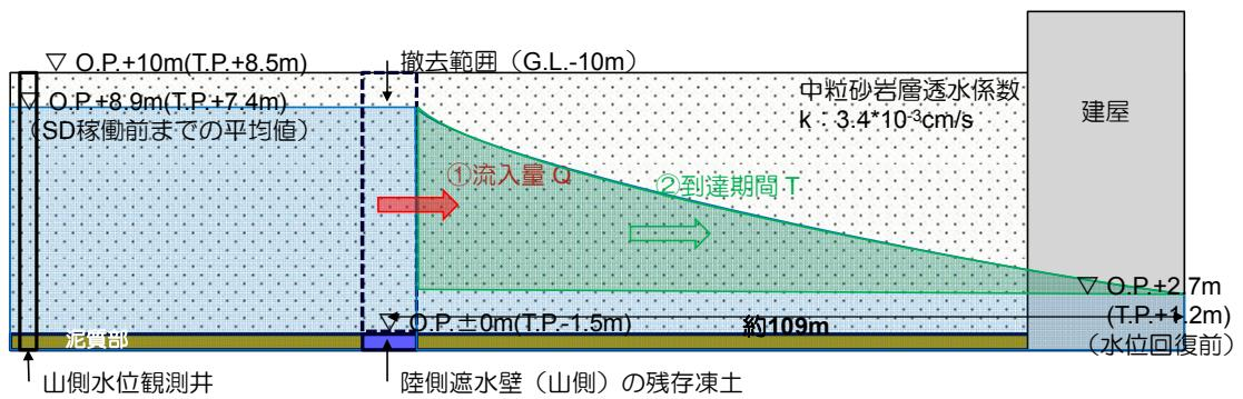
図-1-1　凍土の部分撤去 計算条件
