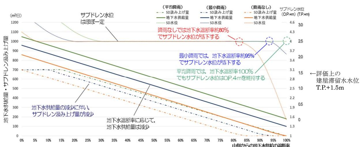
図－2 地下水遮断率※2とサブドレン汲み上げ量及び
