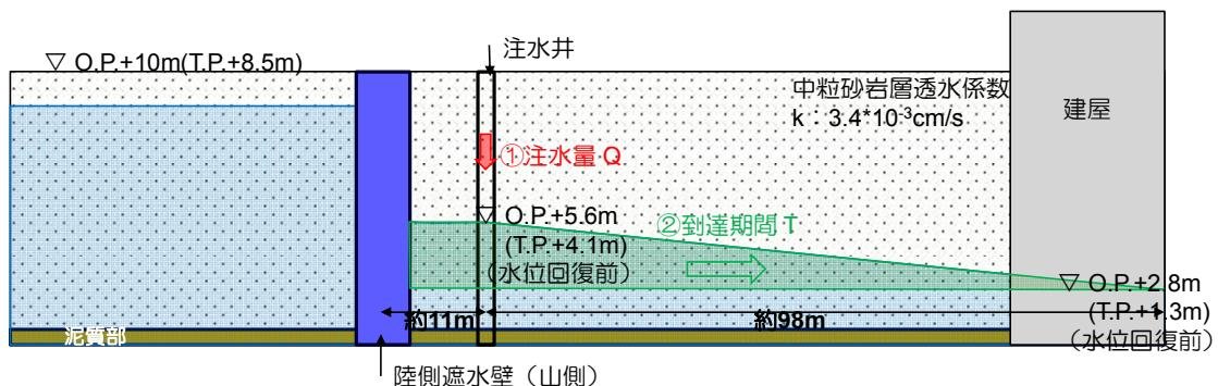
図-6 注水井への注水 計算条件
