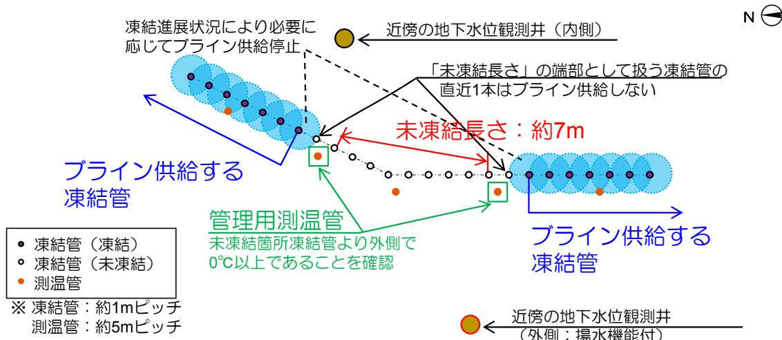
図－17 未凍結長さの管理図（例：西側③）
