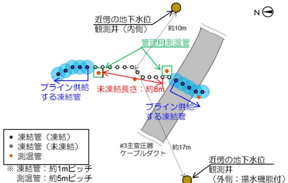
図－9 未凍結箇所の配置 (西側④)
