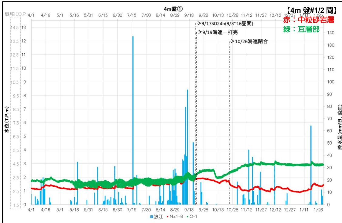
図一 8. 1 1 中粒砂岩層／互層部、細粒・粗粒砂岩の水頭比較（4 m盤①）
