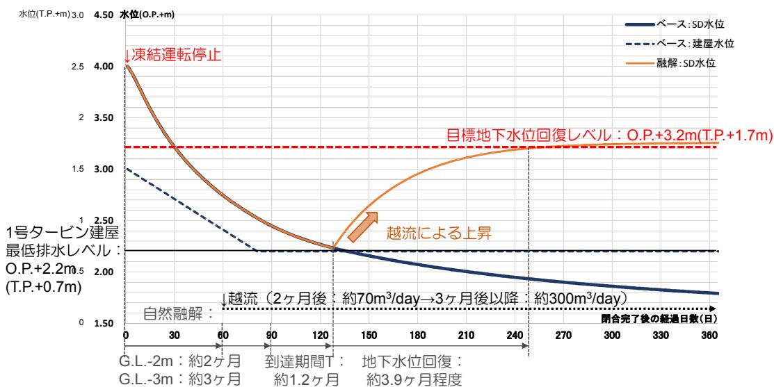
図-10 凍土の自然融解 計算結果
