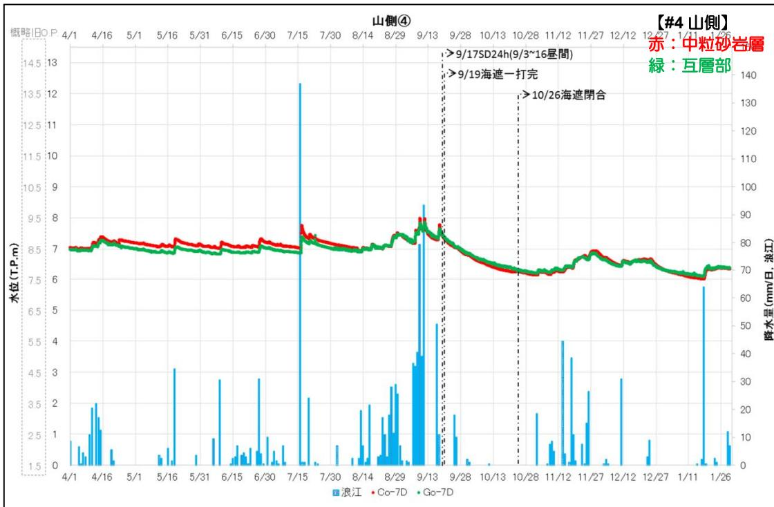
図一8. 5 中粒砂岩層／互層部、細粒・粗粒砂岩の水頭比較（山側④）
