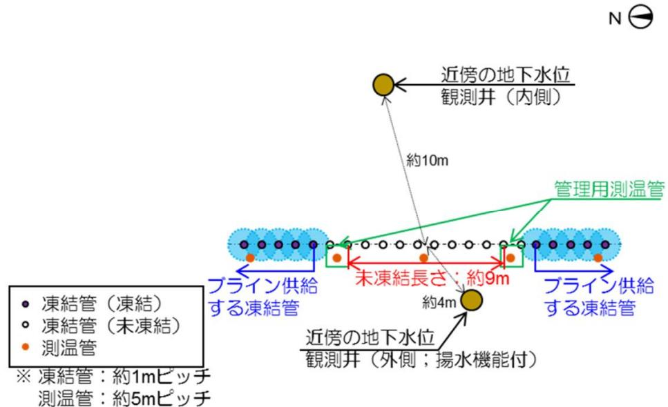
図－7 未凍結箇所の配置（西側②）
