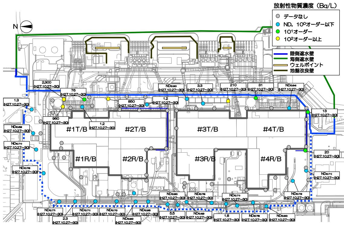
図-4 建屋周辺（海側）の観測井における放射性物質濃度測定結果（2016年1月28日時点）
