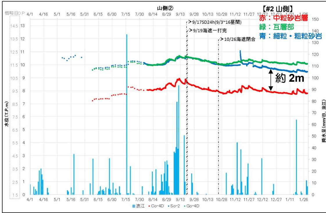
図一8. 3 中粒砂岩層／互層部，細粒・粗粒砂岩の水頭比較（山側②）
