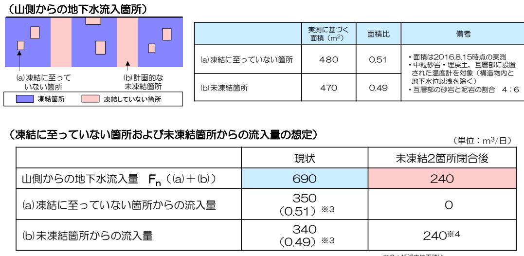
図-4 一部閉合（I）後の残りの未凍結箇所からの地下水流入量の想定（ケース1）
