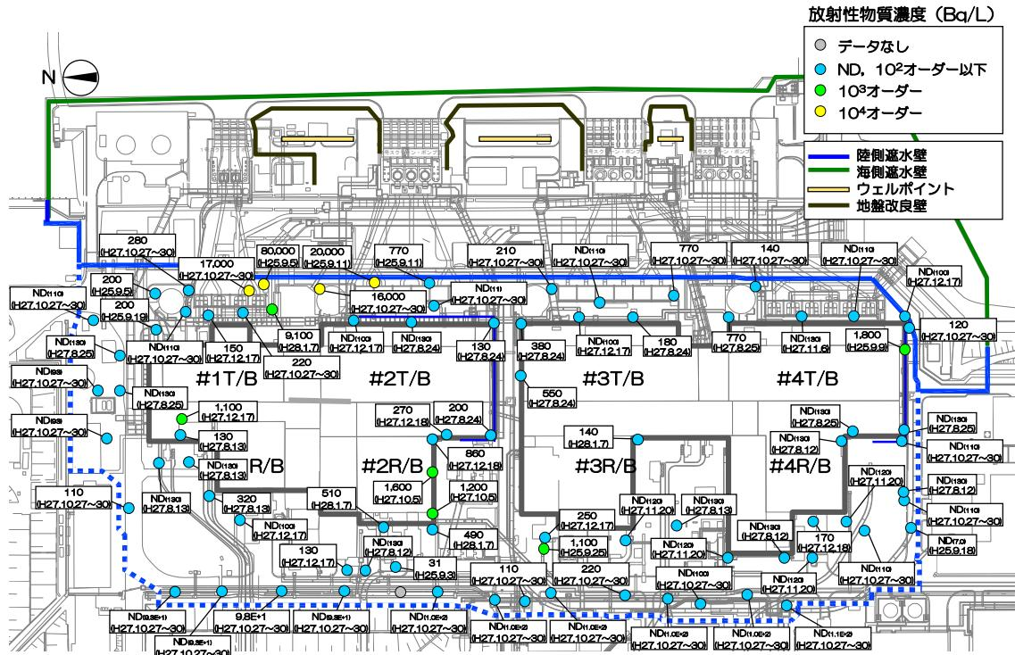
図-3 建屋周辺（海側）の観測井における放射性物質濃度測定結果（2016年1月28日時点）
