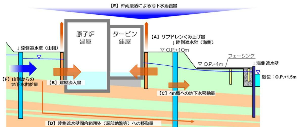
図－2 地下水収支・地下水位変動量の時間的変動の算定に関する各種項目
