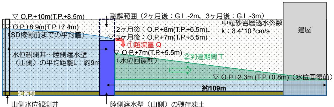
図-8 凍土の自然融解 計算条件
