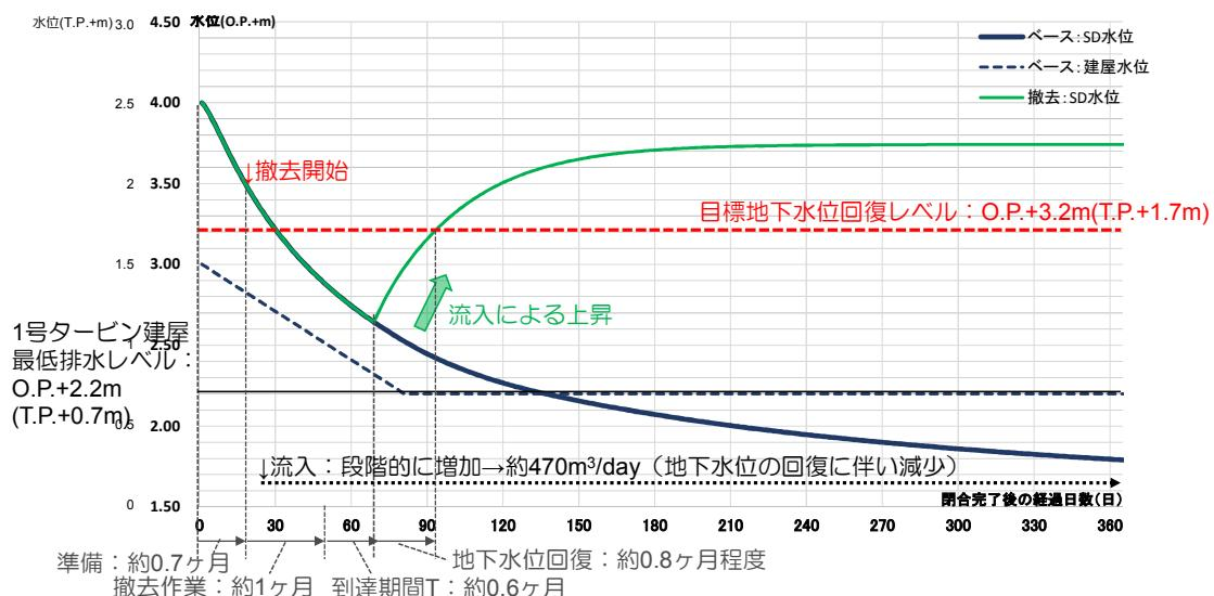
図-13 凍土の部分撤去 計算結果
