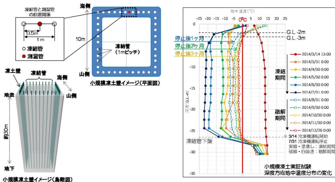
図-1-4 小規模凍土実証試験結果
