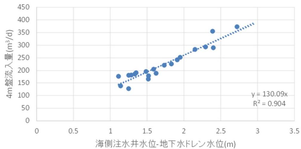
図-5 海側注水井水位-地下水ドレン水位と4m盤流入量の関係
