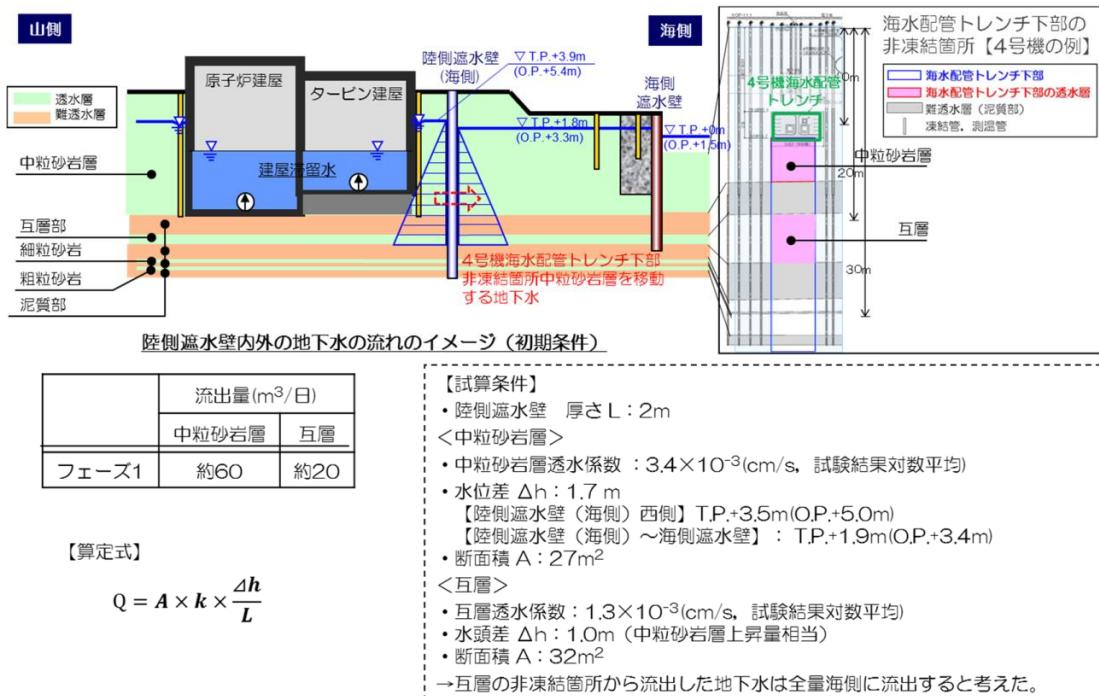
図-4 海水配管トレーンチ下部の非凍結箇所を通じた地下水移動量の想定
