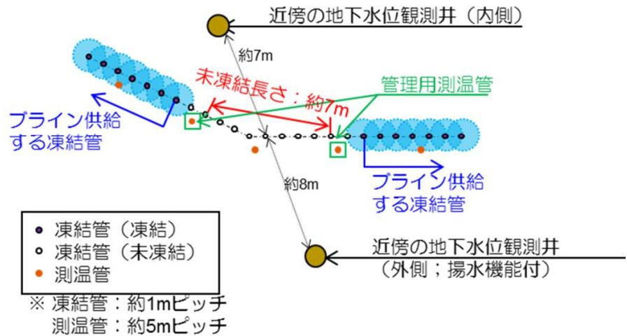
図－8 未凍結箇所の配置 (西側③)
