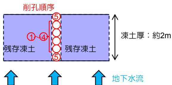
図-5 ボーリング削孔手順例
