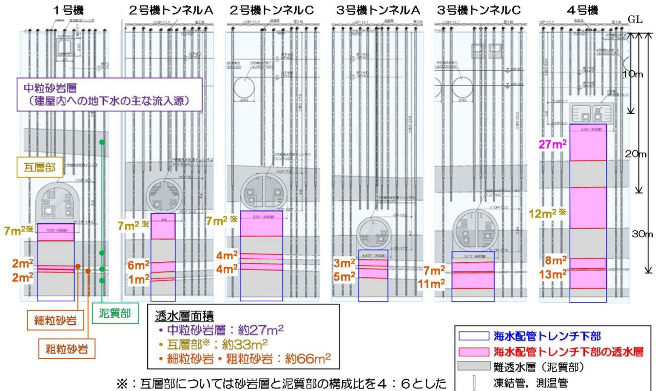
図一2 海水配管トレーンチ下部の非凍結範囲（詳細）
