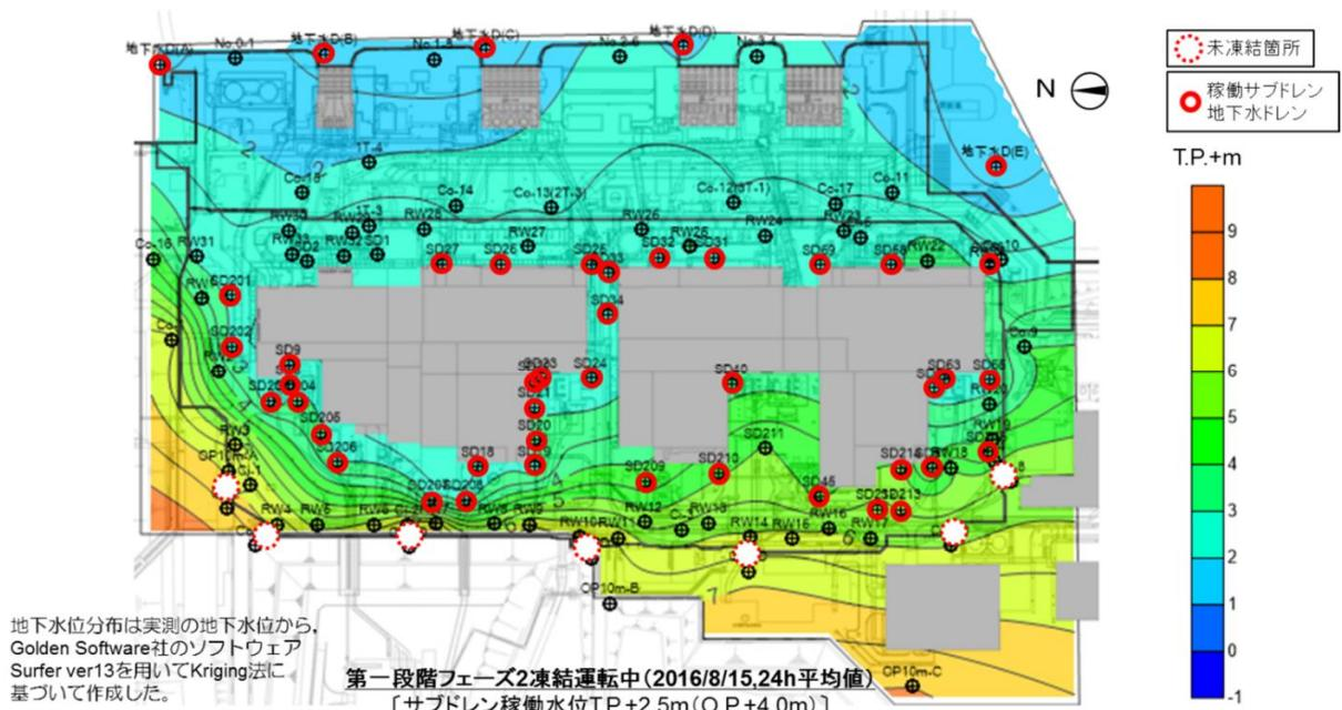
図－15 地下水位の状況（2016年8月15日時点）
