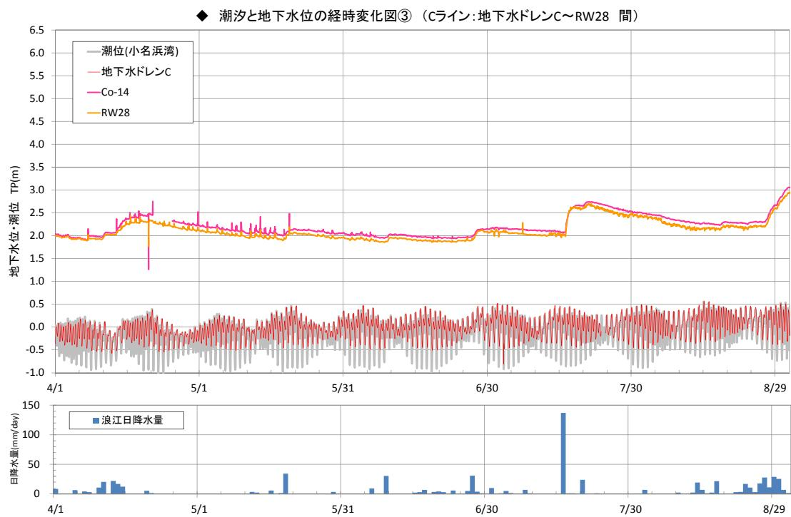
図-8 地下水ドレンCライン上の地下水位の経時変化
