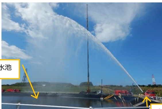
大容量放水設備の放水性能確認試験
