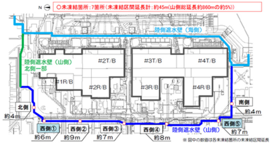
第一段階フェーズ2における凍結箇所
