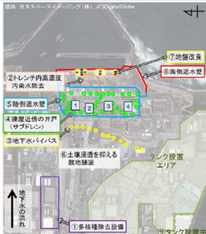
汚染水対策の主な作業項目
