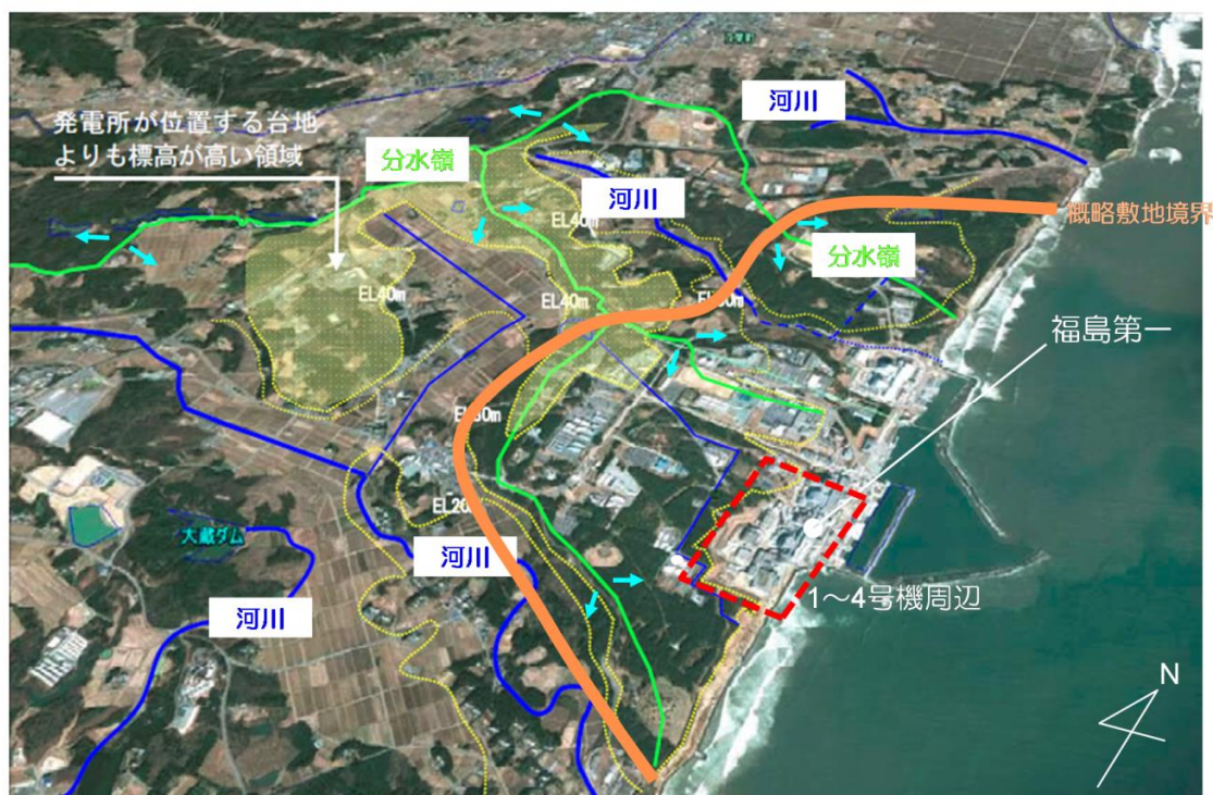
図-1 発電所周辺の地形
