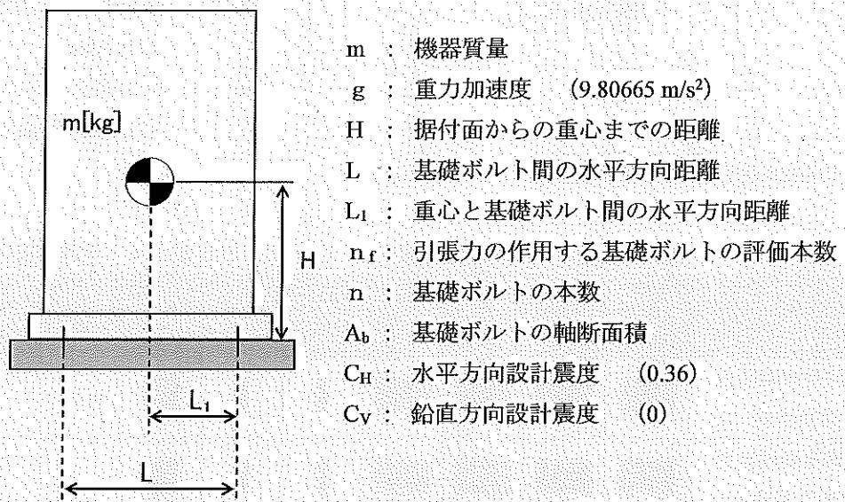
$$\text{基礎ボルトに作用する引張力: } F_b = \frac{1}{L} (m \times g \times C_H \times H - m \times g \times (1 - C_V) \times L_1)$$
