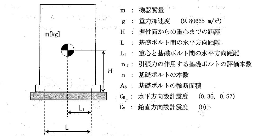
$$\text{基礎ボルトに作用する引張力: } F_b = \frac{1}{L} (m \times g \times C_h \times H - m \times g \times (1 - C_v) \times L_1)$$
