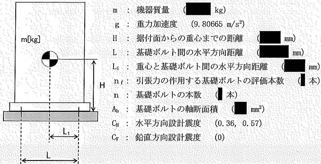
$$\text{基礎ボルトに作用する引張力} : F_b = \frac{1}{L} (m \times g \times C_H \times H - m \times g \times (1 - C_V) \times L_1)$$
