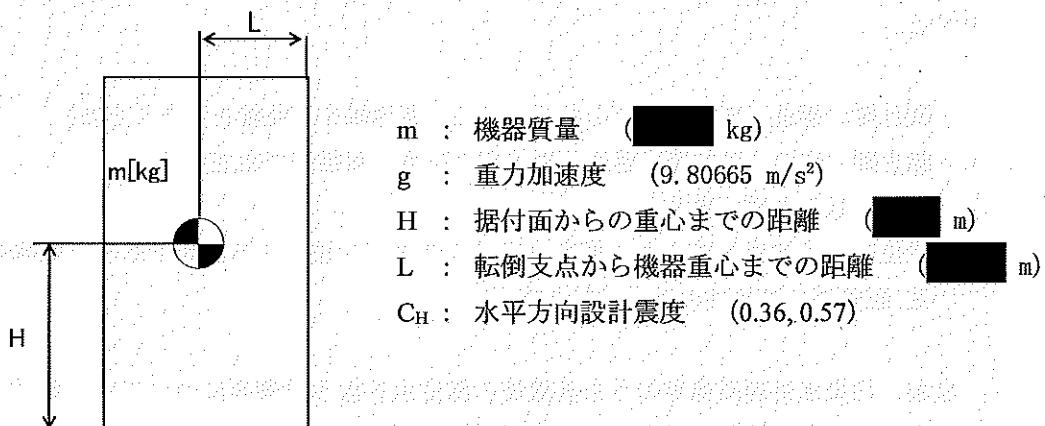
$$\text{地震による転倒モーメント} : M_1 [N \cdot m] = m \times g \times C_H \times H$$
