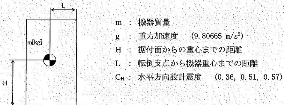
地震による転倒モーメント :  $M_1 [N \cdot m] = m \times g \times C_H \times H$
