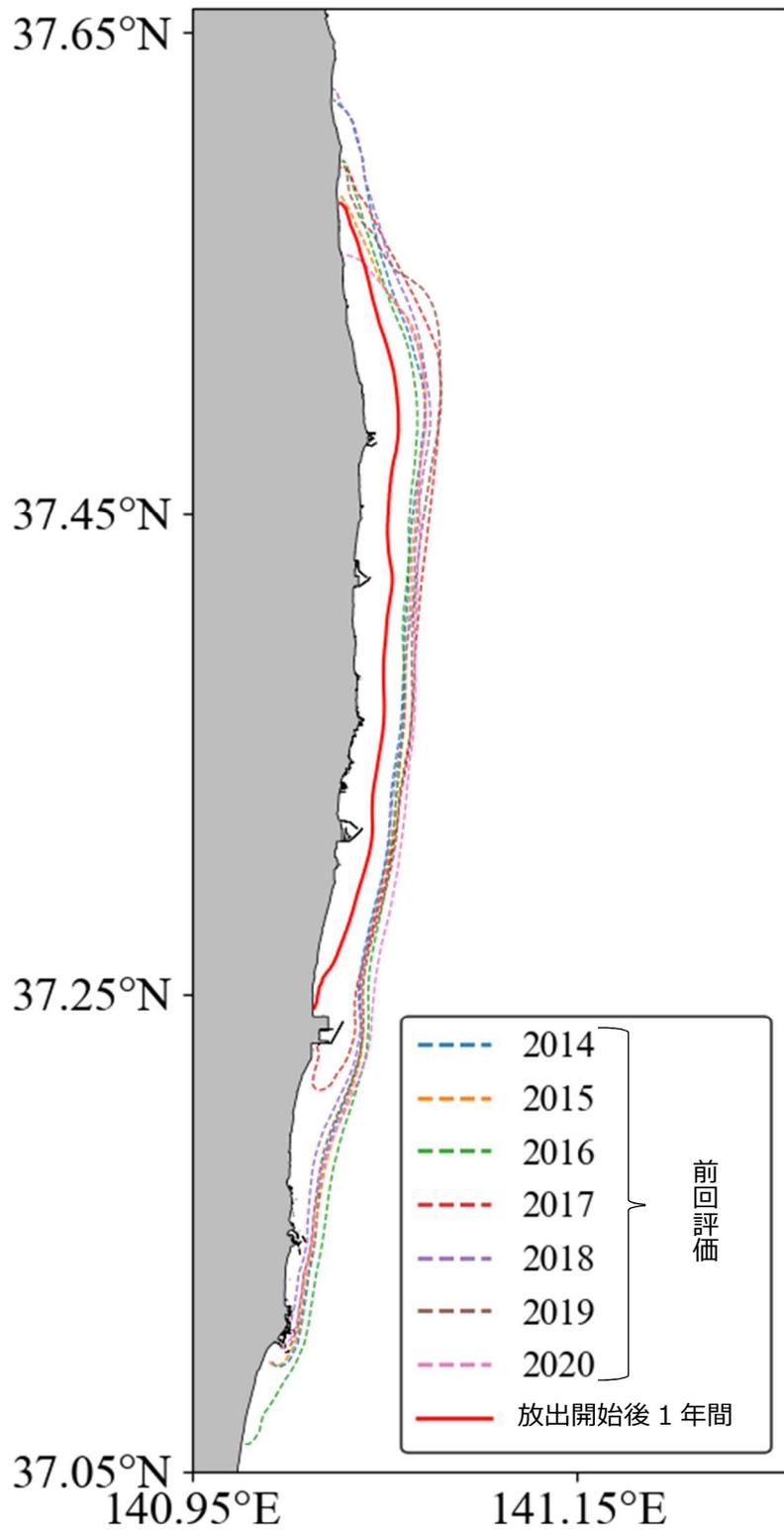
図 5-3-3 海洋拡散シミュレーションによる、年間平均濃度 0.1Bq/L を超える上昇範囲の
