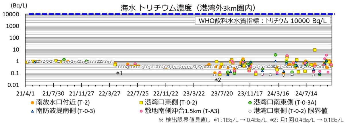
図Ⅲ-1-1 港湾外 3km 圏内の海水中トリチウム濃度
