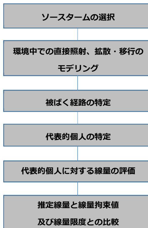
図 5-1-1 被ばく評価の手順（GSG-10 より作成）
