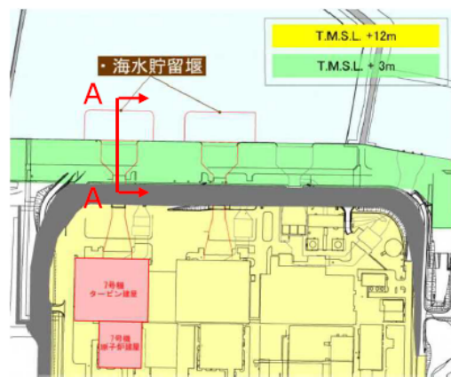
図1 海水貯留堰配置図
