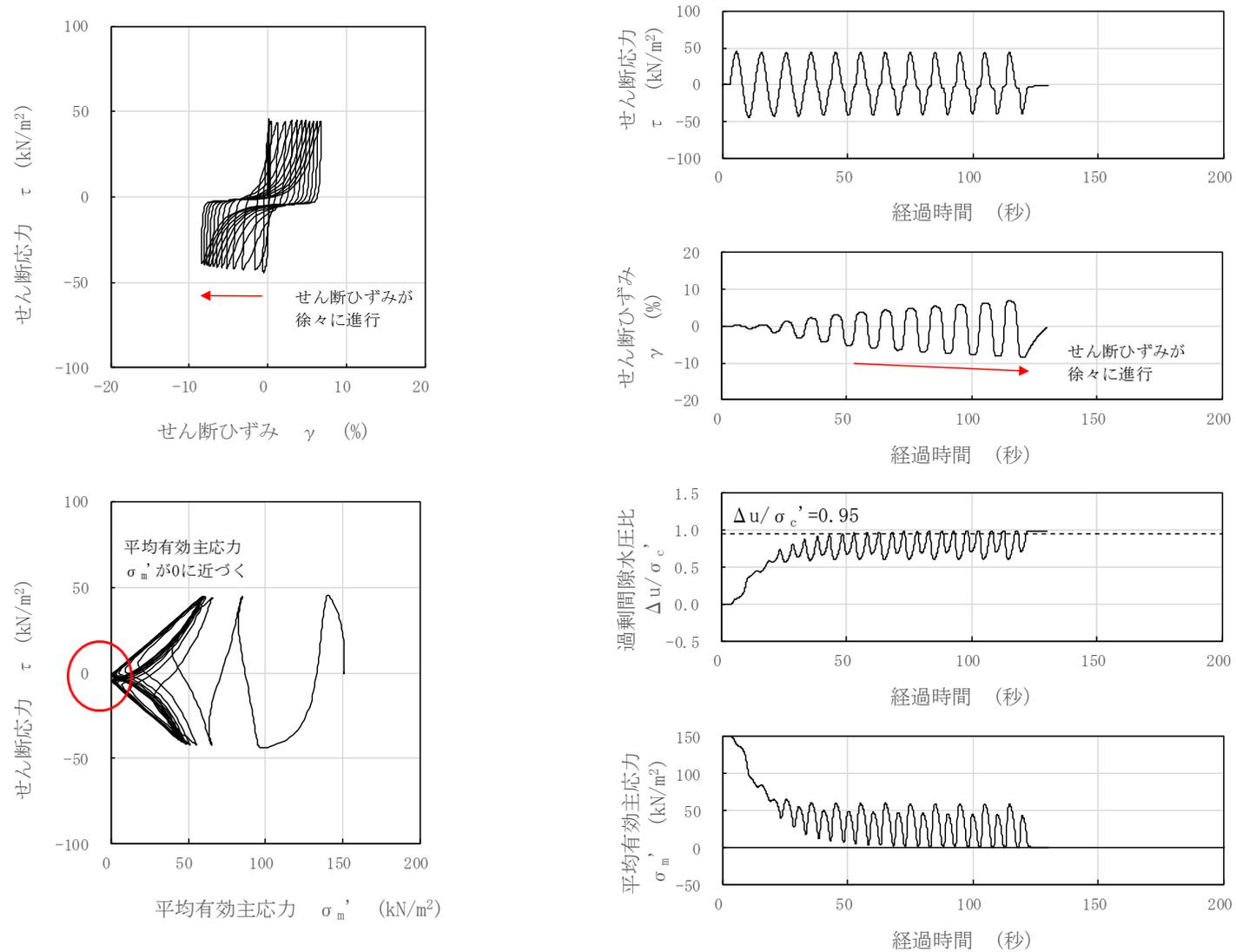
図 3-74 液状化試験結果（沖積層上部（砂質），S0-S1-8-5，GL. -14.54~14.66m，有効拘束圧 150kN/m<sup>2</sup>，せん断応力比=0.293）
