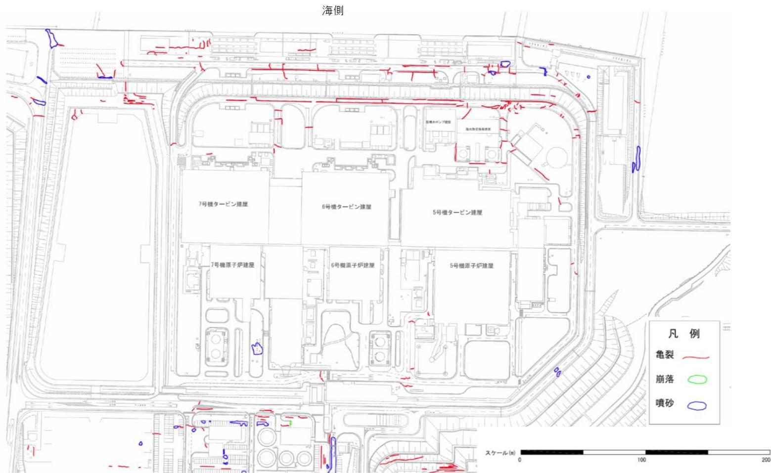
図2-2 新潟県中越沖地震における敷地内の亀裂・噴砂位置
