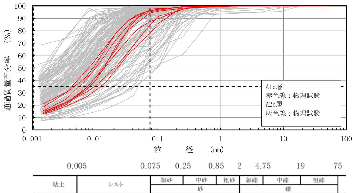
図 3-24 A1c 層と A2c 層の粒径加積曲線
