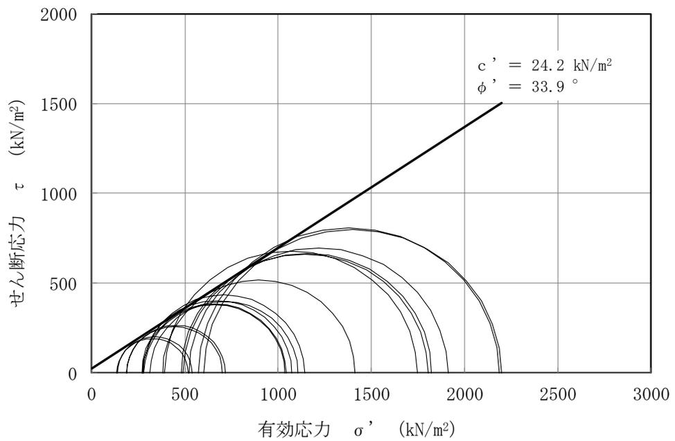
図 3-18 沖積層下部の三軸圧縮試験結果及び強度定数
