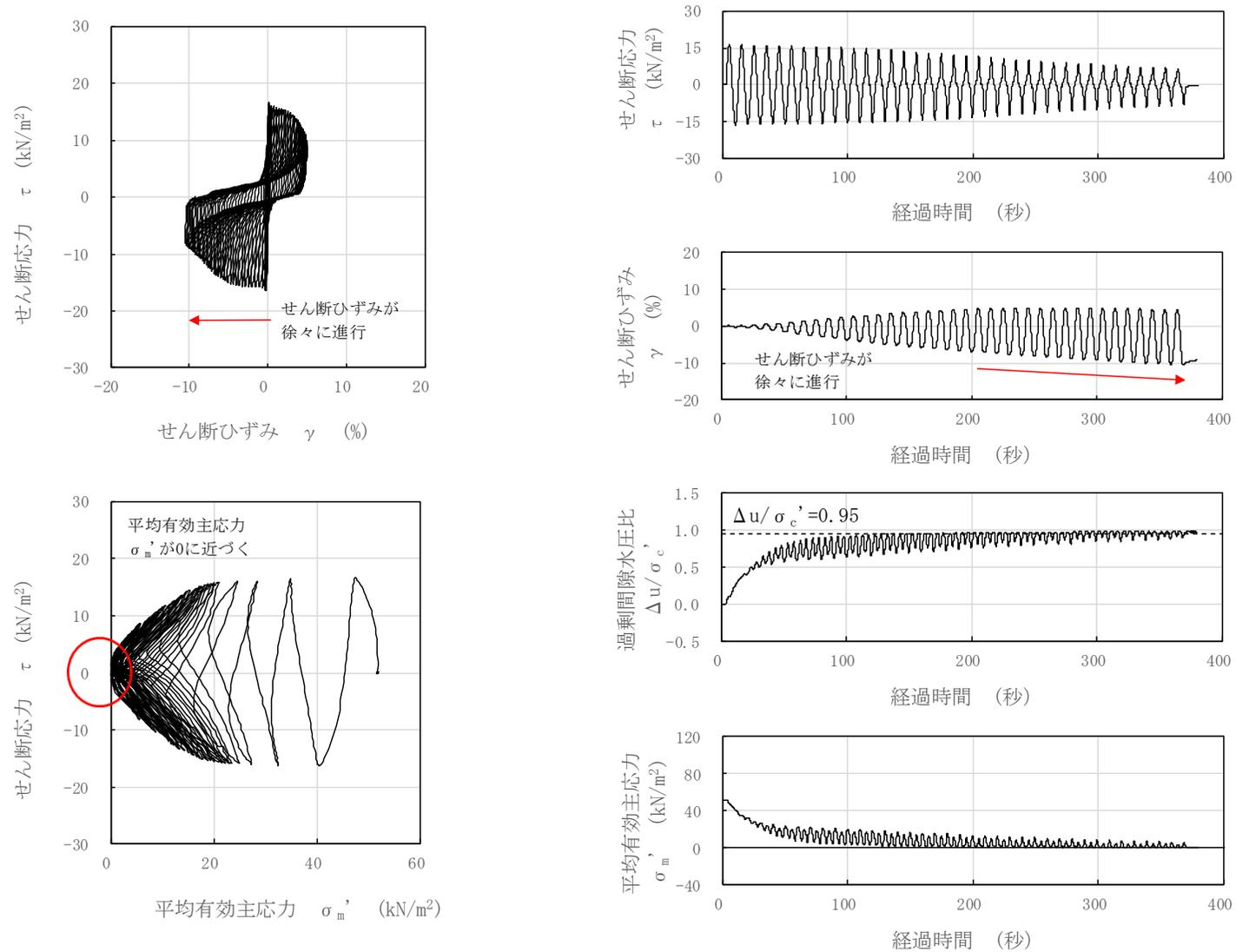
図 3-64 液状化試験結果 (新期砂層, S0-S1-1-4, GL. -6.97~7.09m, 有効拘束圧 50kN/m<sup>2</sup>, せん断応力比=0.315)
