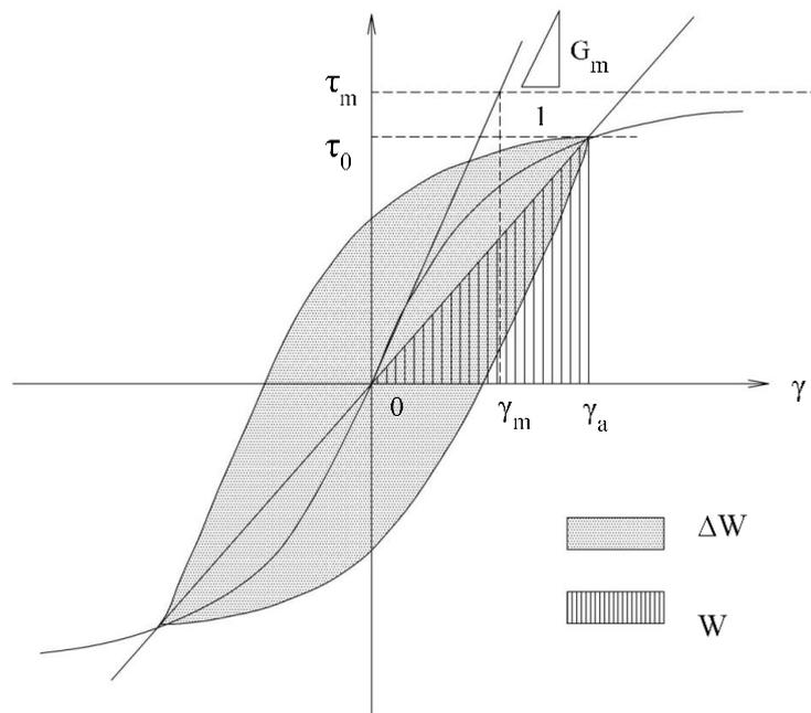
図 4-44 排水条件での土の応力-ひずみ関係の概念図 (港湾技研資料 No869) \*
