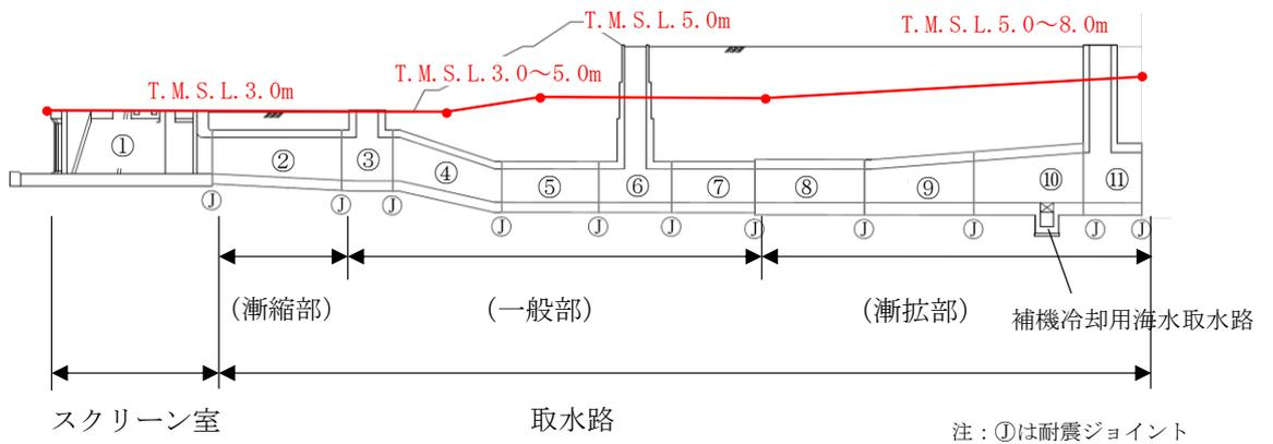
図 3-14 取水路の地下水位設定の概要図
