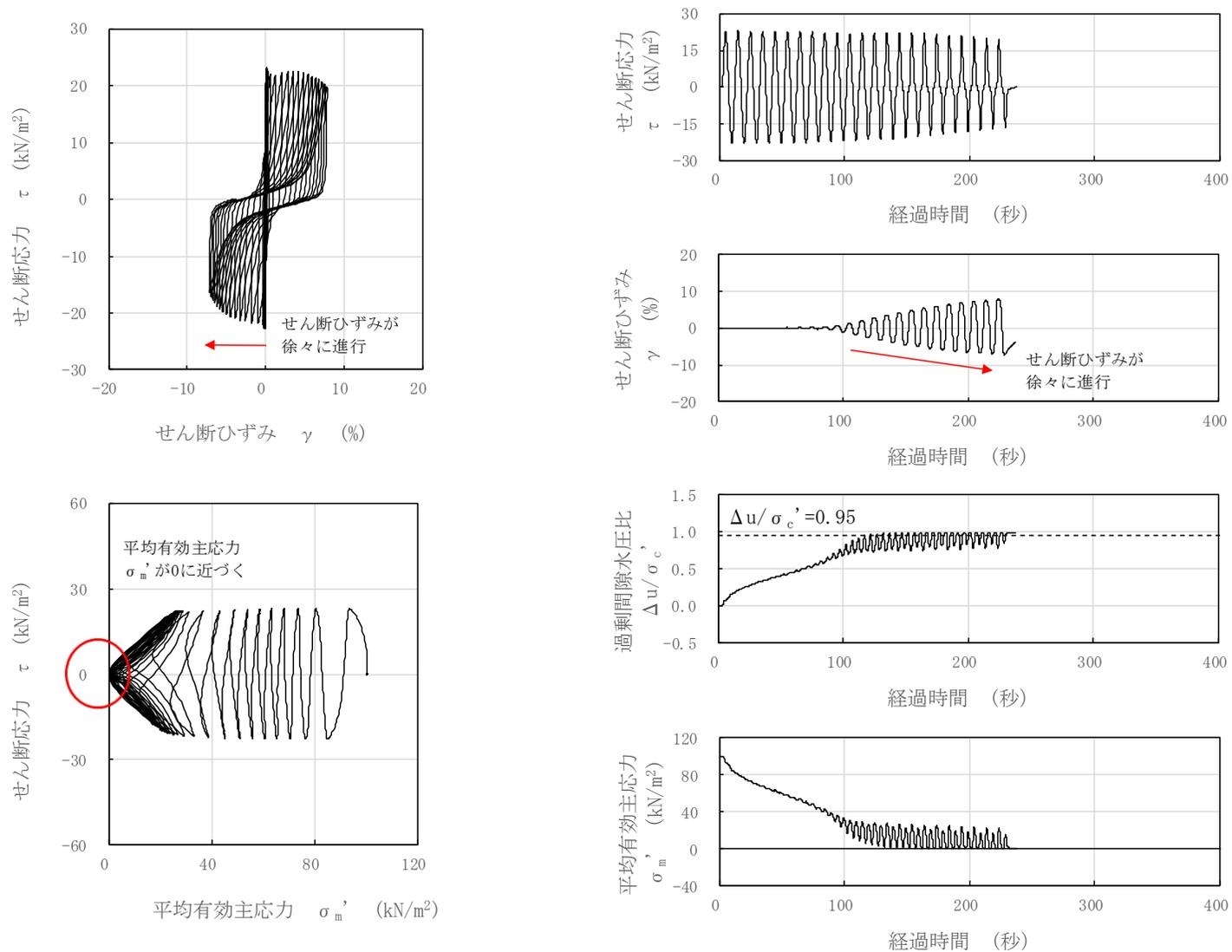
図 2-2 液状化試験結果 (新期砂層, S0-S1-2-6, GL. -8.16~8.28m, 有効拘束圧 100kN/m<sup>2</sup>, せん断応力比=0.227)
