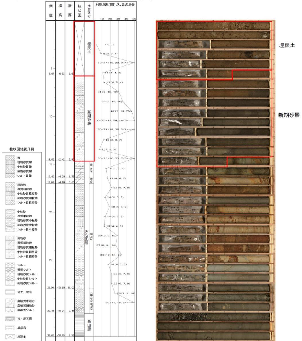
注：図中の赤枠は液化化強度試験の対象地層を示す。
