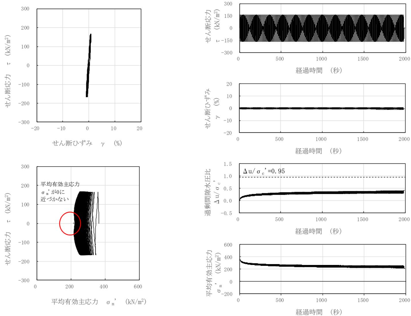
図 3-104 液状化試験結果 (A2s 層, FS-3-1-3, GL. -27.03~27.18m, 有効拘束圧 363kN/m<sup>2</sup>, せん断応力比=0.458)
