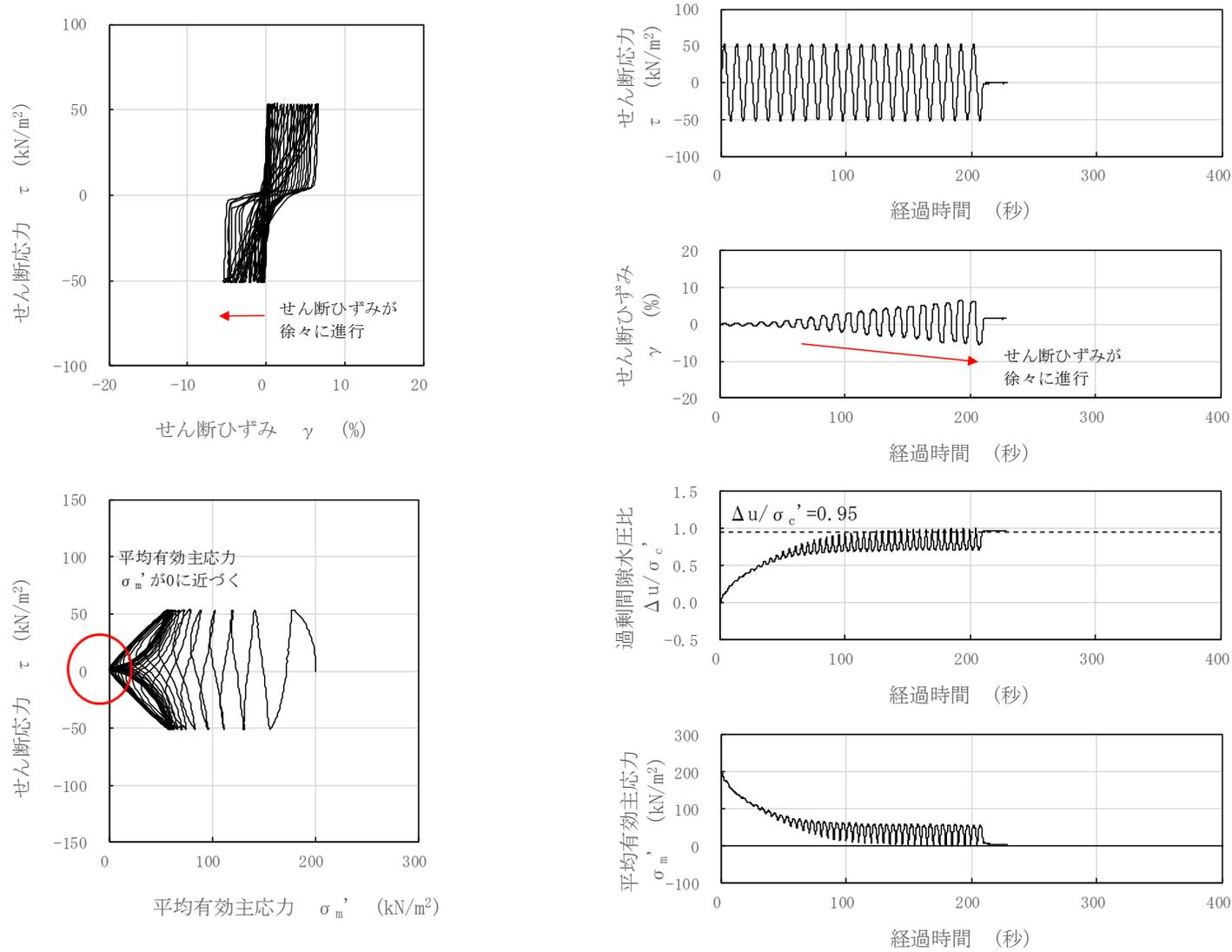
図 3-58 液状化試験結果 (新期砂層, GTG-S4-④, GL. -14.22~14.87m, 有効拘束圧 200kN/m<sup>2</sup>, せん断応力比=0.261)
