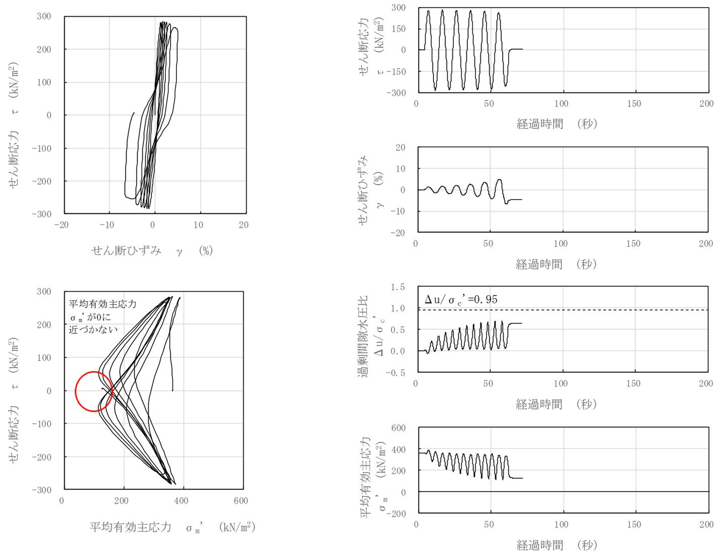
図 3-97 液状化試験結果 (A2s 層, FS-3-2-2, GL. -27.84~28.00m, 有効拘束圧 363kN/m<sup>2</sup>, せん断応力比=0.779)
