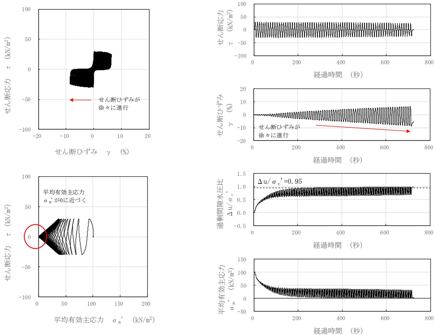
図 3-69 液状化試験結果 (沖積層上部 (砂質), S0-S1-7-1, GL. -13.11~13.23m, 有効拘束圧 100kN/m<sup>2</sup>, せん断応力比=0.295)
