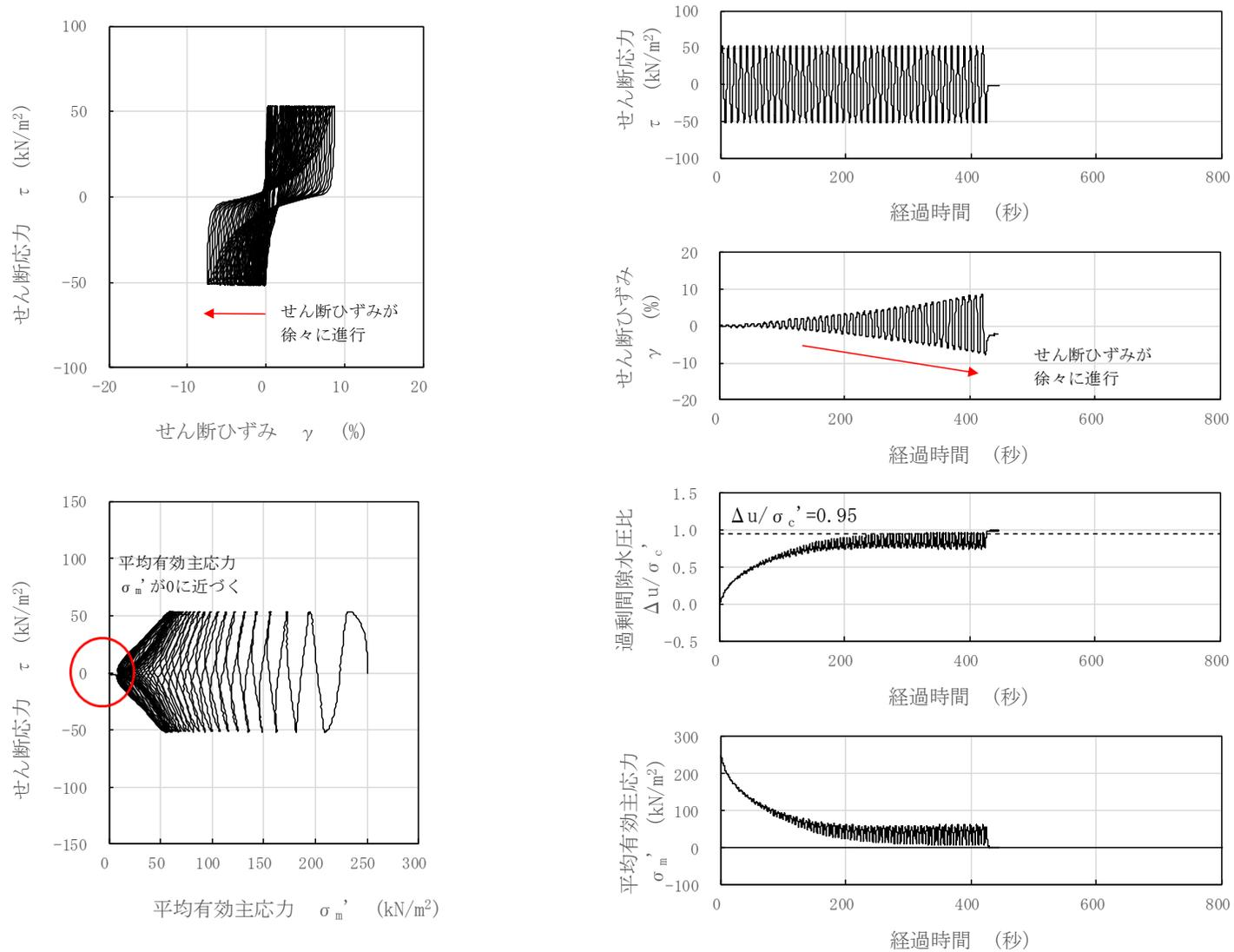
図 3-77 液状化試験結果 (沖積層下部, GTG-S6-⑤, GL. -11.70~14.70m, 有効拘束圧 250kN/m<sup>2</sup>, せん断応力比=0.211)
