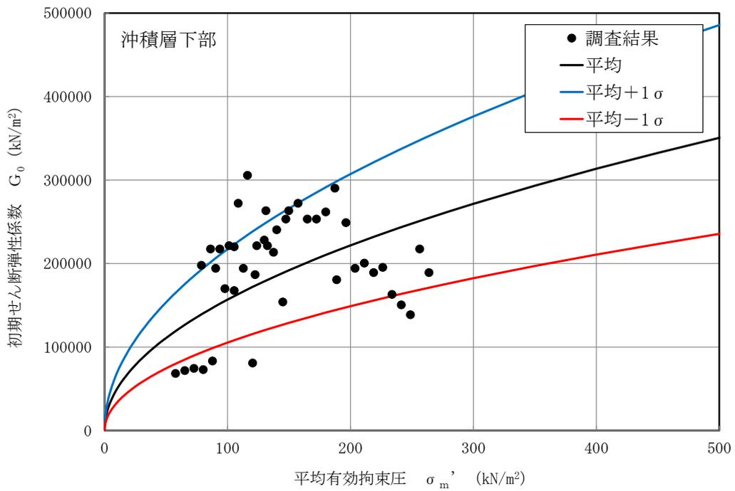
図 2-6  $G_0$  の  $\sigma_m'$  依存式 (沖積層下部)
