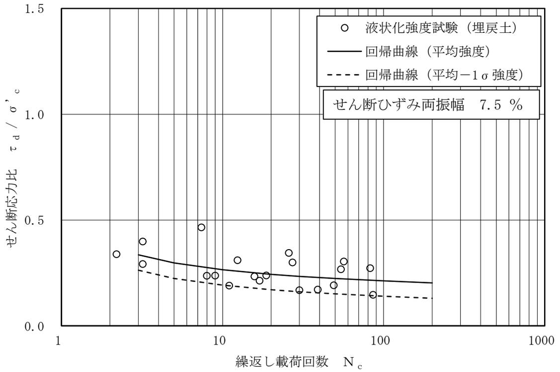
図 3-24 埋戻土の液状化強度試験結果
