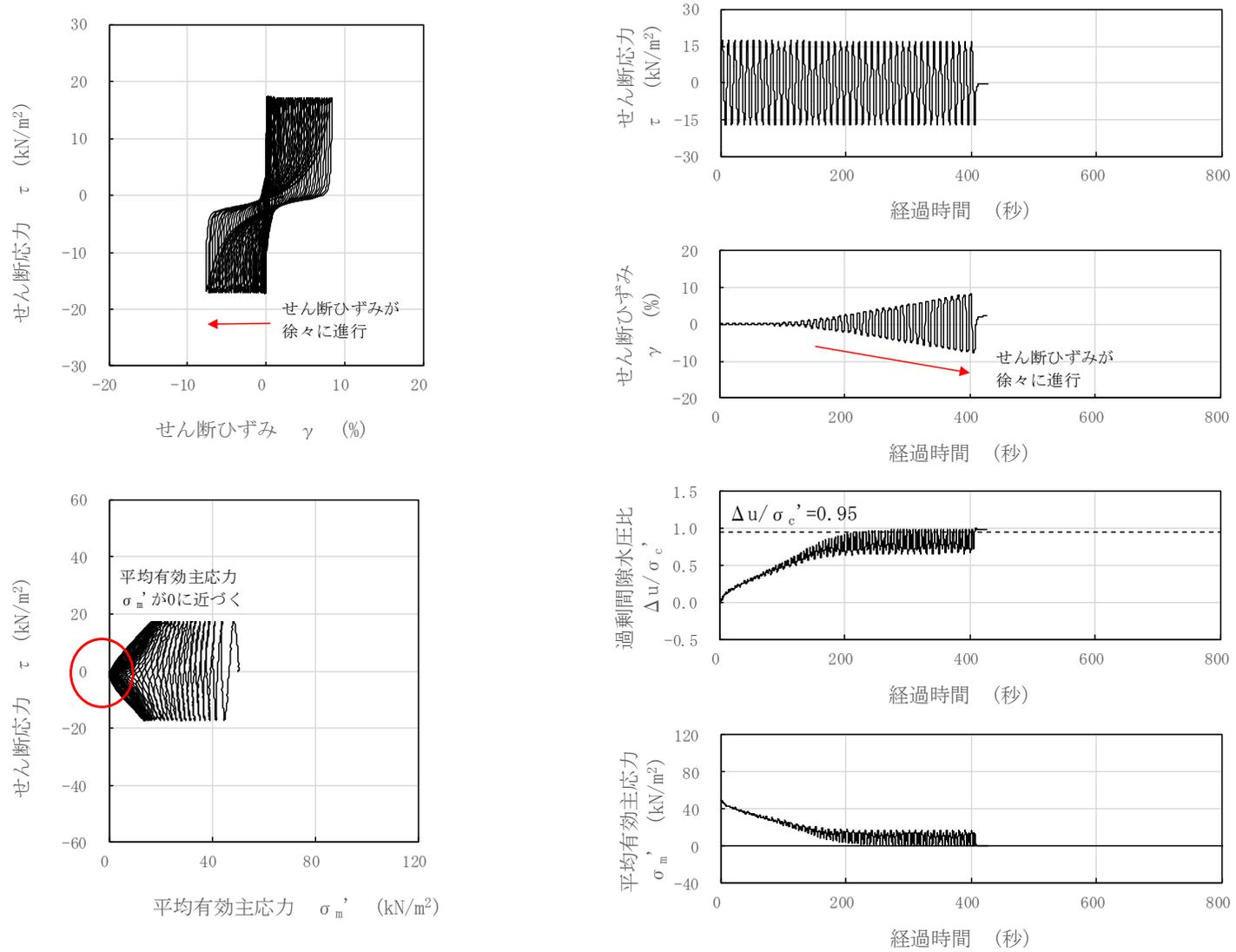
図 3-42 液状化試験結果 (埋戻土, GTG-S3-③, GL. -5.05~5.57m, 有効拘束圧 50kN/m<sup>2</sup>, せん断応力比=0.344)
