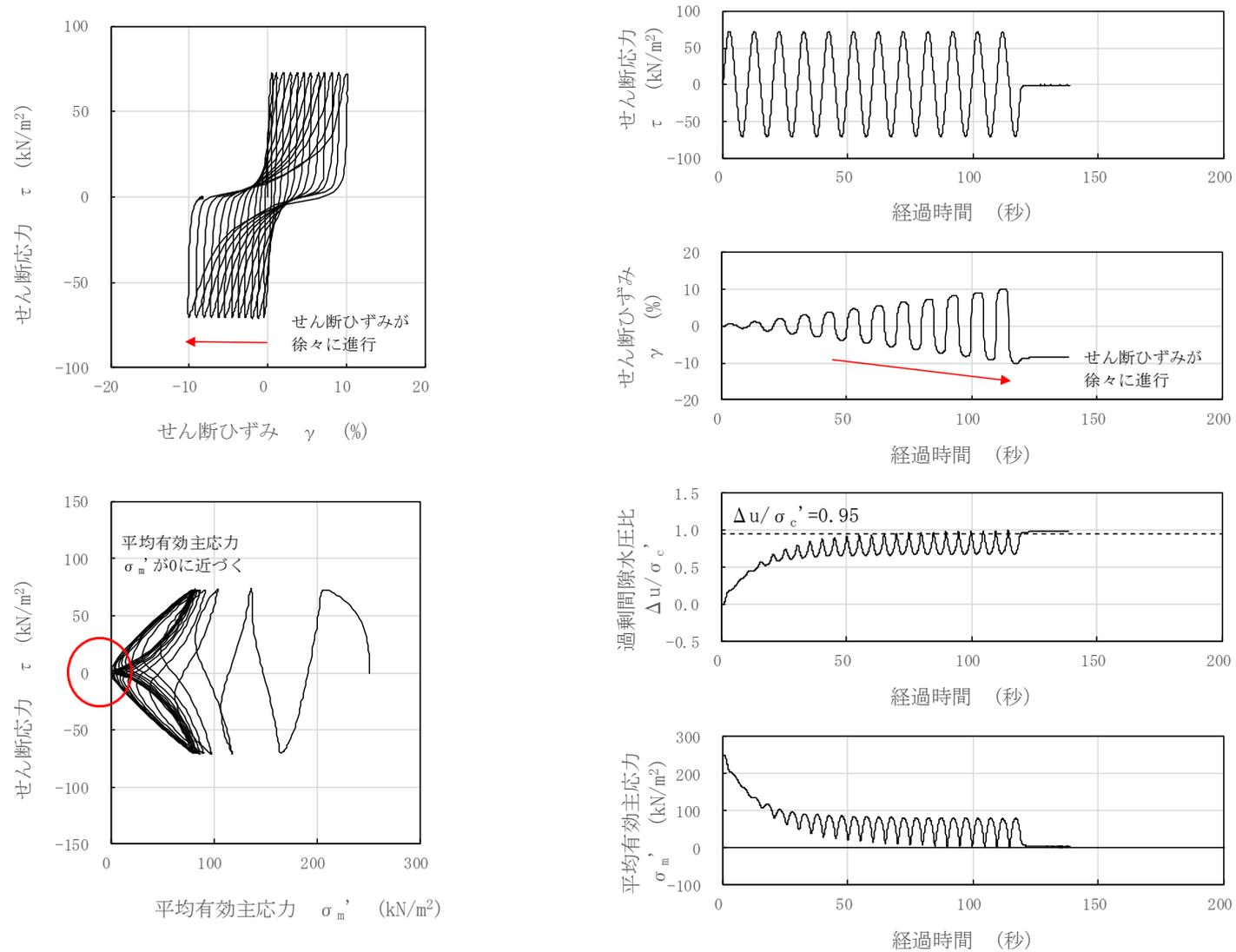
図 3-76 液状化試験結果 (沖積層下部, GTG-S6-②, GL. -11.70~14.70m, 有効拘束圧 250kN/m<sup>2</sup>, せん断応力比=0.286)
