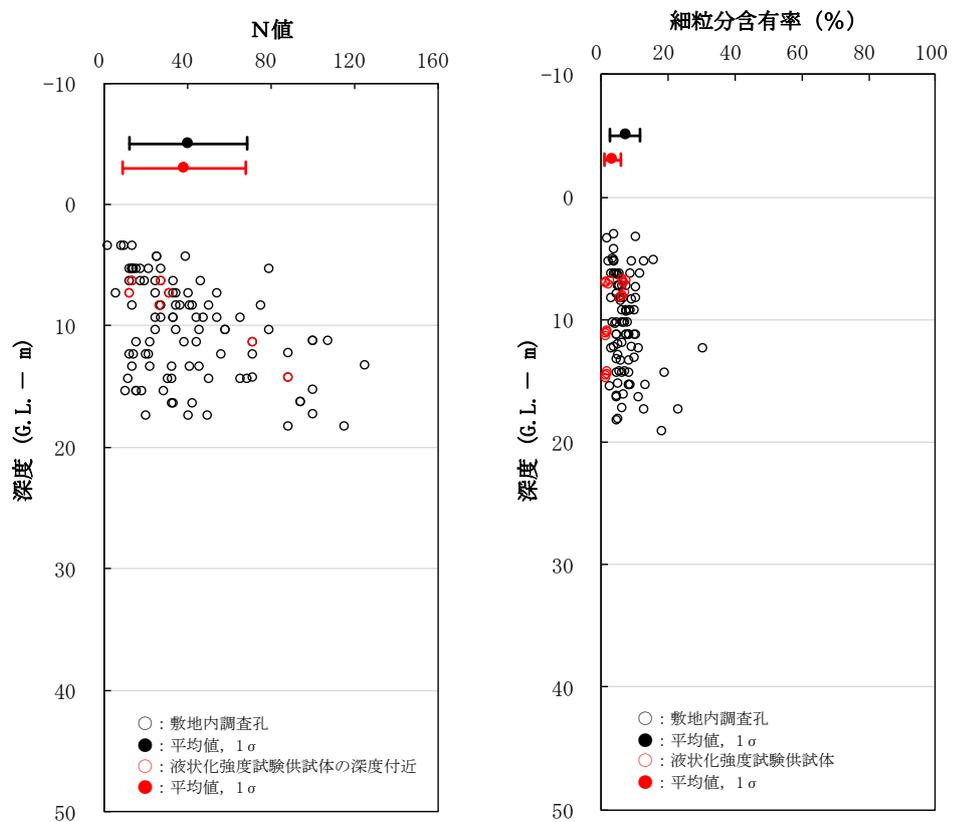
図 4-25 液状化強度試験箇所及び敷地内調査孔のN値，細粒分含有率  $F_c$  の比較
