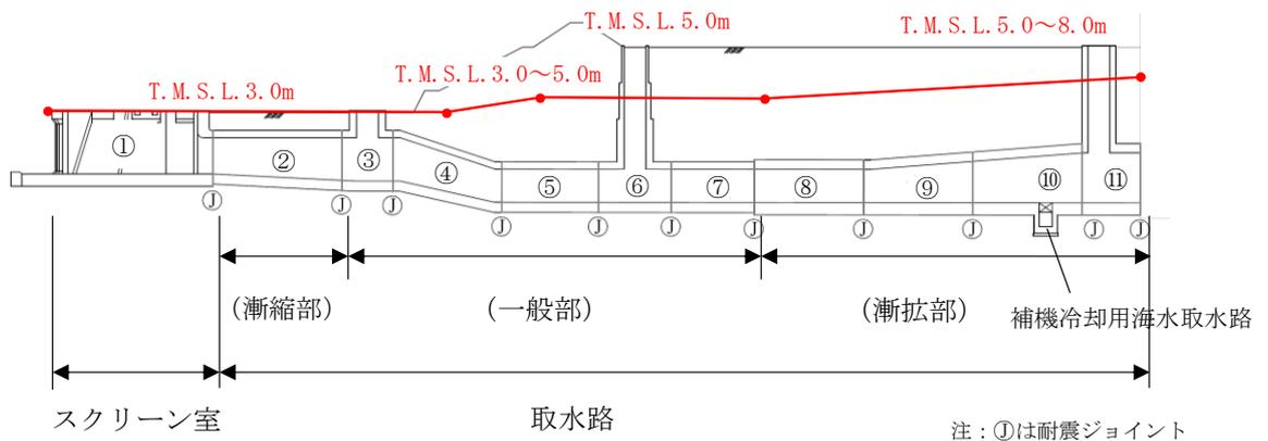
図 3-9 取水路の地下水位設定の概要図
