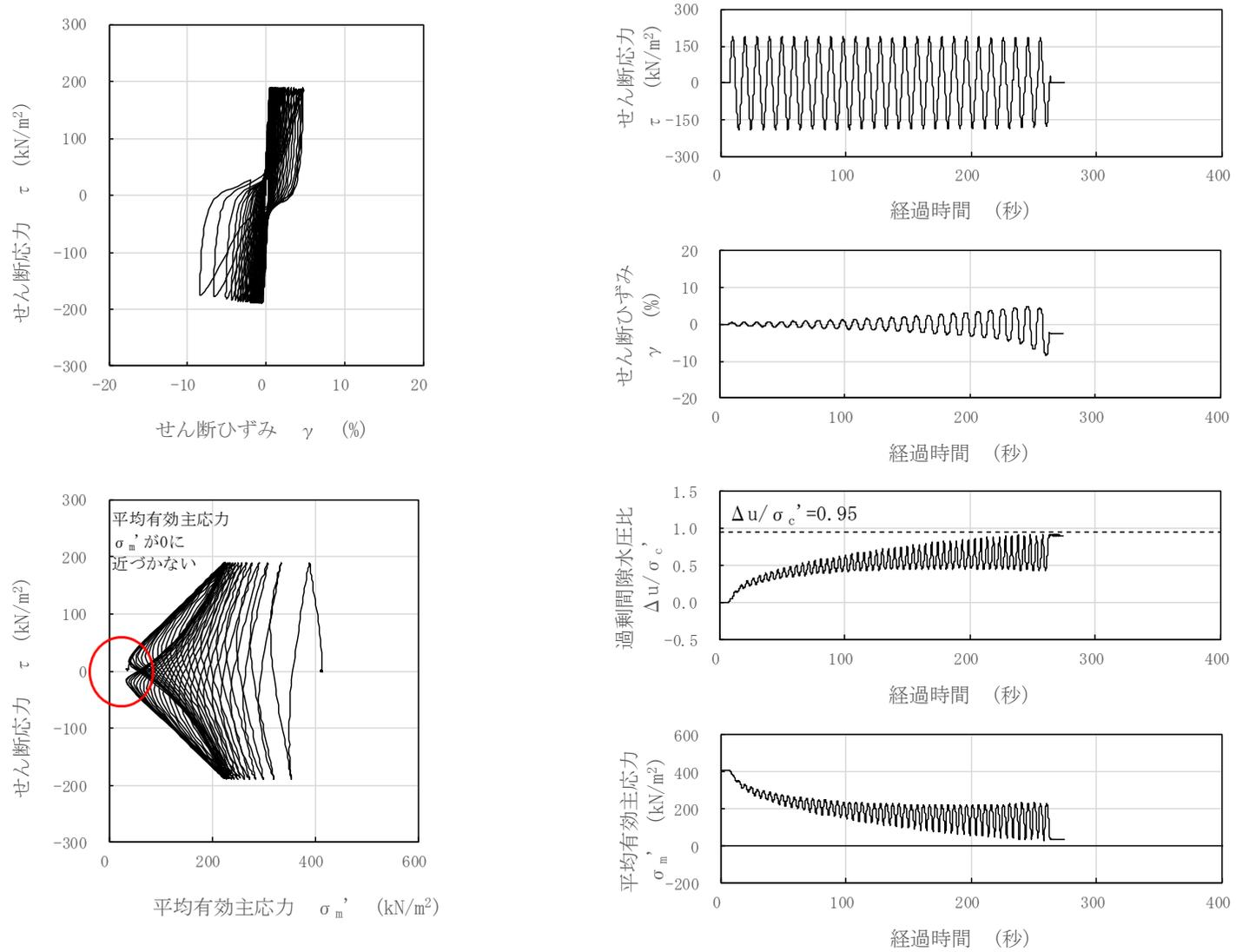
図 3-128 液状化試験結果 (A2s 層, FS02-2-21, GL. -25.55~25.70m, 有効拘束圧 412kN/m<sup>2</sup>, せん断応力比=0.460)
