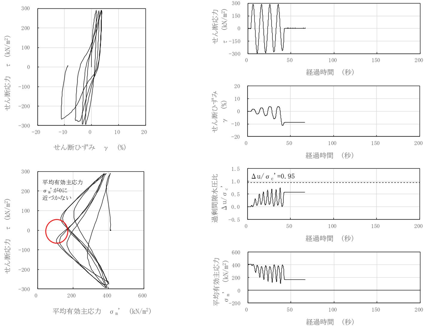
図 3-119 液状化試験結果 (A2s 層, FS02-2-12, GL. -23.30~23.45m, 有効拘束圧 412kN/m<sup>2</sup>, せん断応力比=0.710)
