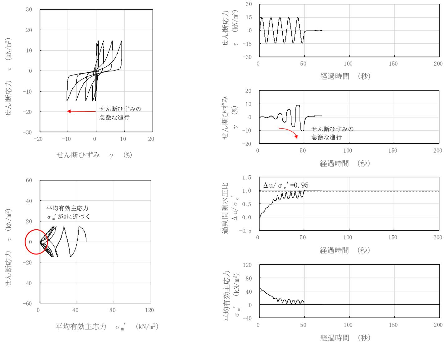
図 3-47 液状化試験結果 (埋戻土, GTG-S4-④, GL. -10.35~10.87m, 有効拘束圧 50kN/m<sup>2</sup>, せん断応力比=0.292)
