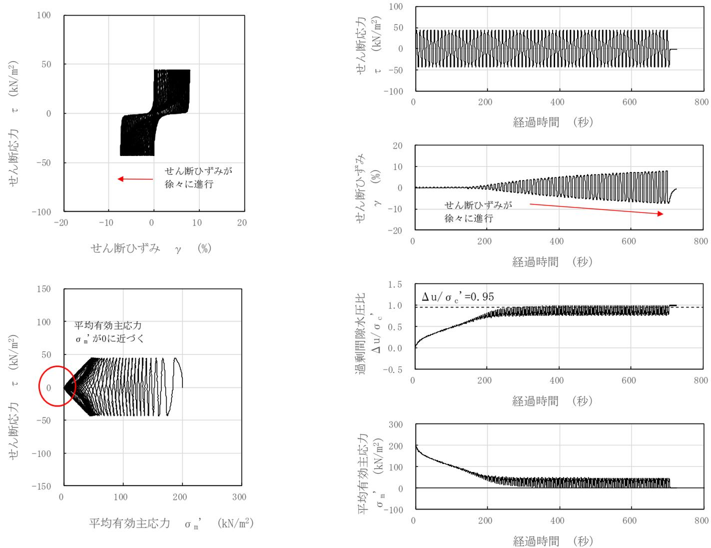
図 3-60 液状化試験結果 (新期砂層, GTG-S4-⑥, GL. -14.22~14.87m, 有効拘束圧  $200\text{kN/m}^2$ , せん断応力比=0.217)
