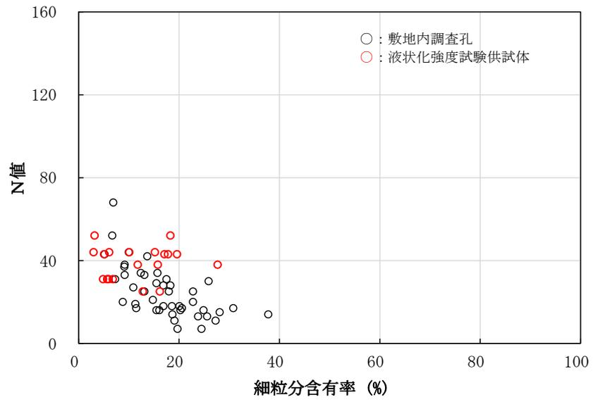
図 4-33 液状化強度試験箇所及び敷地内調査孔の細粒分含有率  $F_c$  と N 値の関係
