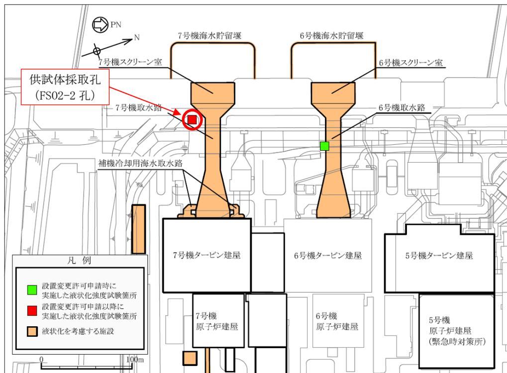
図 2-2 A2s 層の供試体の採取位置
