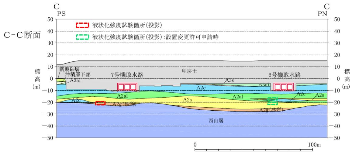
図 4-19 A2s 層の液状化強度試験の試料採取位置
