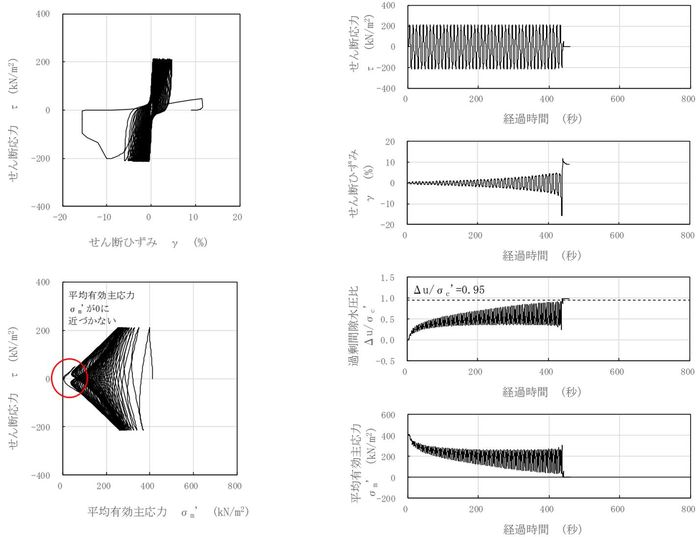
図 3-108 液状化試験結果 (A2s 層, FS-3-8-3, GL. -33.73~33.88m, 有効拘束圧 412 $\text{kN/m}^2$ , せん断応力比=0.515)
