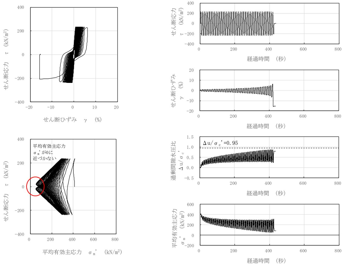
図 3-111 液状化試験結果 (A2s 層, FS-4-8-2, GL. -32.95~33.10m, 有効拘束圧 412kN/m<sup>2</sup>, せん断応力比=0.572)
