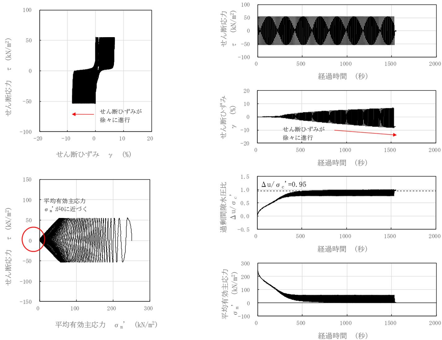
図 3-87 液状化試験結果（沖積層下部，GTG-S6'-⑥，GL.-12.70~13.70m，有効拘束圧 250kN/m<sup>2</sup>，せん断応力比=0.216）
