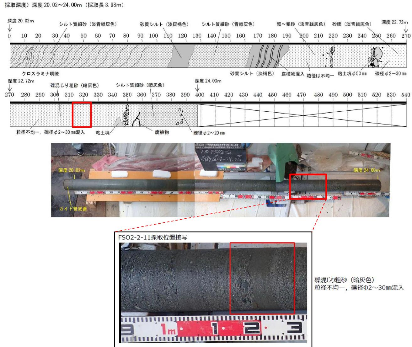
図 2-4 凍結サンプリング写真及び観察スケッチ (供試体番号 : FSO2-2-11)
