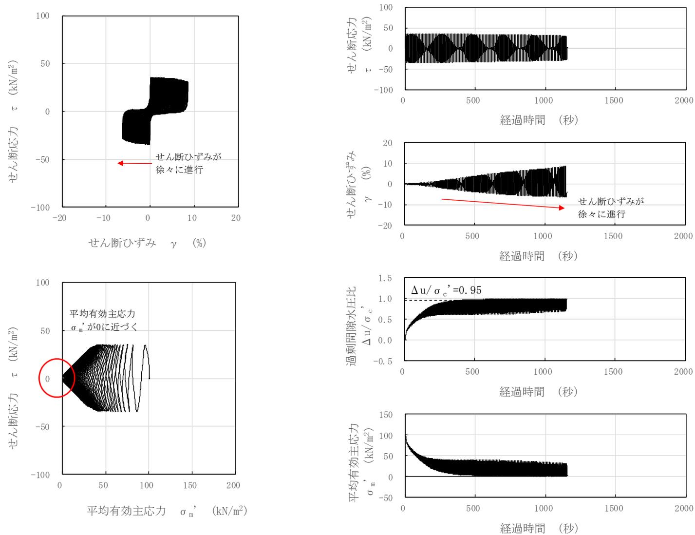
図 3-71 液状化試験結果（沖積層上部（砂質），S0-S1-7-3，GL. -13.35~13.47m，有効拘束圧 100kN/m<sup>2</sup>，せん断応力比=0.346）
