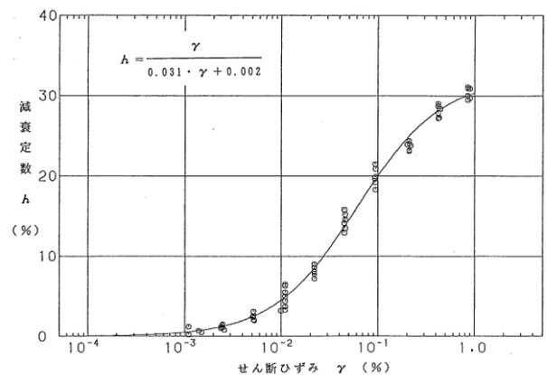
図 4-2 新期砂層・沖積層の動せん断弾性係数及び減衰定数のひずみ依存特性
