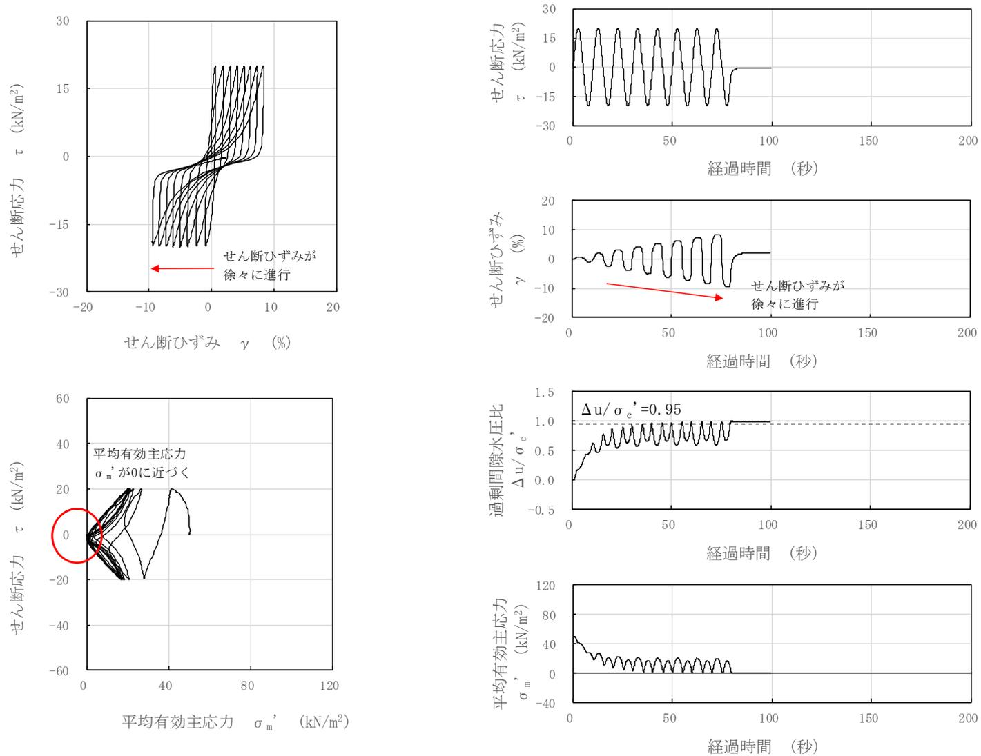
図 3-44 液状化試験結果 (埋戻土, GTG-S3-⑤, GL. -5.05~5.57m, 有効拘束圧 50kN/m<sup>2</sup>, せん断応力比=0.398)
