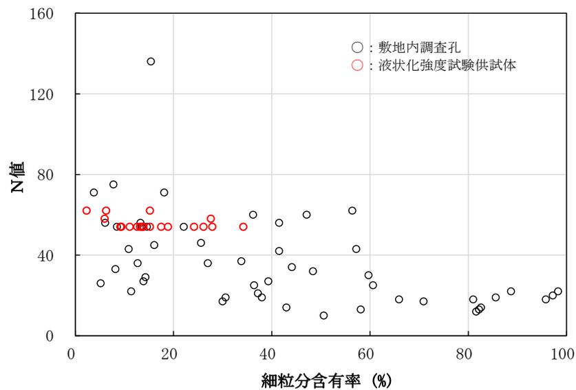
図 2-6 液状化強度試験箇所及び敷地内調査孔の細粒分含有率  $F_c$  とN値の関係
