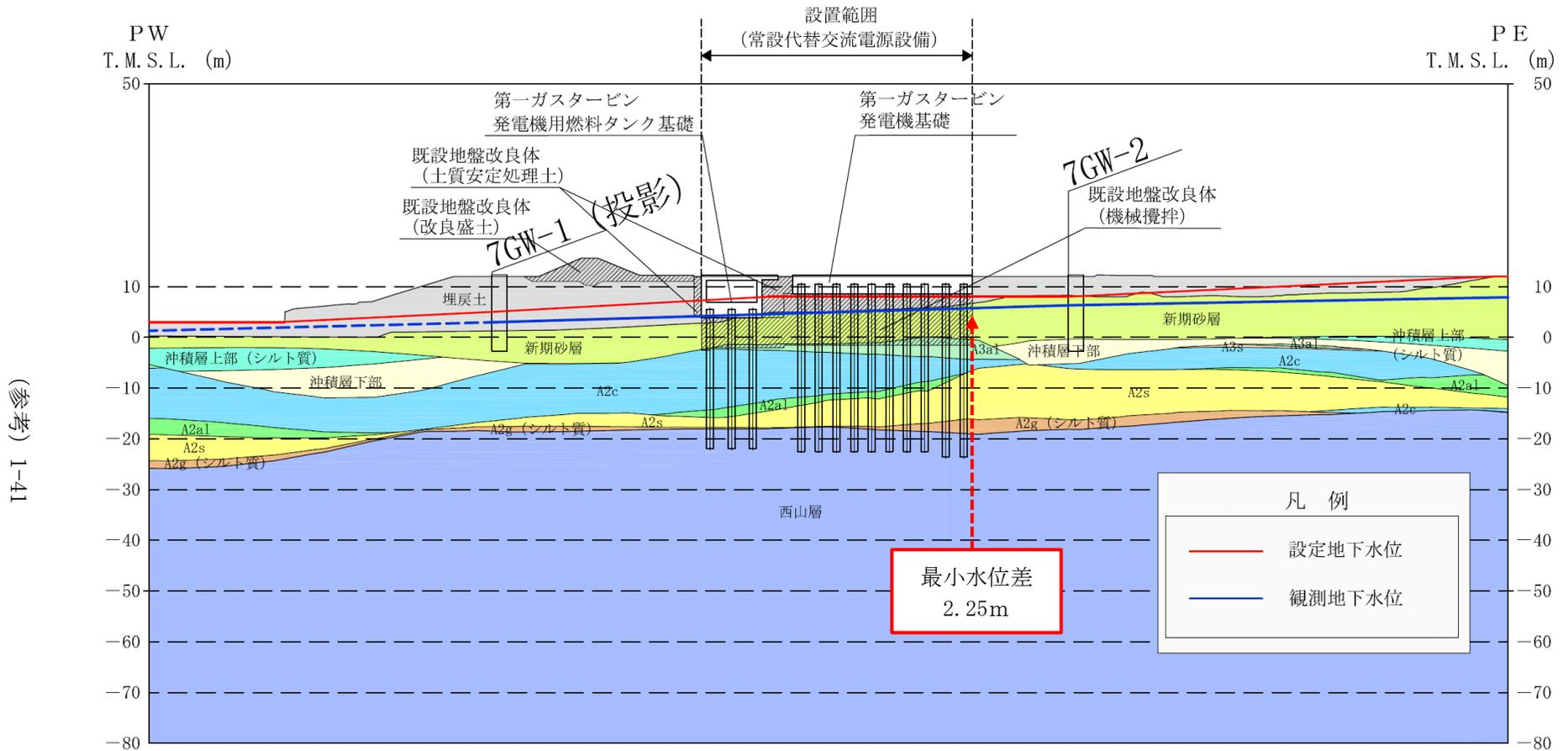
注：耐震評価に用いる地下水位に対する常設代替交流電源設備の設置範囲における地下水位の余裕が最も小さい日時（2018年3月1日06:00）のデータ
