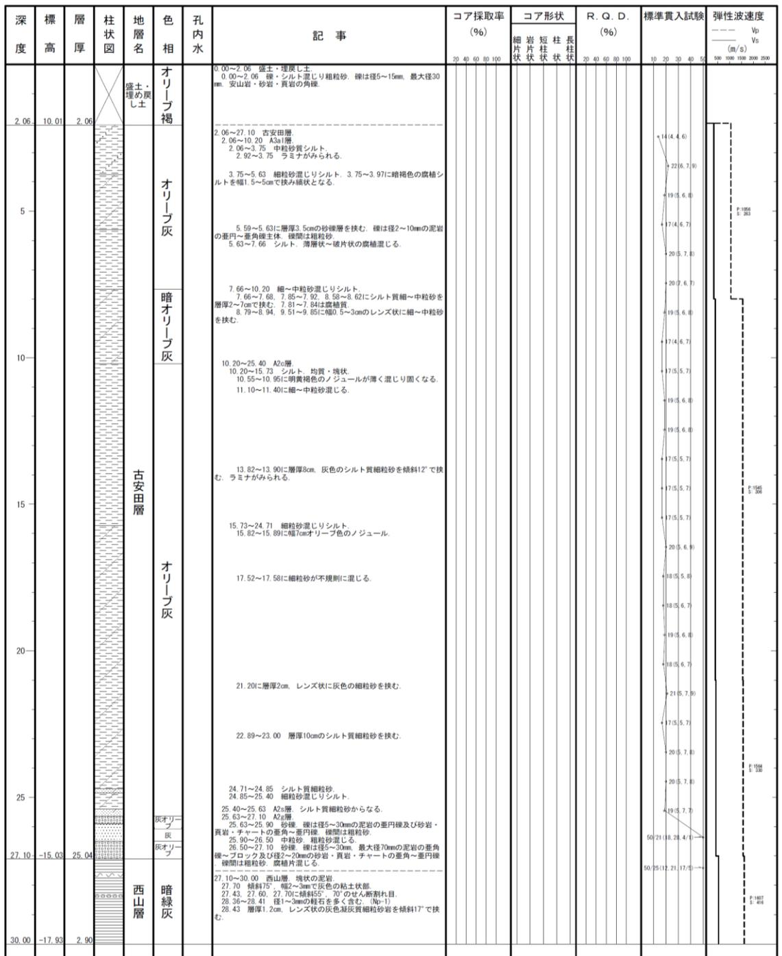
図 2-61 ボーリング柱状図 (H5-P1)
