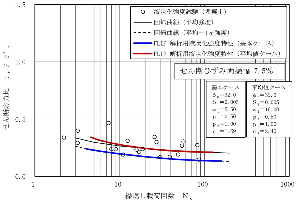
図 3-6 液状化抵抗曲線 (埋戻土)
