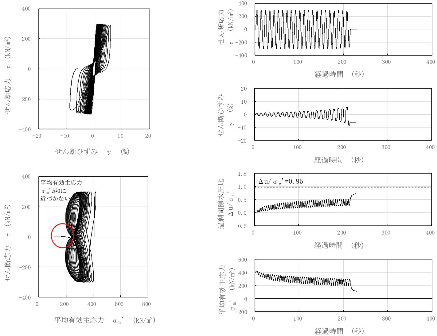
図 3-110 液状化試験結果 (A2s 層, FS-4-7-2, GL. -31.95~32.10m, 有効拘束圧 412kN/m<sup>2</sup>, せん断応力比=0.723)
