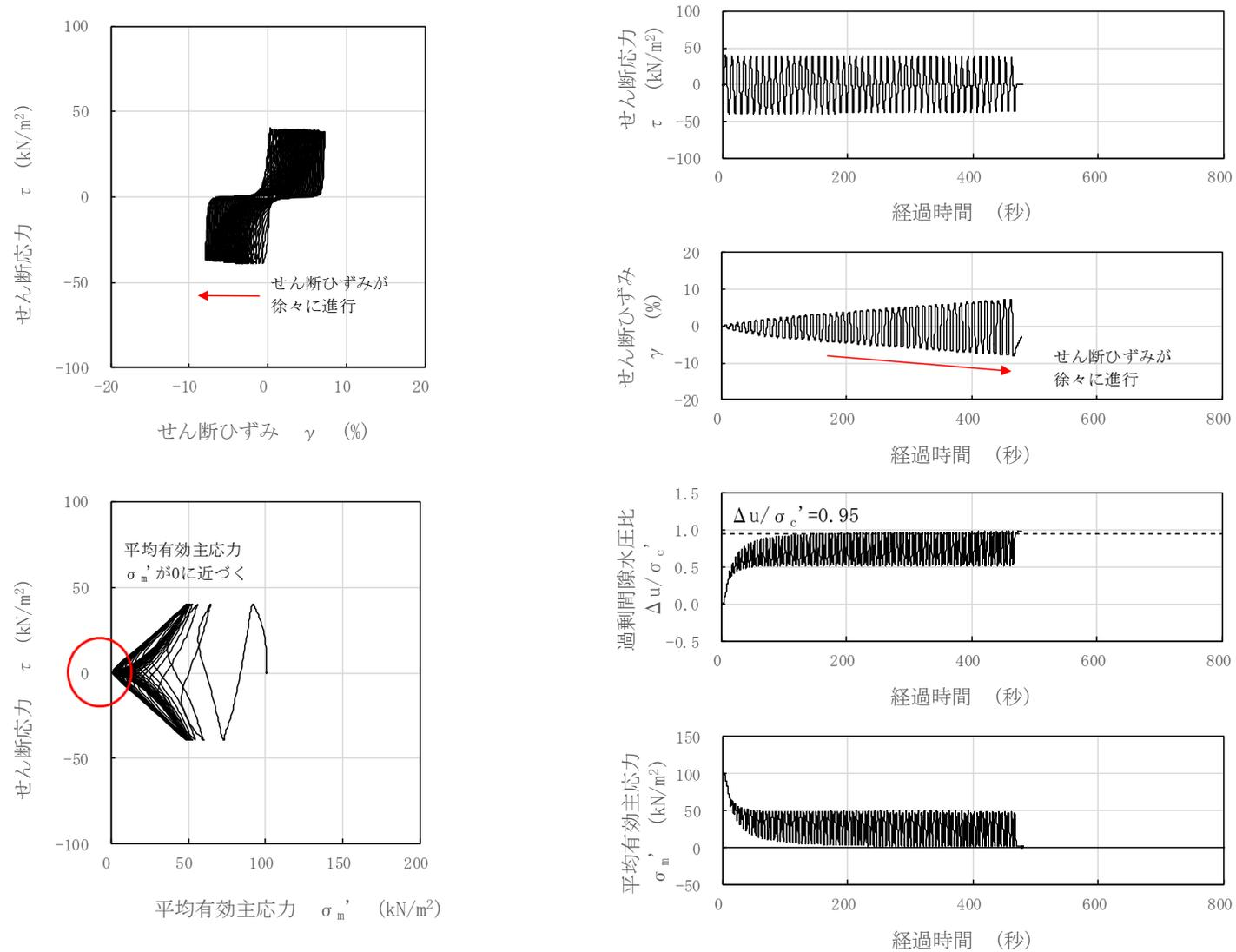
図 3-70 液状化試験結果 (沖積層上部 (砂質), S0-S1-7-2, GL. -13.23~13.35m, 有効拘束圧 100kN/m<sup>2</sup>, せん断応力比=0.395)
