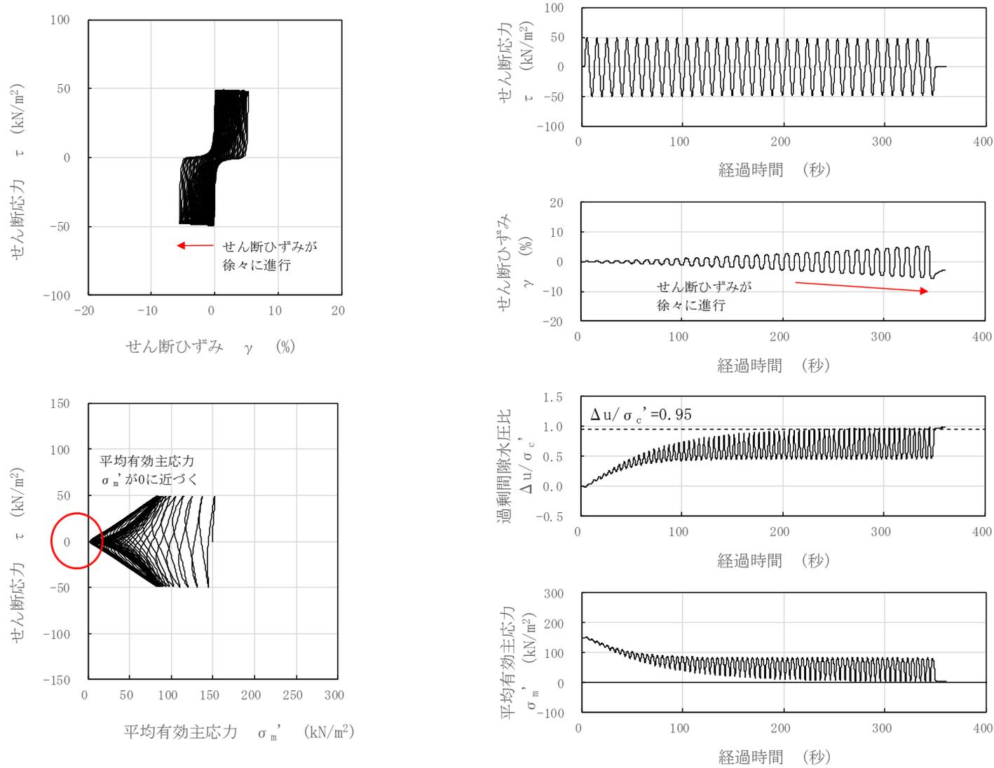
図 3-89 液状化試験結果 (沖積層下部, S0-S1-12-2, GL. -21.22~21.34m, 有効拘束圧 150kN/m<sup>2</sup>, せん断応力比=0.329)
