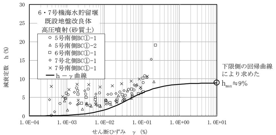
注：図中の $h-\gamma$ 曲線は各プロットの下限側の回帰を示す。
