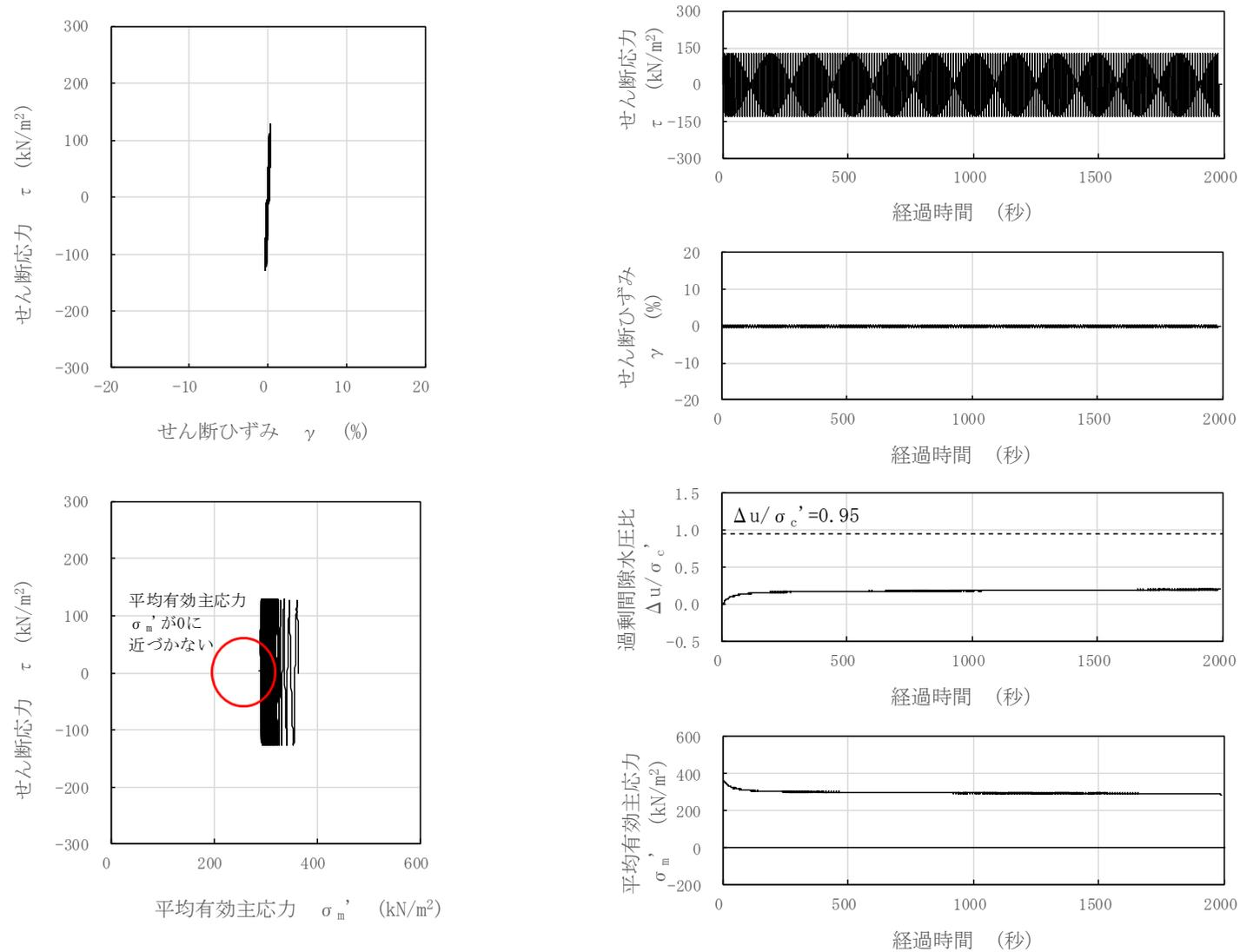
図 3-105 液状化試験結果 (A2s 層, FS-3-1-4, GL. -27.18~27.33m, 有効拘束圧 363kN/m<sup>2</sup>, せん断応力比=0.350)
