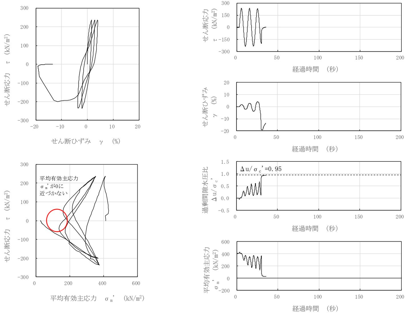
図 3-116 液状化試験結果 (A2s 層, FS02-2-9, GL. -22.85~23.00m, 有効拘束圧 412kN/m<sup>2</sup>, せん断応力比=0.575)
