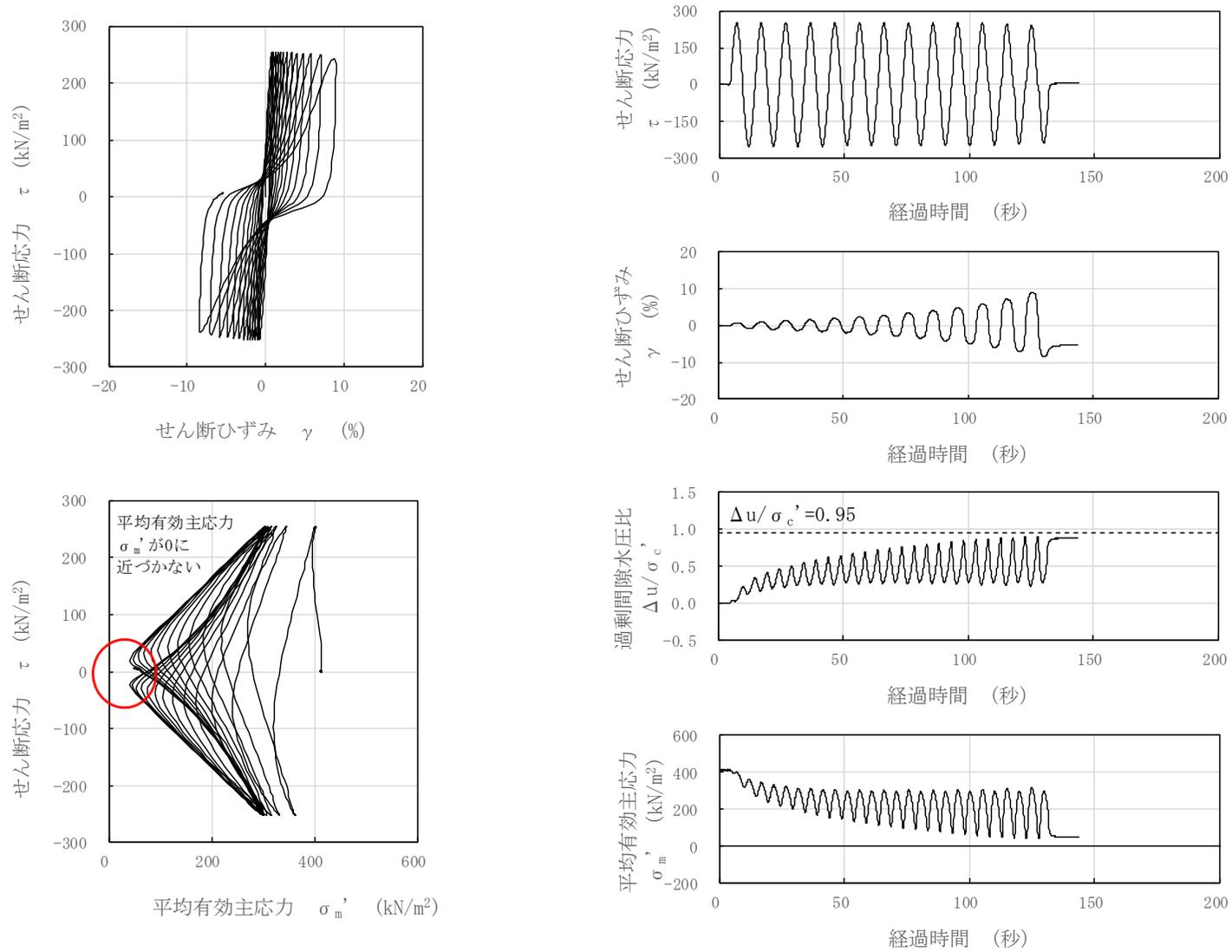
図 3-127 液状化試験結果 (A2s 層, FS02-2-20, GL. -25.40~25.55m, 有効拘束圧 412kN/m<sup>2</sup>, せん断応力比=0.616)
