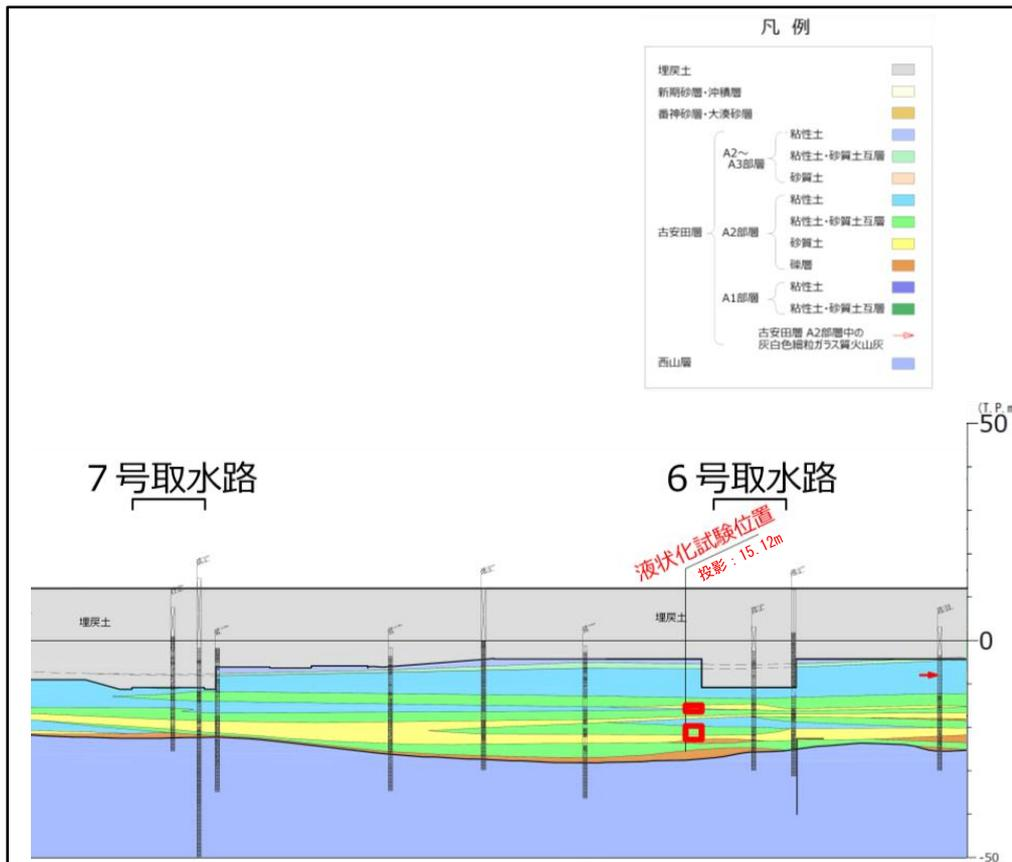
(b) 試料採取位置 断面図 (O-1)
