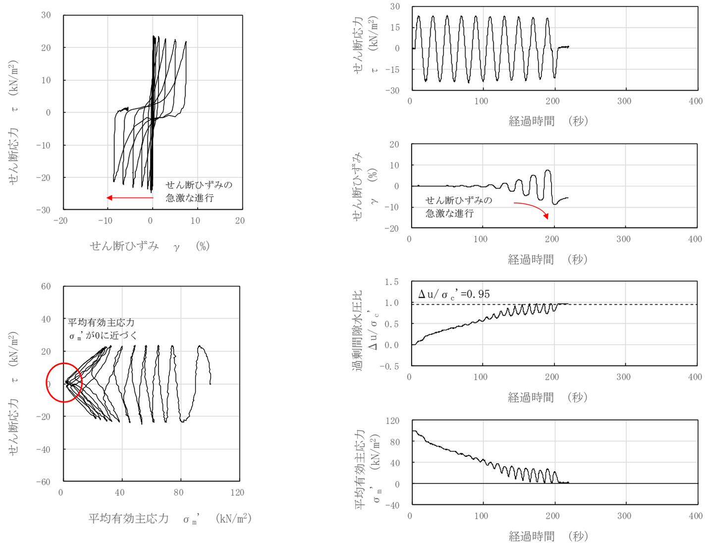
図 3-36 液状化試験結果 (埋戻土, S0-S2"-4-6, GL. -5.58~5.70m, 有効拘束圧 100kN/m<sup>2</sup>, せん断応力比=0.236)
