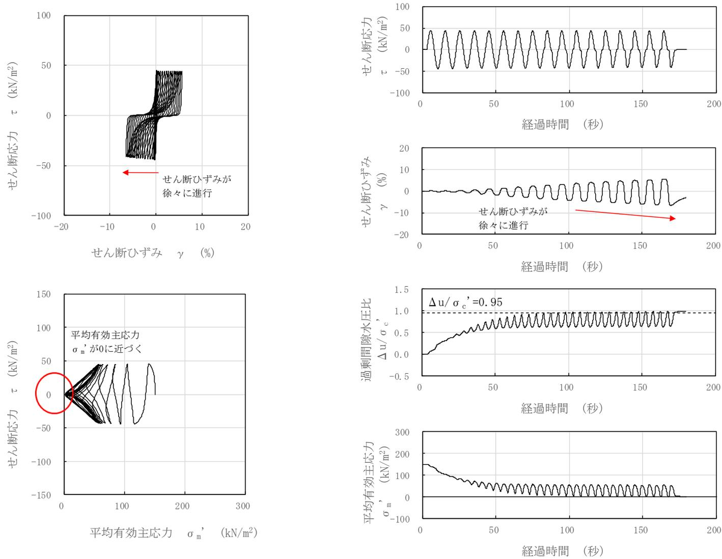
図 3-88 液状化試験結果 (沖積層下部, S0-S1-12-1, GL. -21.10~21.22m, 有効拘束圧 150kN/m<sup>2</sup>, せん断応力比=0.295)
