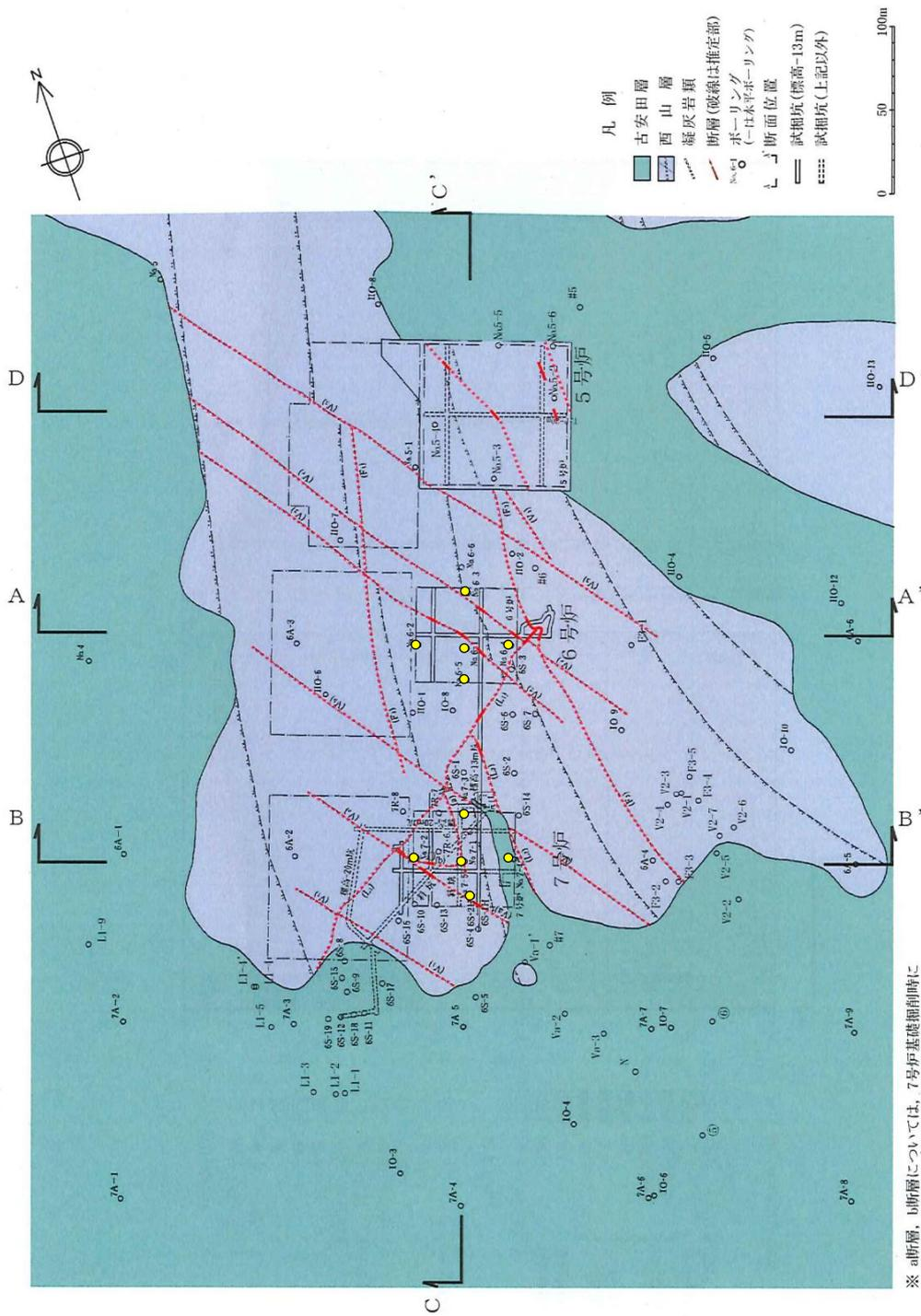
※ a断層, b断層については, 7号炉基礎掘削時にすべて取り除いており, 現在は存在しない。
