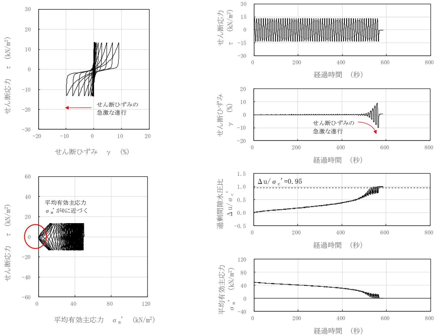
図 3-46 液状化試験結果 (埋戻土, GTG-S4-③, GL. -10.35~10.87m, 有効拘束圧 50kN/m<sup>2</sup>, せん断応力比=0.267)
