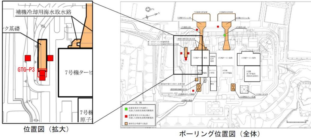
孔名：GTG-P3 孔口標高：T. M. S. L. 12. 20m 掘進長：L=33. 0m (設置変更許可申請以降の液化化強度試験箇所)
