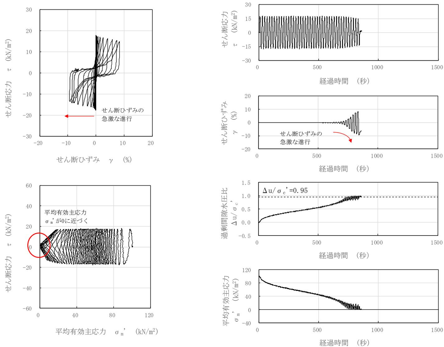
図 3-29 液状化試験結果 (埋戻土, S0-S2''-2-7, GL. -3.66~3.78m, 有効拘束圧 100kN/m<sup>2</sup>, せん断応力比=0.171)
