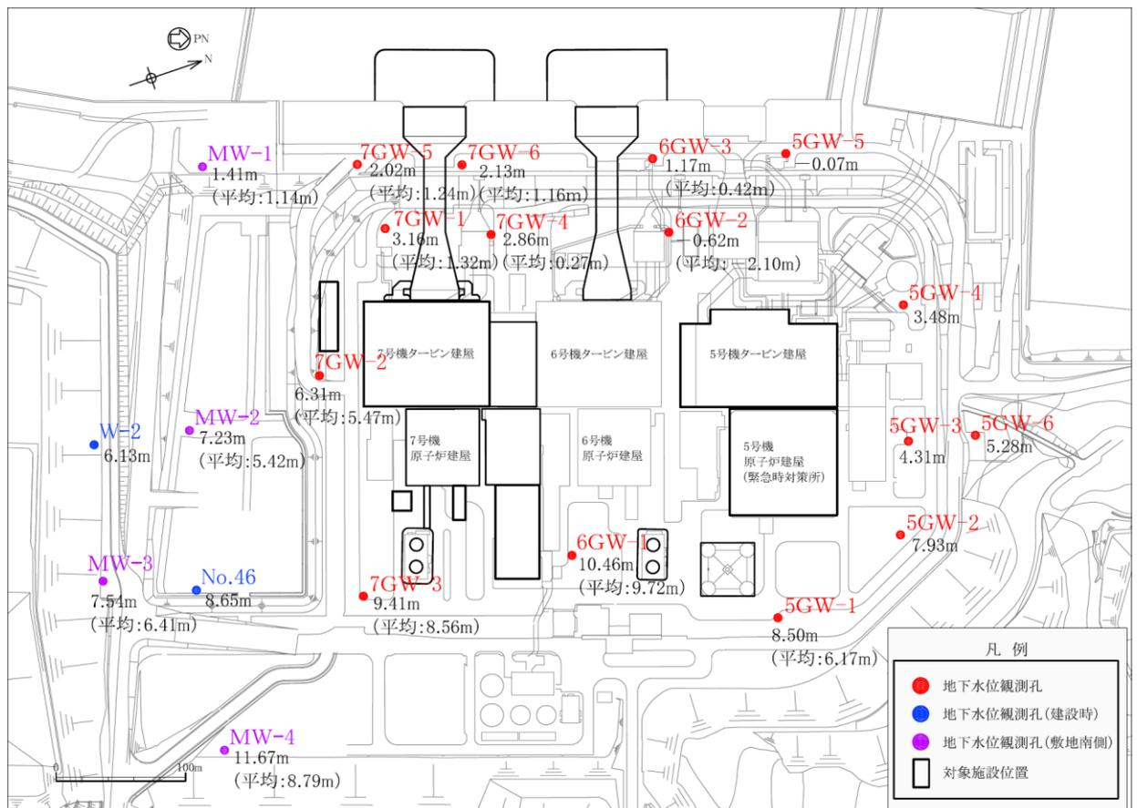
注1： 図中の数値は、各地下水位観測孔の観測最高地下水位の標高（T.M.S.L.）を示す。
