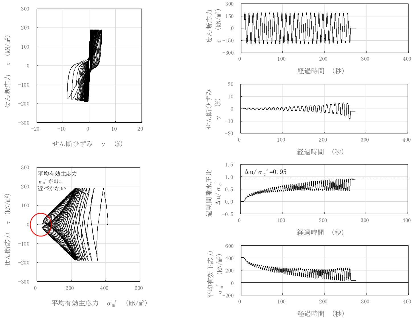
図 2-7 液状化試験結果 (A2s 層, FS02-2-21, GL. -25.55~25.70m, 有効拘束圧 412kN/m<sup>2</sup>, せん断応力比=0.460)
