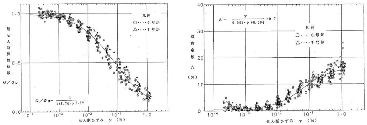
図 4-5 椎谷層の動せん断弾性係数及び減衰定数のひずみ依存特性
