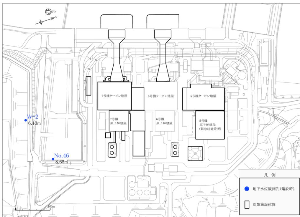
注： 図中の数値は、各地下水位観測孔の観測最高地下水位の標高（T. M. S. L.）を示す。
