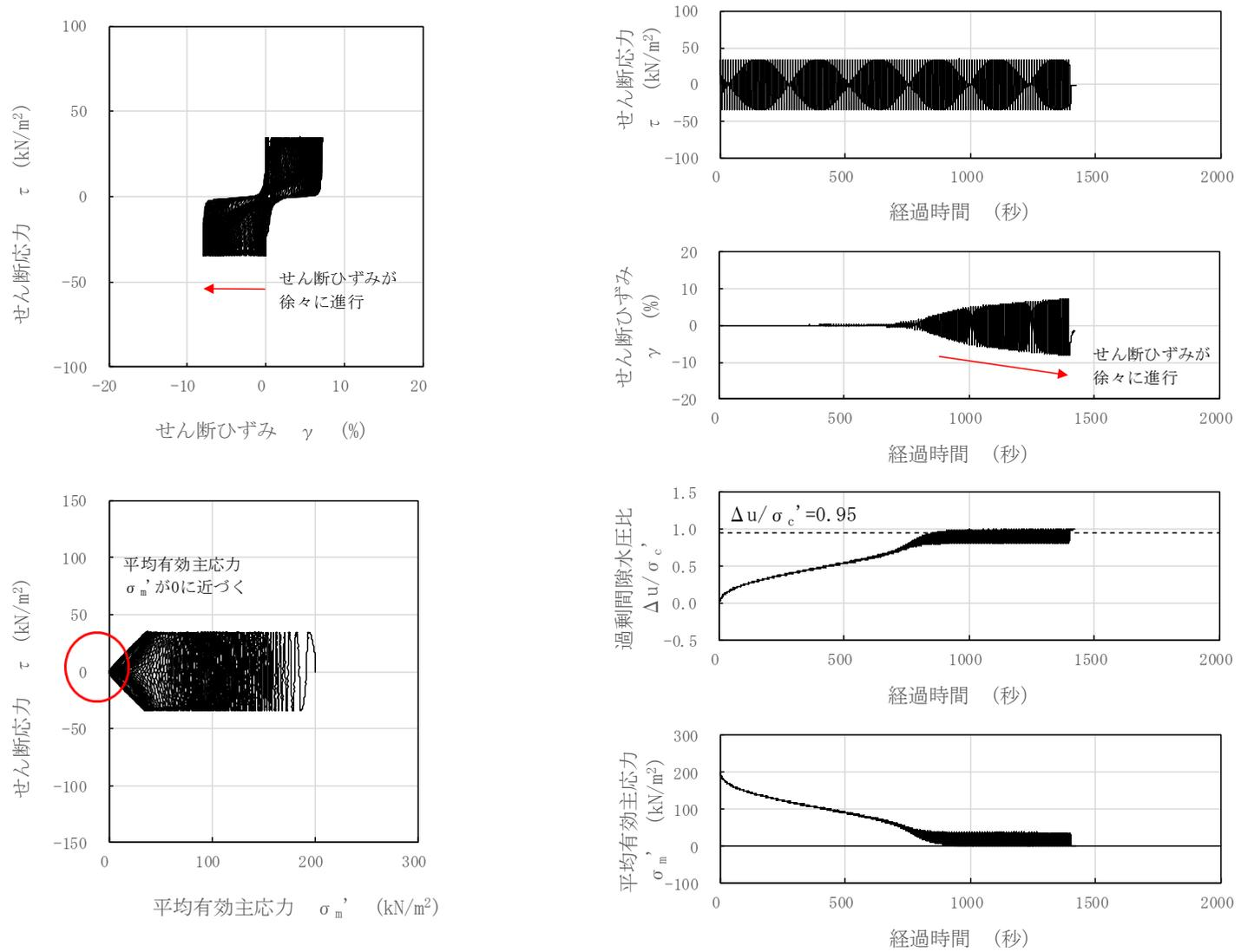
図 3-56 液状化試験結果 (新期砂層, GTG-S3-⑤, GL. -10.85~11.37m, 有効拘束圧 200kN/m<sup>2</sup>, せん断応力比=0.172)
