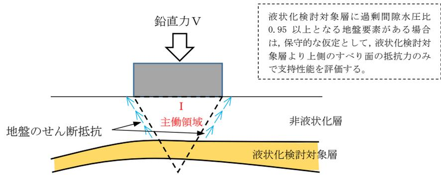
(a) 液状化検討対象層を考慮した支持性能評価の概念図
