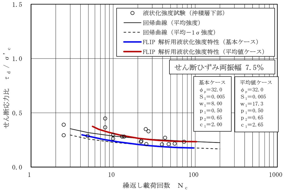
図 3-9 液状化抵抗曲線（沖積層下部）
