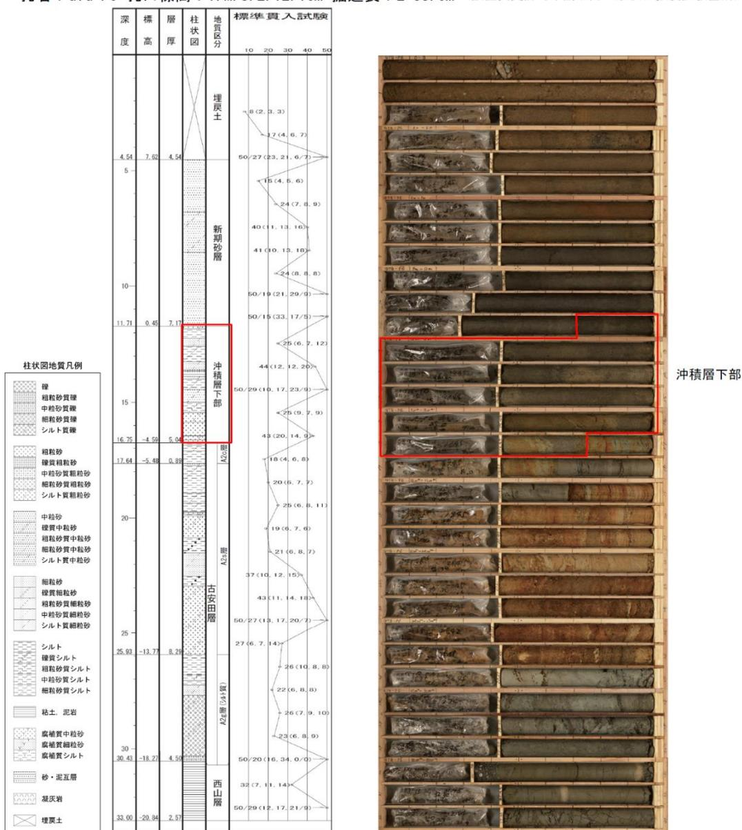
注：図中の赤枠は液状化強度試験の対象地層を示す。
