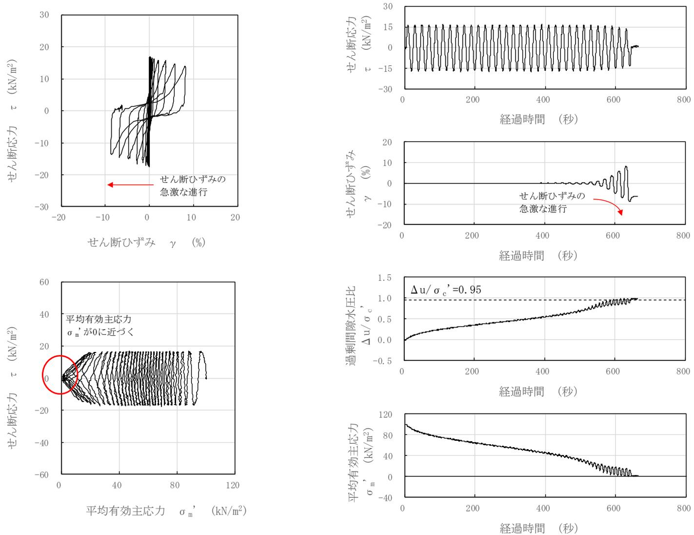
図 3-35 液状化試験結果 (埋戻土, S0-S2'-3-2, GL. -5.13~5.25m, 有効拘束圧 100kN/m<sup>2</sup>, せん断応力比=0.168)
