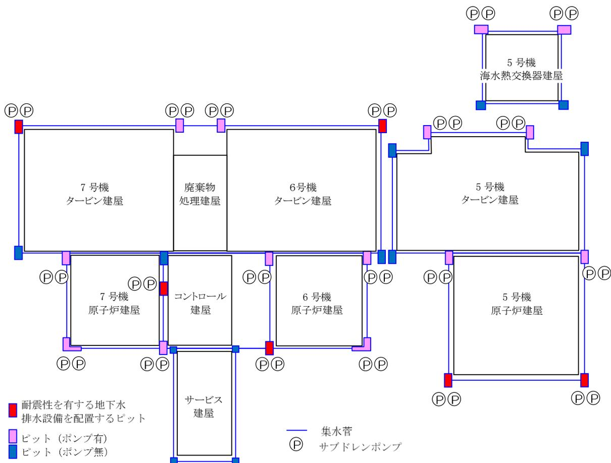
図 3-2 地下水排水設備の平面図
