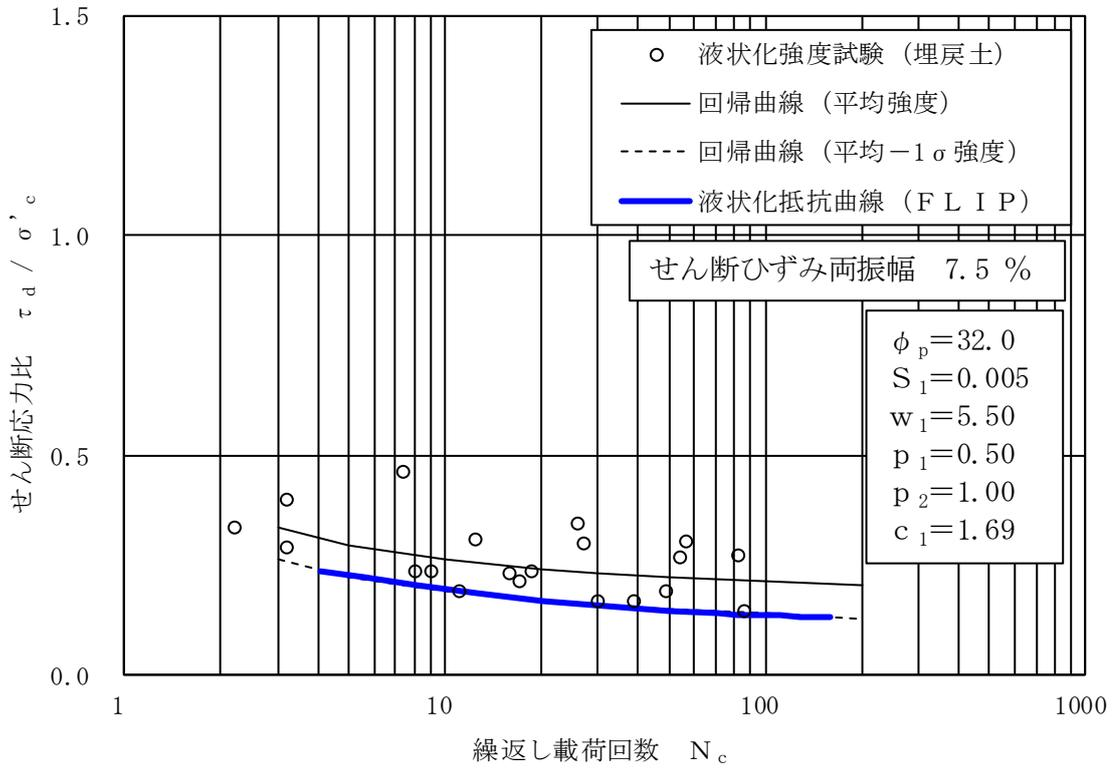
図 4-46 液状化抵抗曲線 (埋戻土)
