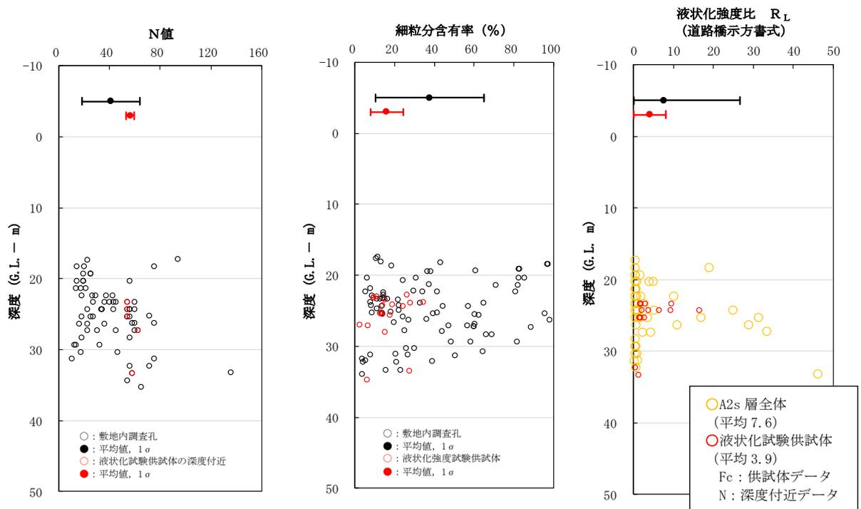
図 2-5 液状化強度試験箇所及び敷地内調査孔のN値，細粒分含有率  $F_c$ ，液状化強度比  $R_L$  の比較
