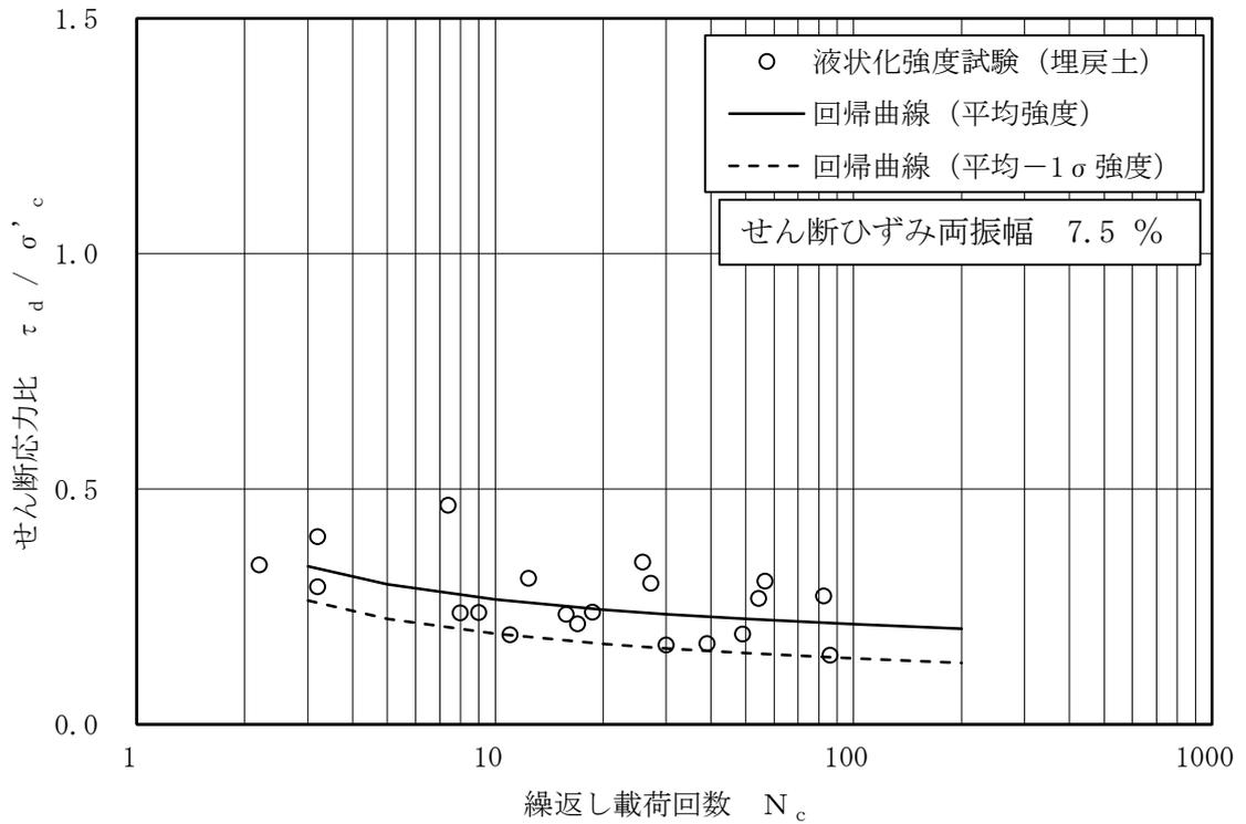
図 4-38 埋戻土の液状化強度試験結果
