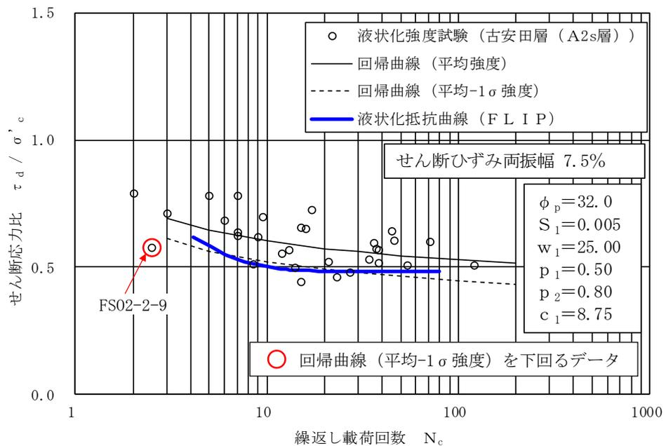
図 4-1 A2s 層の液状化強度試験結果
