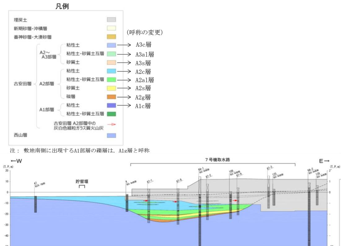
図 2-1 設置変更許可申請段階における地質断面図と地質区分の呼称
