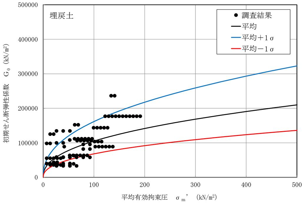
図 2-1  $G_0$  の  $\sigma'_m$  依存式 (埋戻土)
