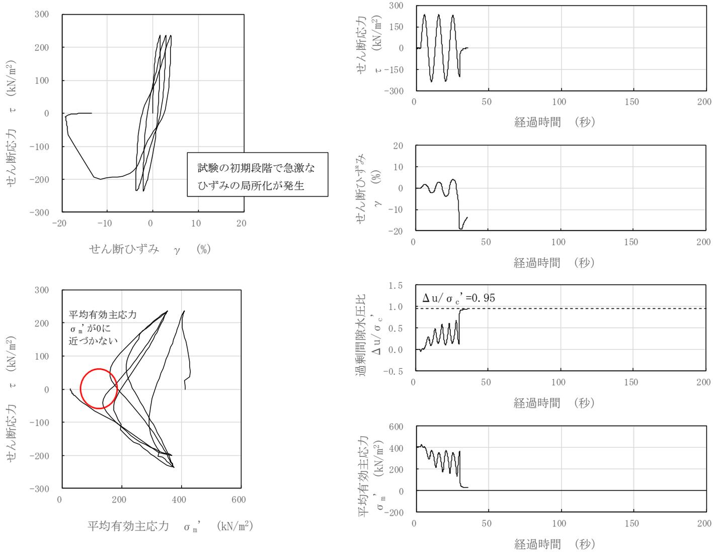
図 4-2 (参考) 液状化試験結果 (A2s 層, FS02-2-9, GL. -22.85~23.00m, 有効拘束圧 412kN/m<sup>2</sup>, せん断応力比=0.575)
