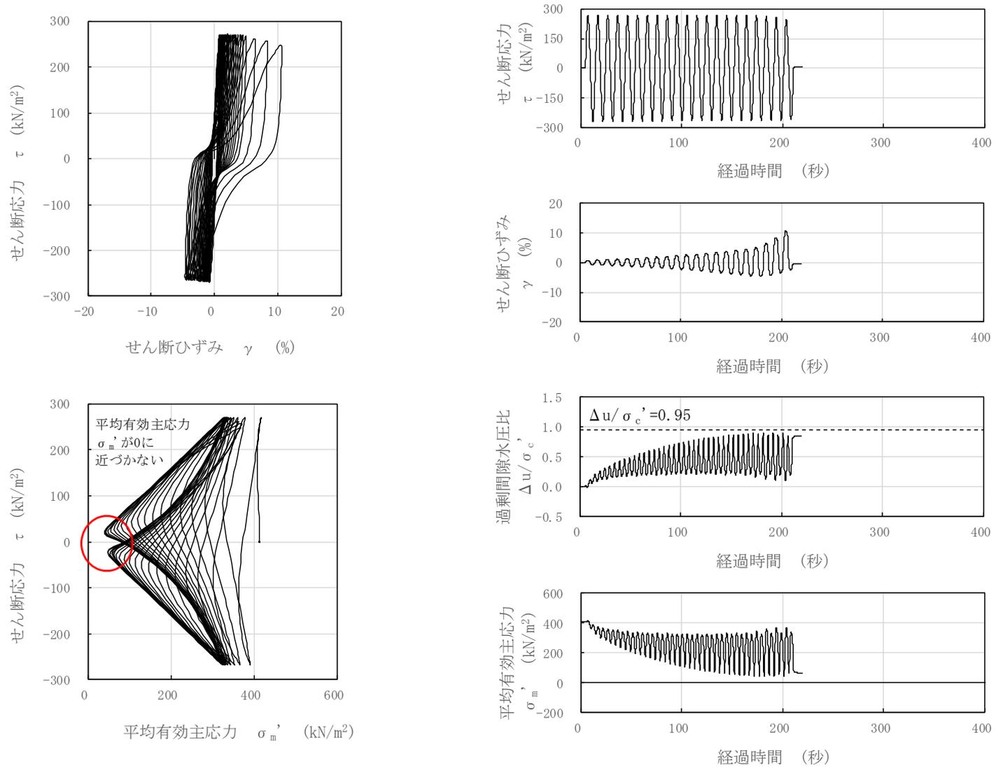
図 3-121 液状化試験結果 (A2s 層, FS02-2-14, GL. -24.00~24.15m, 有効拘束圧 412kN/m<sup>2</sup>, せん断応力比=0.655)
