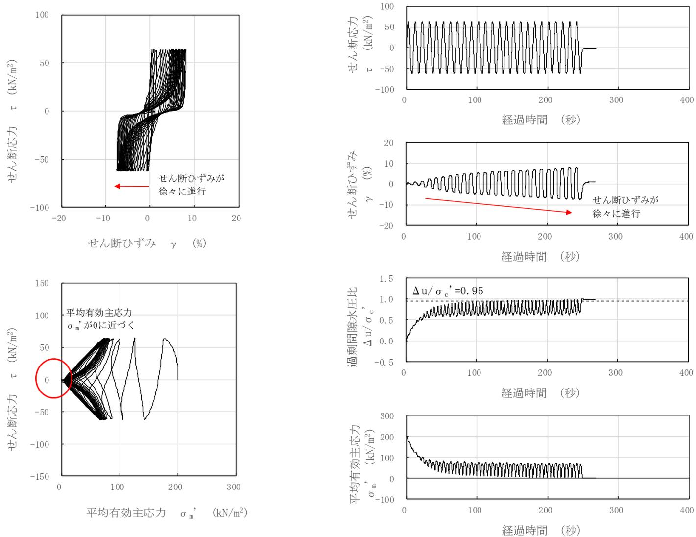
図 3-49 液状化試験結果 (新期砂層, GTG-S3-③, GL. -6.72~7.24m, 有効拘束圧 200kN/m<sup>2</sup>, せん断応力比=0.314)
