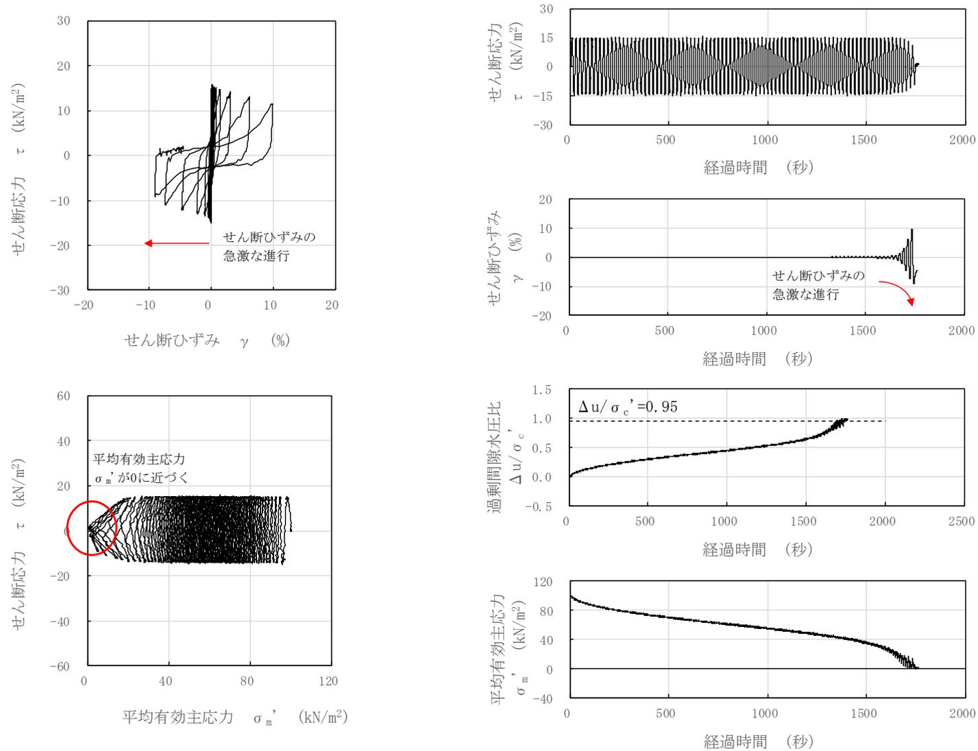
図 3-34 液状化試験結果 (埋戻土, S0-S2-3-5, GL. -5.39~5.51m, 有効拘束圧 100kN/m<sup>2</sup>, せん断応力比=0.146)
