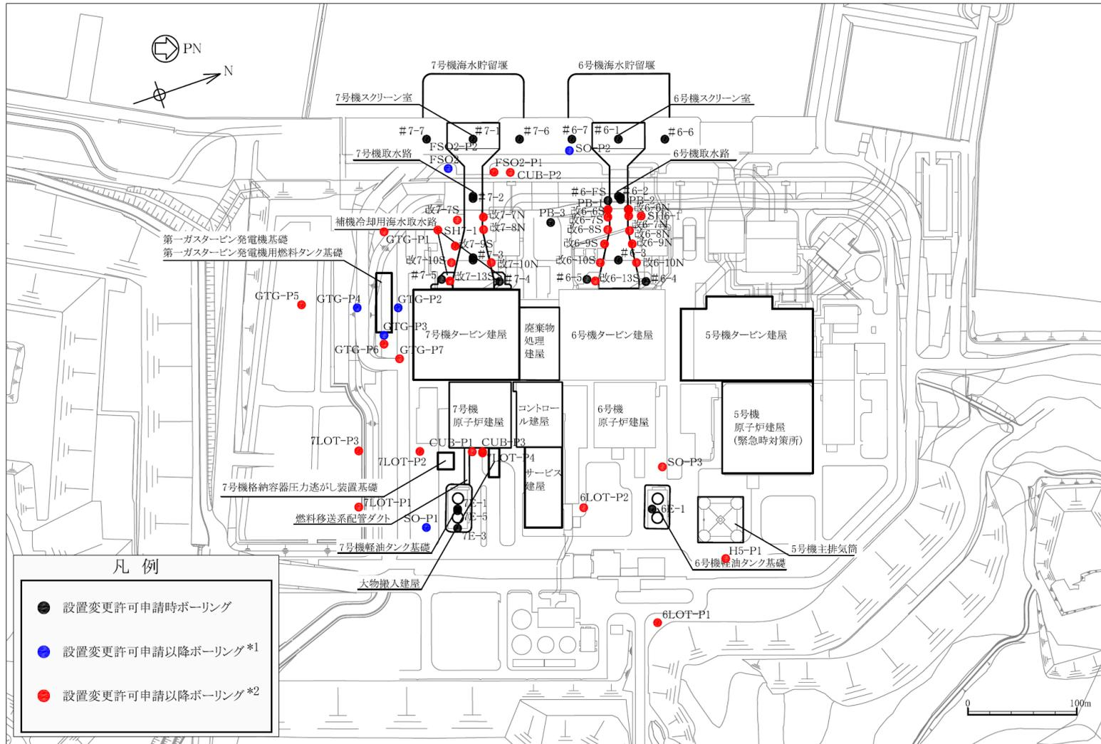
注記\*1：発電用原子炉設置変更許可申請（原管発官 25 第 192 号）に係る審査資料の第 4 条：地震による損傷の防止 別紙-11：液状化影響の検討方針について（耐震） 3.3 追加調査位置に記載の試験箇所を示す。
