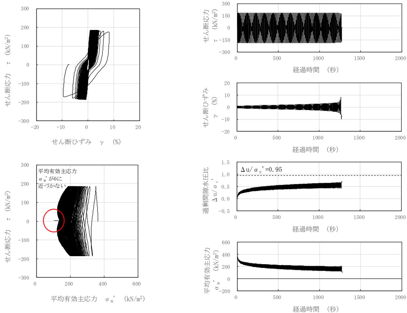
図 3-99 液状化試験結果 (A2s 層, FS-4-1-2, GL. -26.95~27.12m, 有効拘束圧  $363 \text{ kN/m}^2$ , せん断応力比=0.508)
