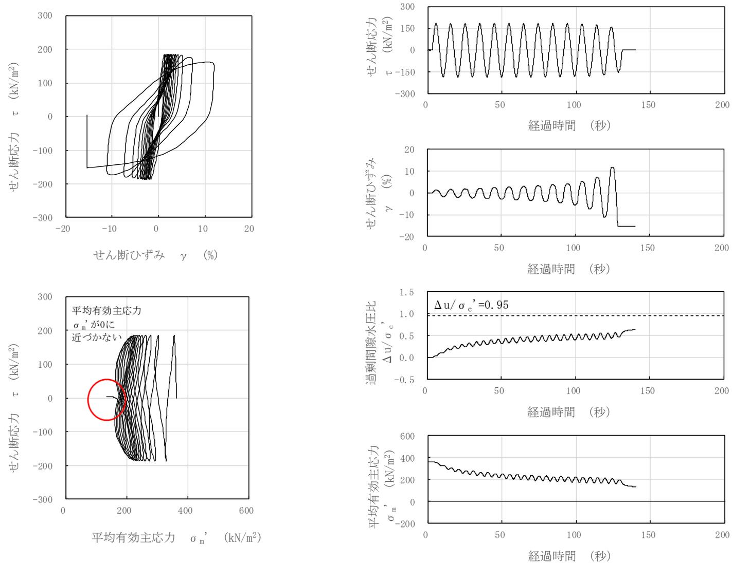
図 3-103 液状化試験結果 (A2s 層, FS-3-1-2, GL. -26.88~27.03m, 有効拘束圧 363 $\text{kN/m}^2$ , せん断応力比=0.511)
