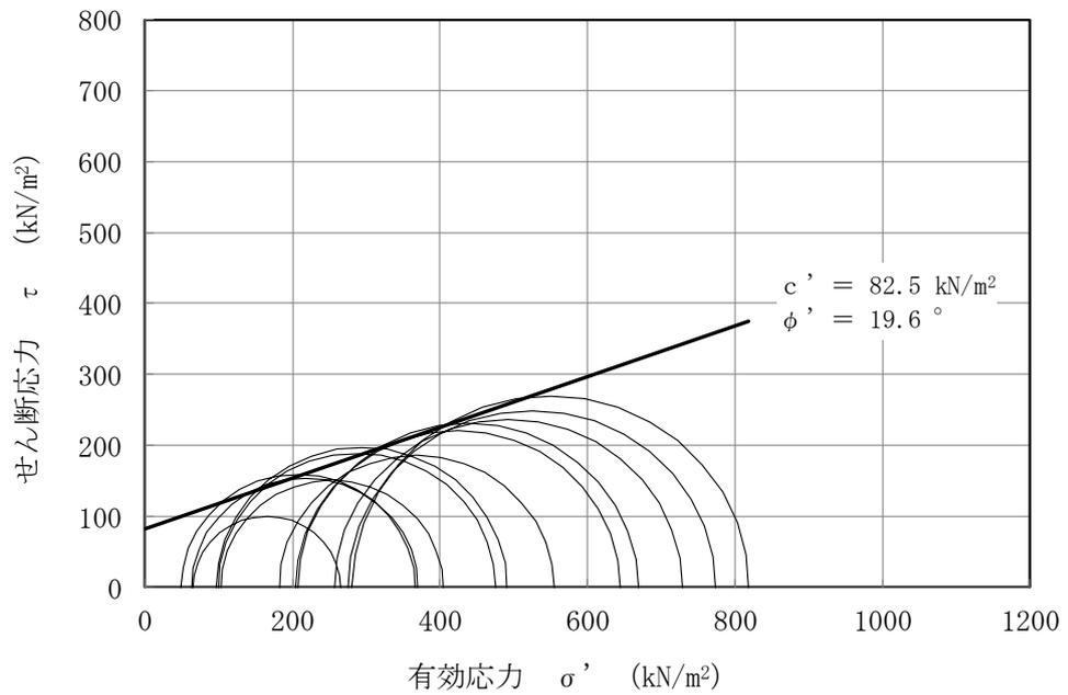
図 3-16 沖積層上部(シルト質)の三軸圧縮試験結果及び強度定数
