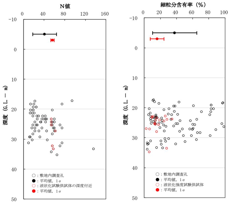
図 4-36 液状化強度試験箇所及び敷地内調査孔のN値，細粒分含有率  $F_c$  の比較
