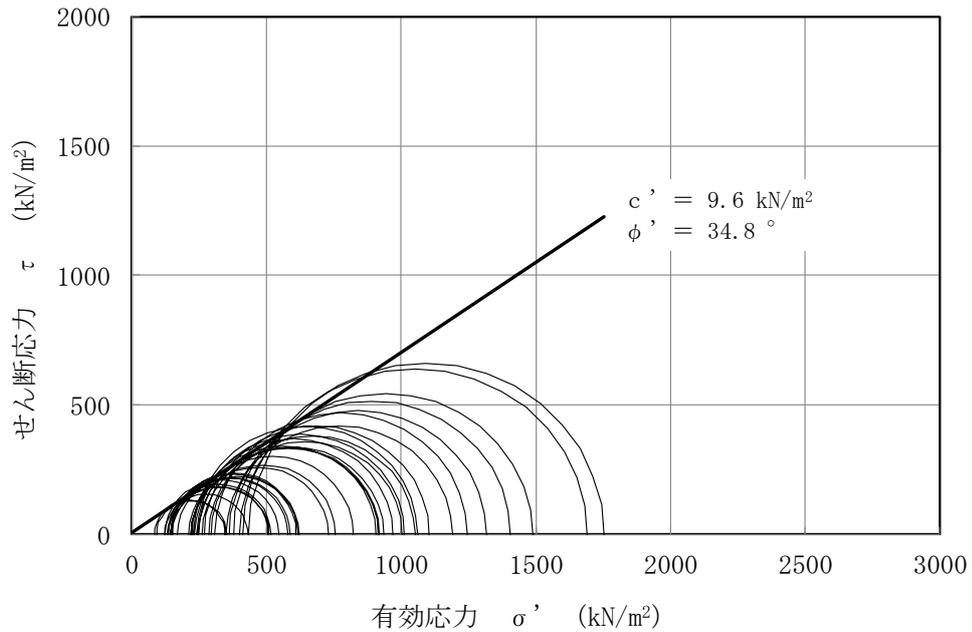
図 3-13 埋戻土の三軸圧縮試験結果及び強度定数
