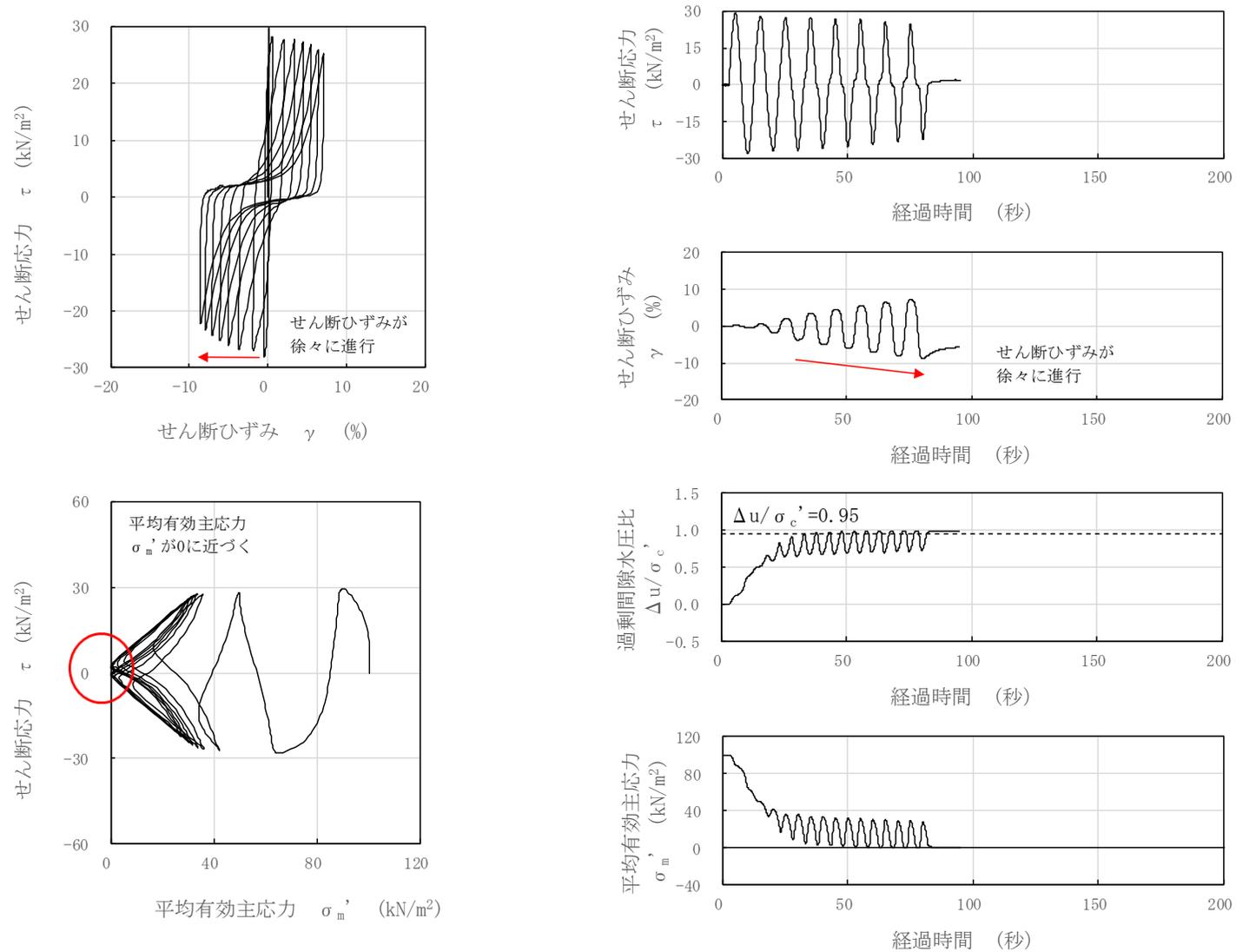
図 3-65 液状化試験結果 (新期砂層, S0-S1-2-3, GL. -7.80~7.92m, 有効拘束圧 100kN/m<sup>2</sup>, せん断応力比=0.281)
