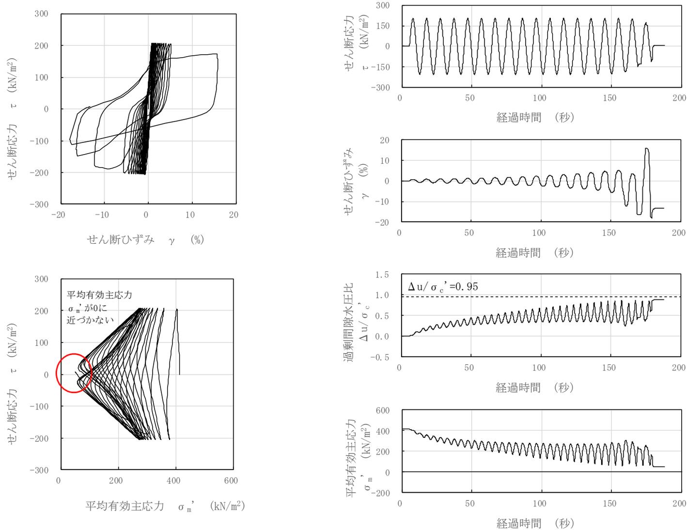
図 3-115 液状化試験結果 (A2s 層, FS02-2-8, GL. -22.70~22.85m, 有効拘束圧 412kN/m<sup>2</sup>, せん断応力比=0.499)
