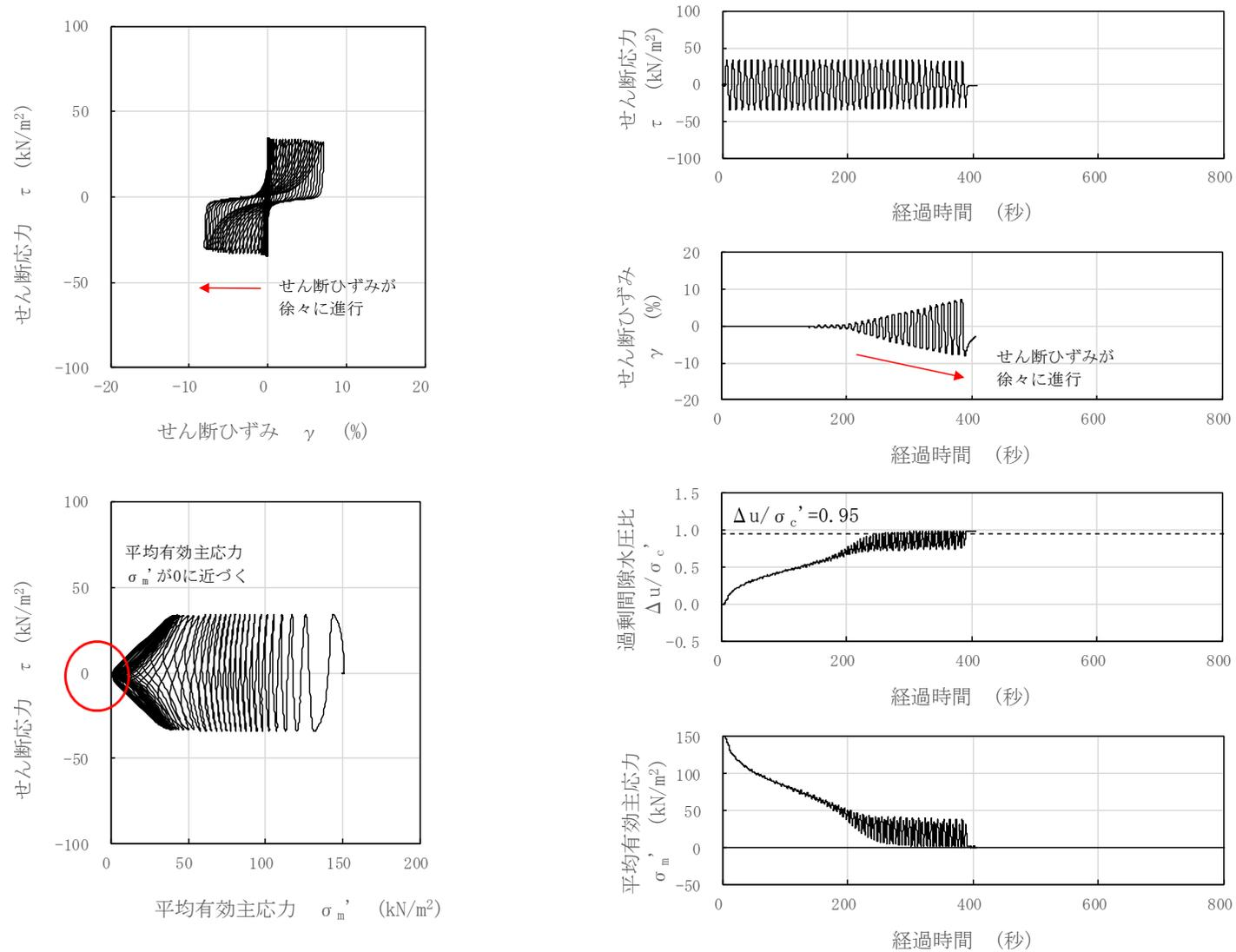
図 2-3 液状化試験結果 (沖積層上部 (砂質), S0-S1-8-6, GL. -14.66~14.78m, 有効拘束圧 150kN/m<sup>2</sup>, せん断応力比=0.227)
