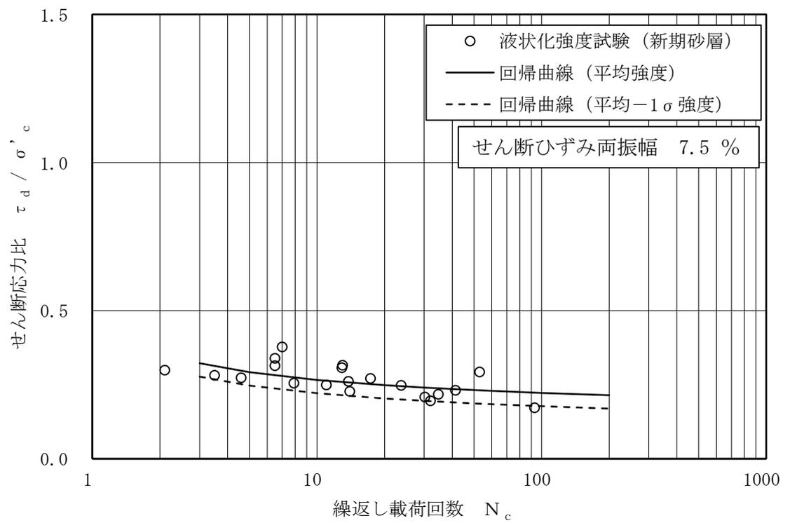
図 4-39 新期砂層の液状化強度試験結果
