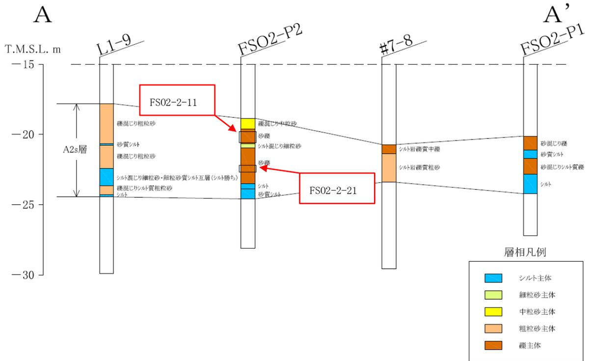
図 2-12 ボーリング柱状図 (A-A' 断面)
