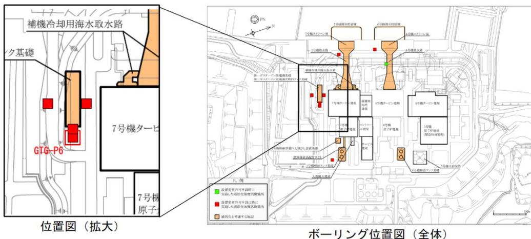
孔名：GTG-P6 孔口標高：T. M. S. L. 12. 16m 掘進長：L=33. 0m (設置変更許可申請以降の液状化強度試験箇所)
