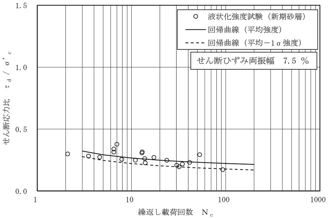
図 3-25 新期砂層の液状化強度試験結果
