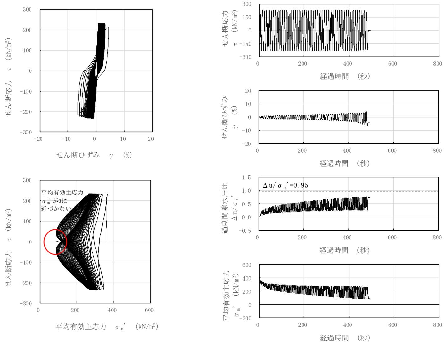
図 3-106 液状化試験結果 (A2s 層, FS-3-1-5, GL. -27.33~27.48m, 有効拘束圧 363kN/m<sup>2</sup>, せん断応力比=0.639)
