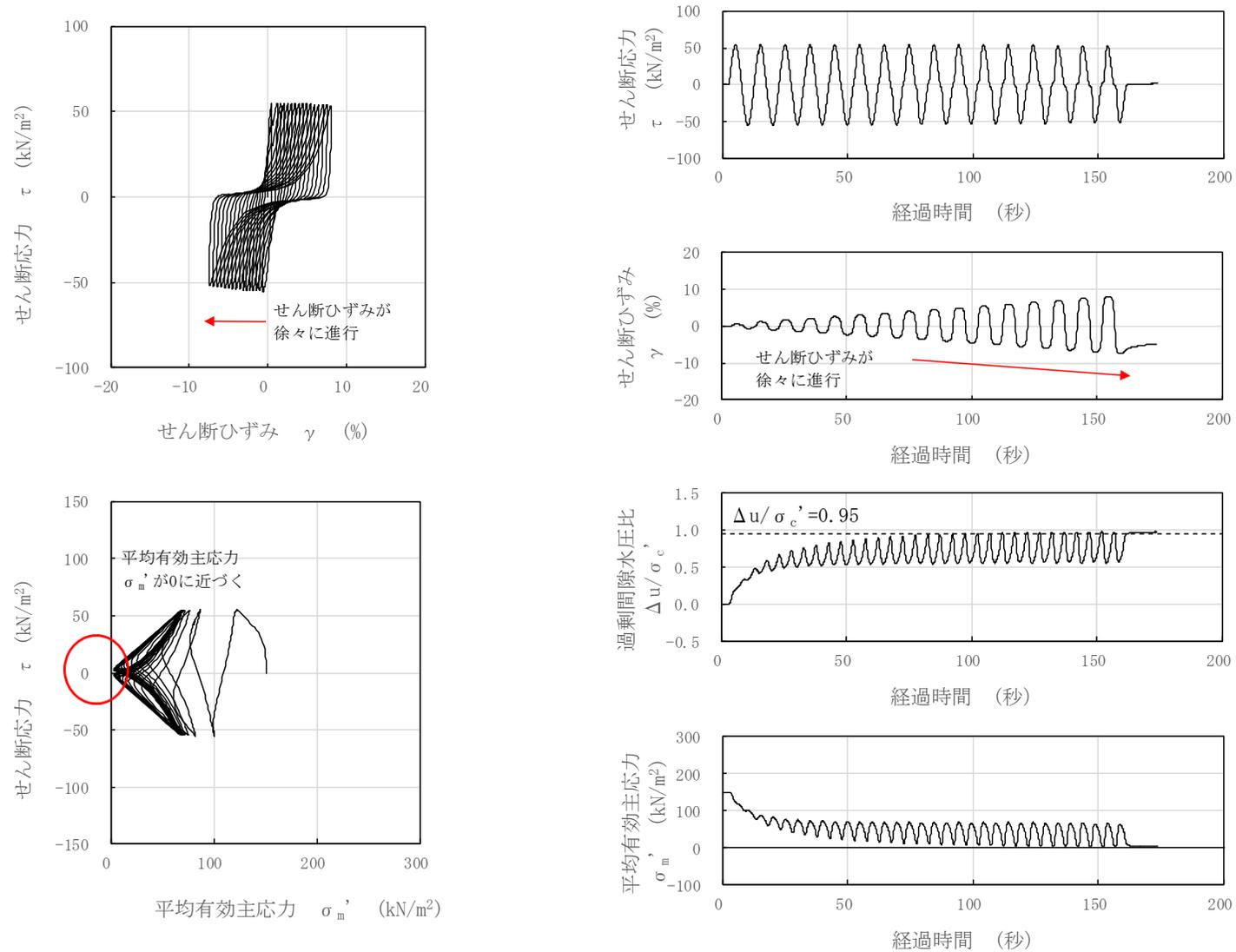
図 3-94 液状化試験結果（沖積層下部，S0-S1-14-5，GL. -23.59～23.71m，有効拘束圧 150kN/m<sup>2</sup>，せん断応力比=0.366）
