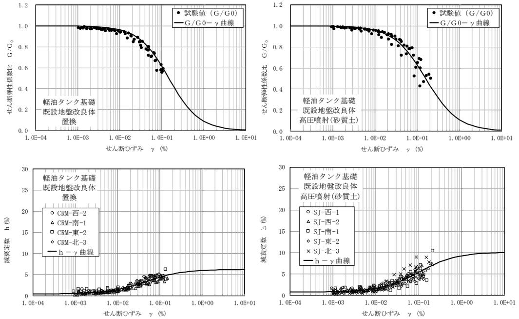
図 4-21 既設地盤改良体の動的変形試験結果
