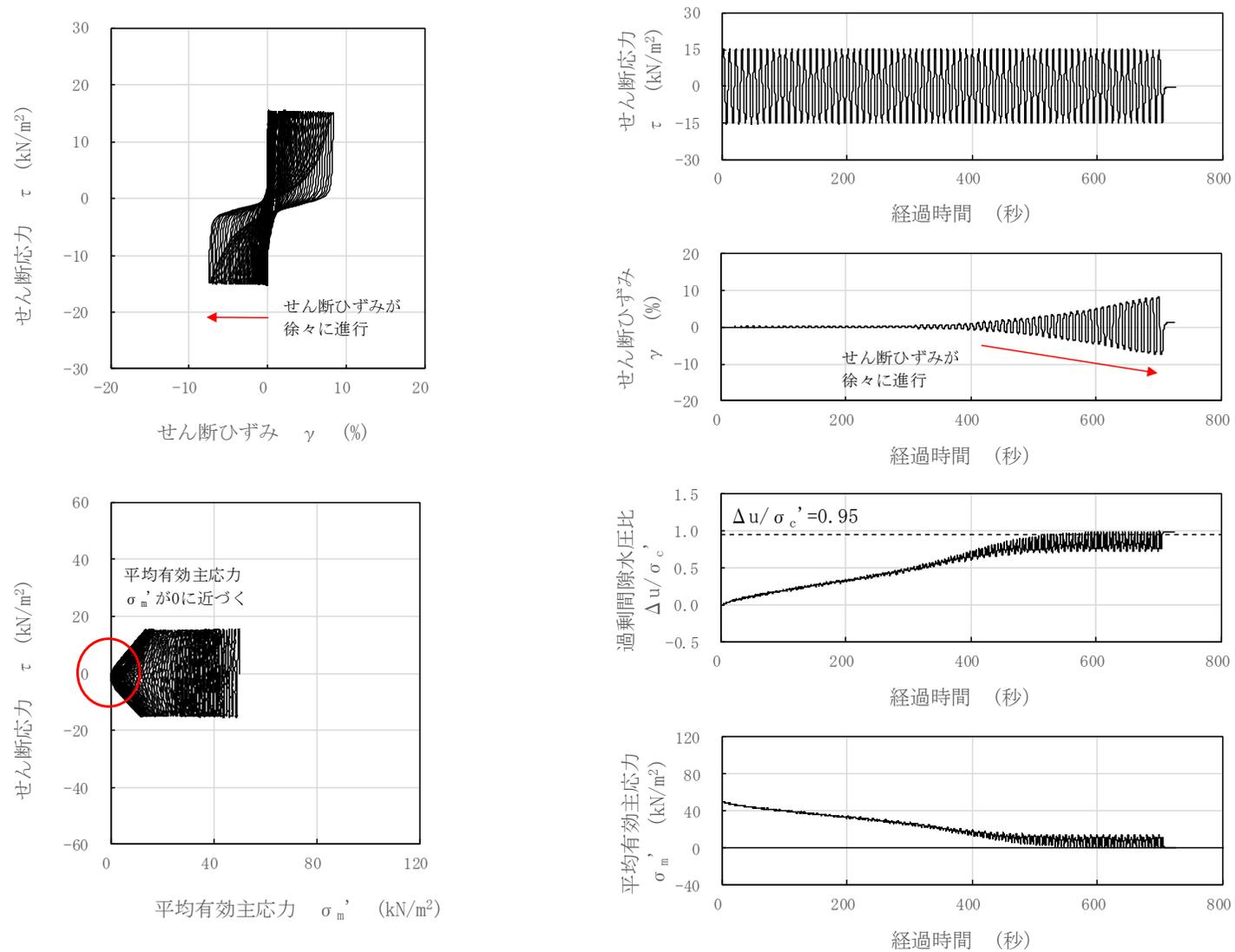
図 3-41 液状化試験結果 (埋戻土, GTG-S3-②, GL. -5.05~5.57m, 有効拘束圧 50kN/m<sup>2</sup>, せん断応力比=0.304)
