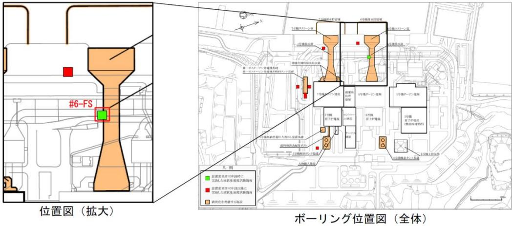
孔名: #6-FS 孔口標高: T. M. S. L. 11. 86m 掘進長: L=44. 0m (設置変更許可申請時の液状化強度試験箇所)
