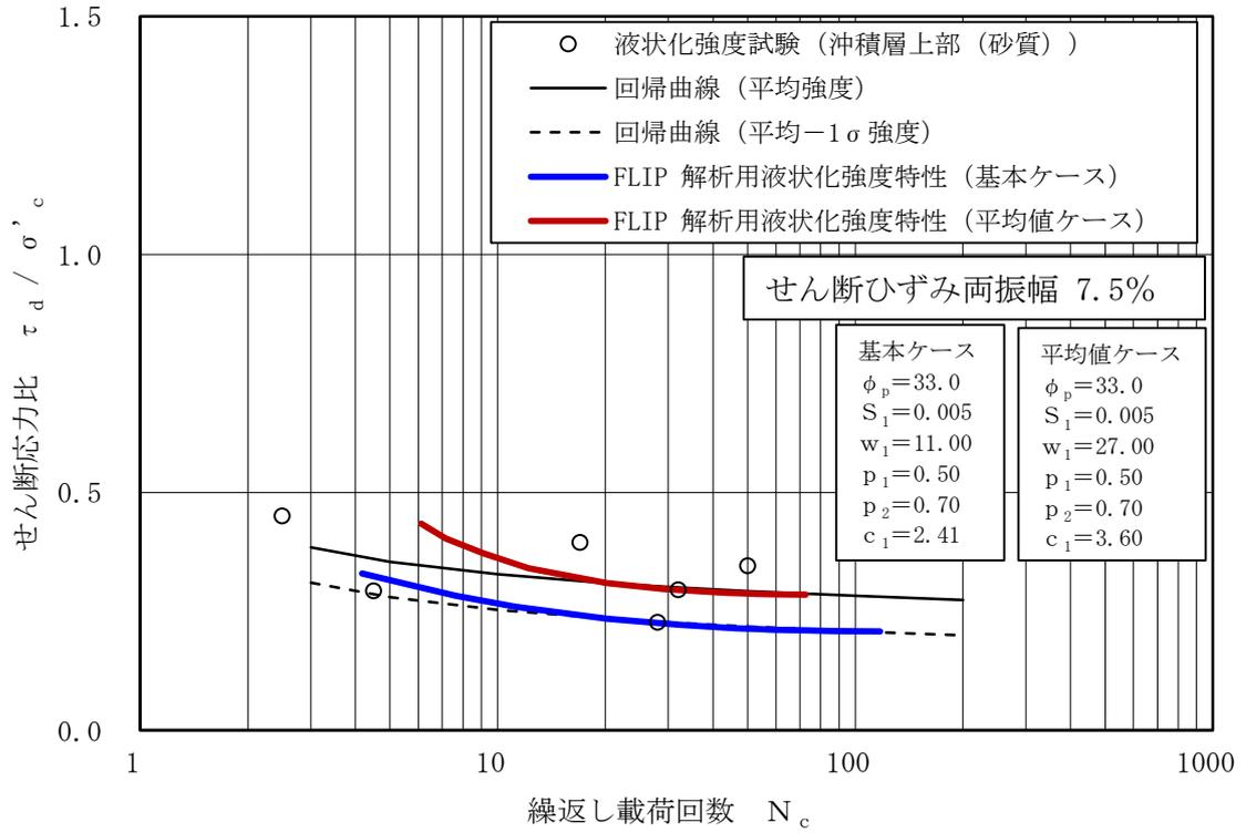
図 3-8 液状化抵抗曲線（沖積層上部（砂質））
