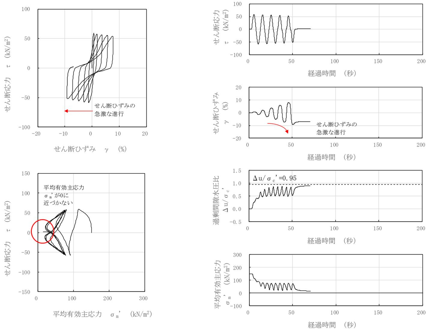
図 3-93 液状化試験結果 (沖積層下部, S0-S1-14-4, GL. -23.47~23.59m, 有効拘束圧 150kN/m<sup>2</sup>, せん断応力比=0.390)
