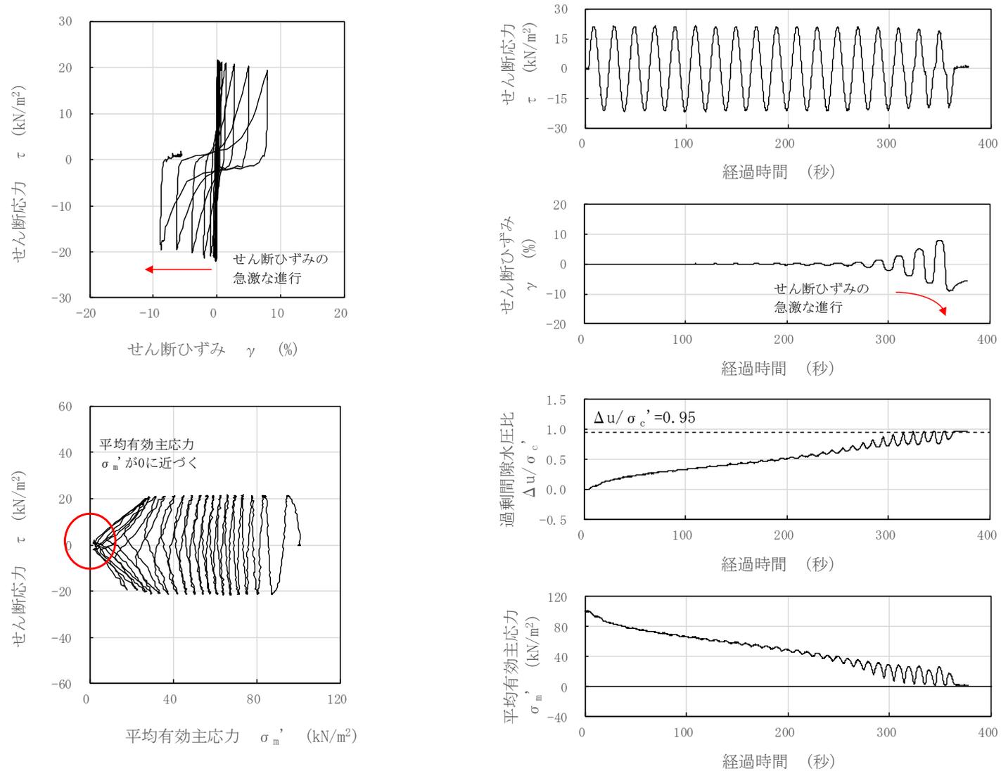
図 3-32 液状化試験結果 (埋戻土, S0-S2-1-7, GL. -3.63~3.75m, 有効拘束圧 100kN/m<sup>2</sup>, せん断応力比=0.213)
