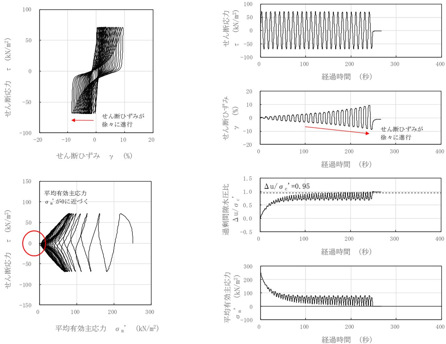
図 3-80 液状化試験結果 (沖積層下部, GTG-S6-②, GL. -15.70~16.65m, 有効拘束圧 250kN/m<sup>2</sup>, せん断応力比=0.280)
