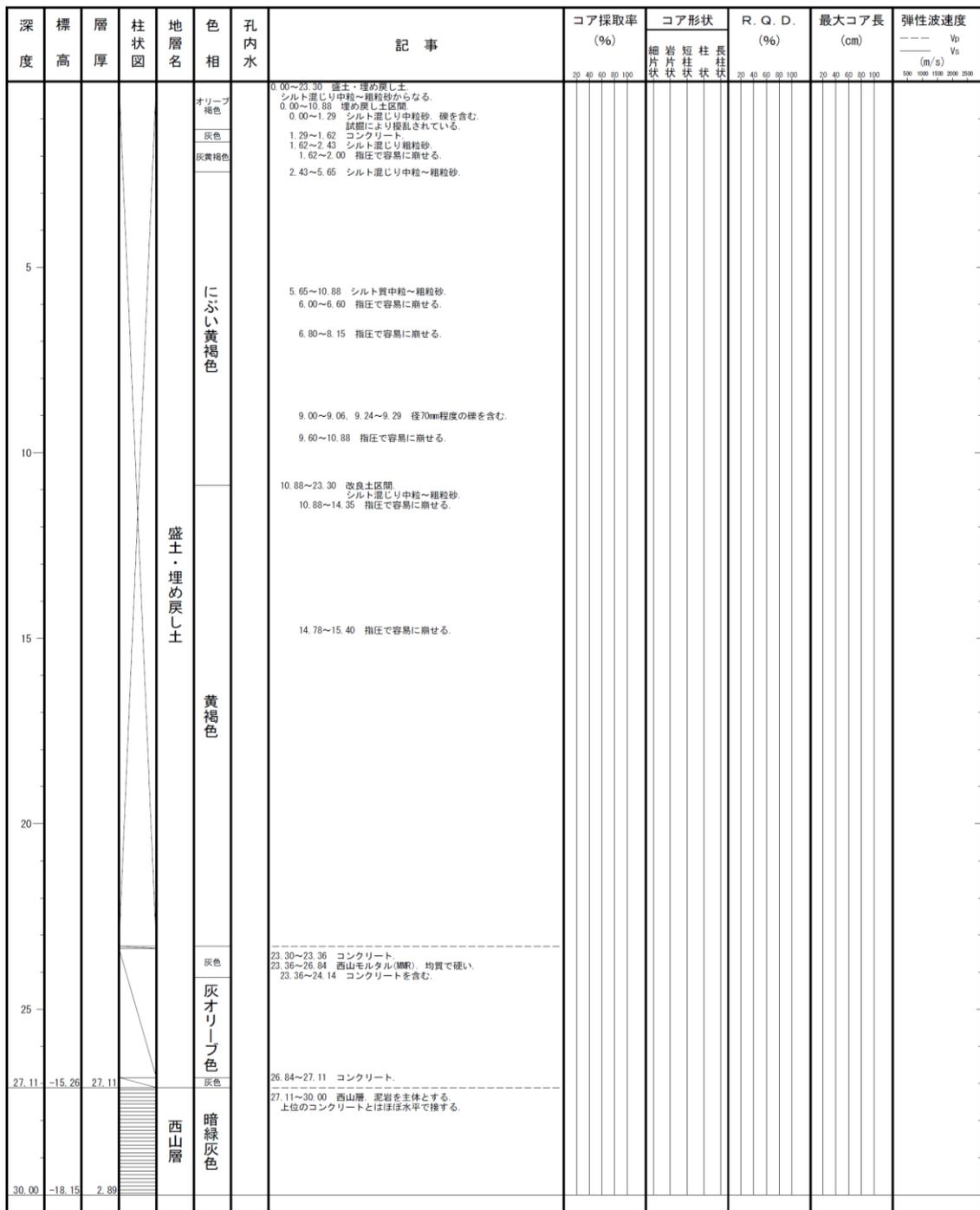
図 2-39 ボーリング柱状図 (改 7-13S)
