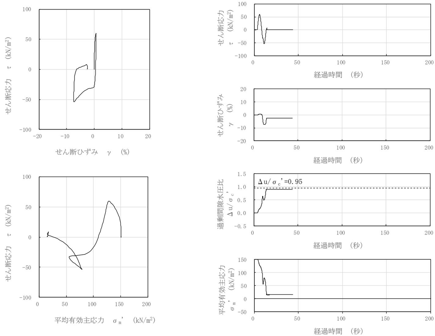
図 3-73 液状化試験結果（沖積層上部（砂質），S0-S1-8-3，GL. -14.30~14.42m，有効拘束圧 150kN/m<sup>2</sup>，せん断応力比=0.378）
