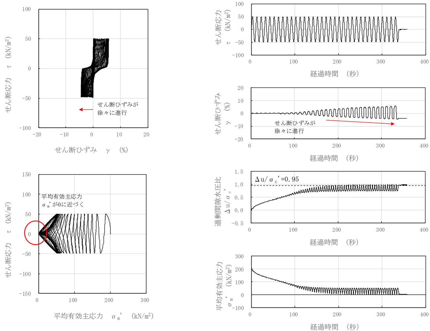
図 3-59 液状化試験結果 (新期砂層, GTG-S4-⑤, GL. -14.22~14.87m, 有効拘束圧 200kN/m<sup>2</sup>, せん断応力比=0.247)
