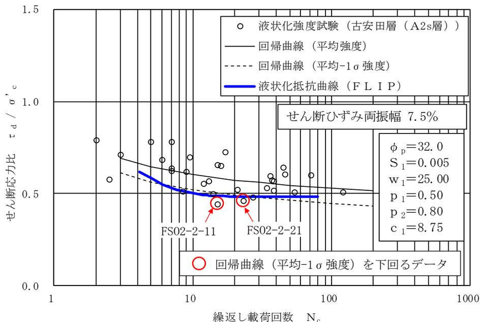
図 2-1 A2s 層の液状化強度試験結果
