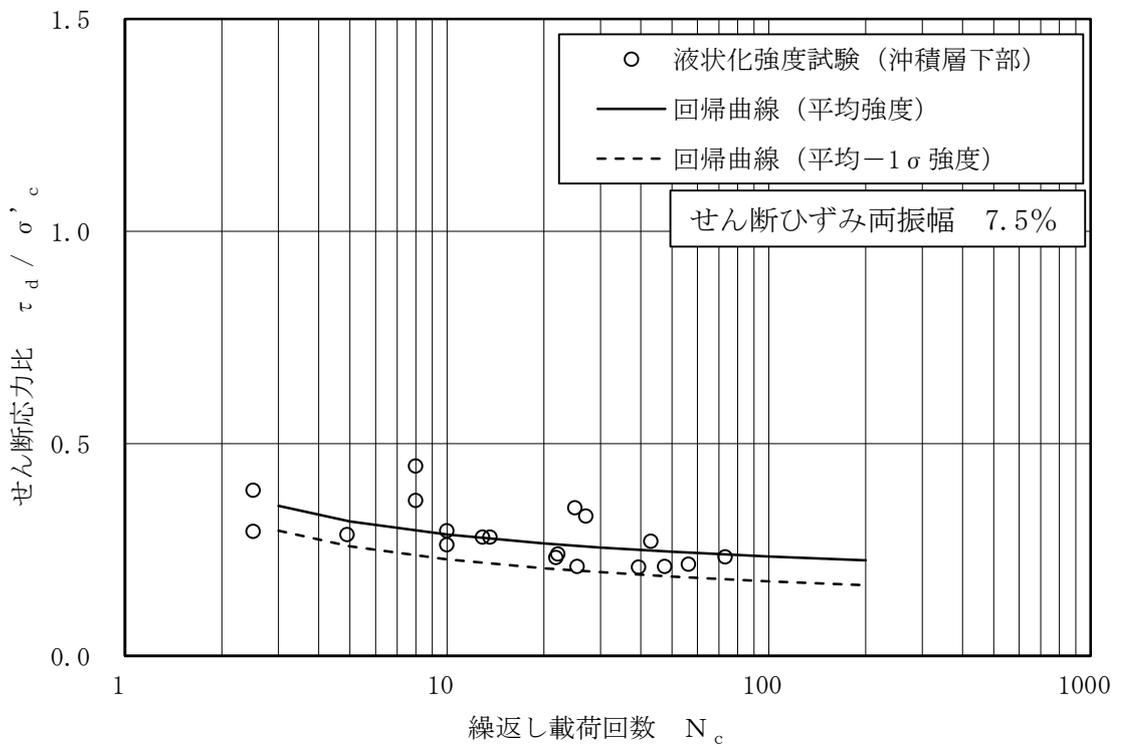
図 3-27 沖積層下部の液状化強度試験結果
