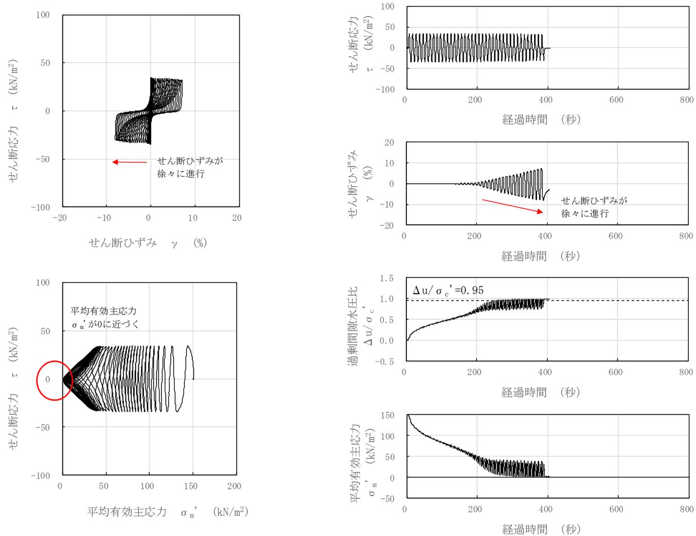
図 3-75 液状化試験結果 (沖積層上部 (砂質), S0-S1-8-6, GL. -14.66~14.78m, 有効拘束圧 150kN/m<sup>2</sup>, せん断応力比=0.227)
