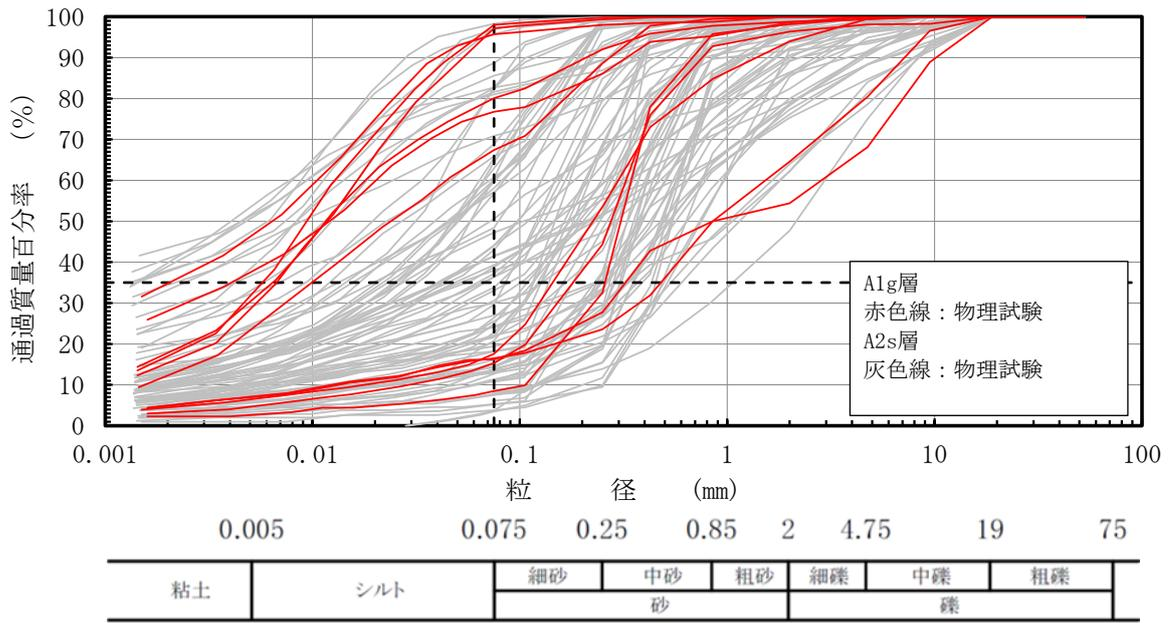
図 3-14 A1g 層と A2s 層の粒径加積曲線
