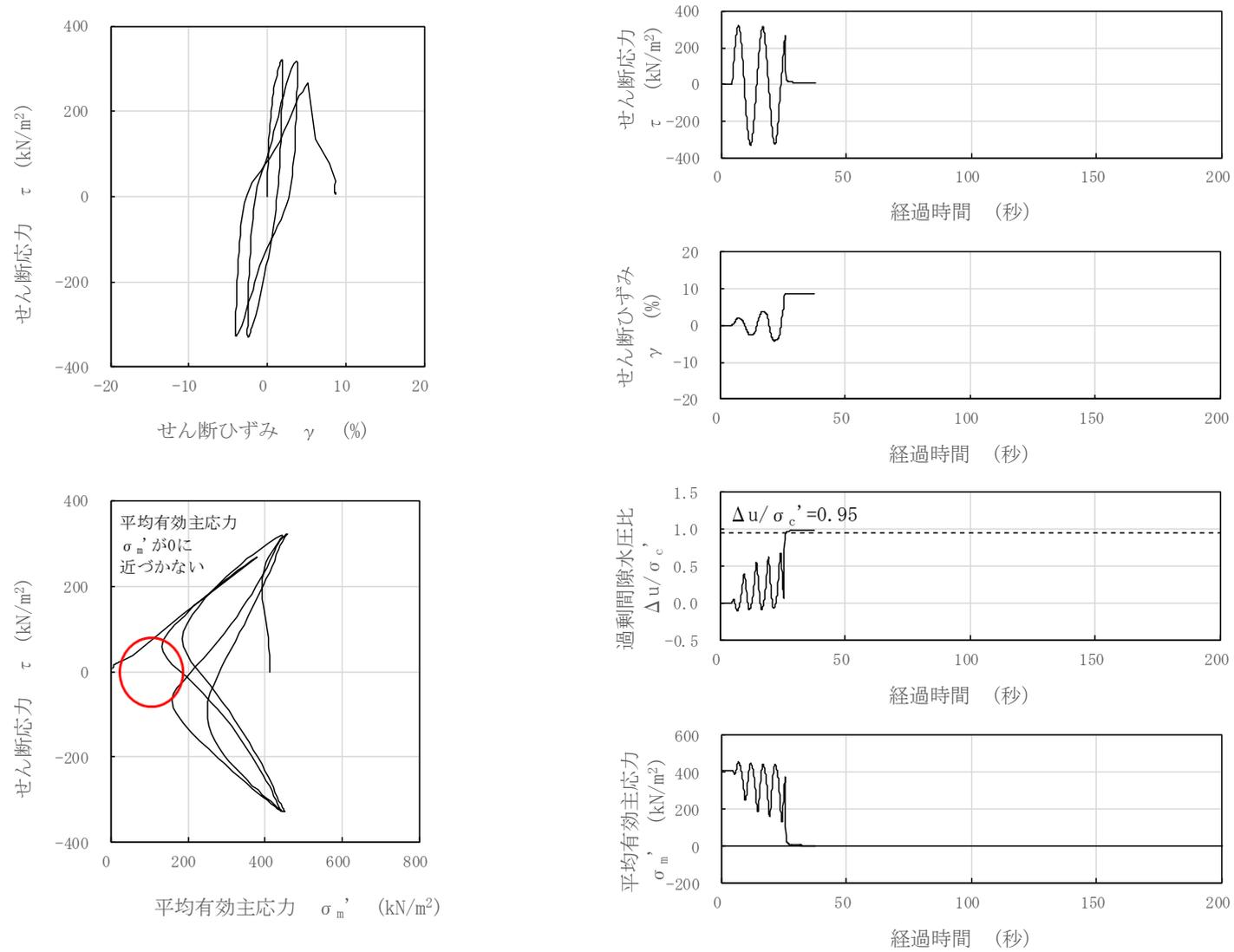
図 3-109 液状化試験結果 (A2s 層, FS-3-9-2, GL. -34.60~34.75m, 有効拘束圧 412kN/m<sup>2</sup>, せん断応力比=0.790)
