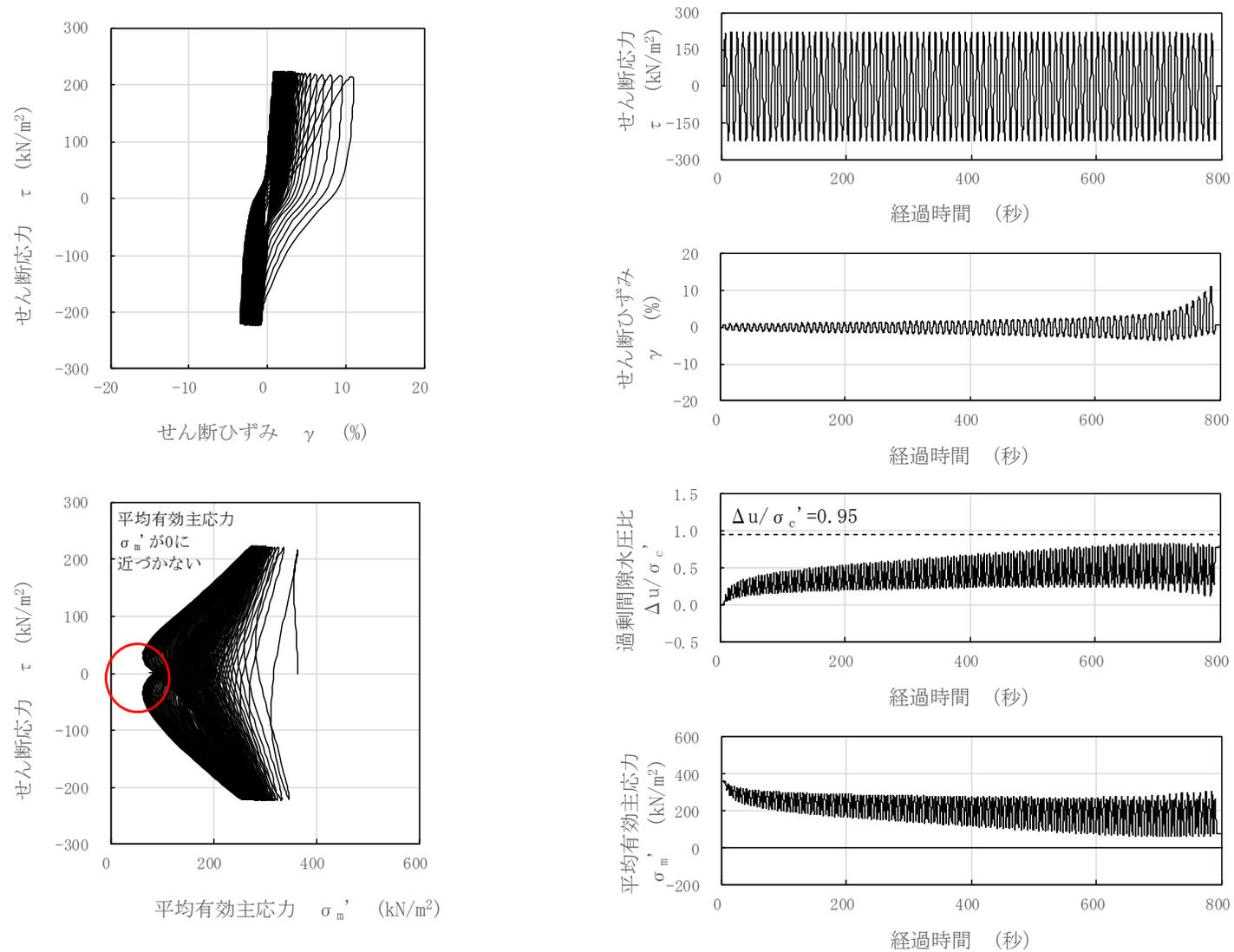
図 3-96 液状化試験結果 (A2s 層, FS-3-2-1, GL. -27.68~27.84m, 有効拘束圧 363kN/m<sup>2</sup>, せん断応力比=0.601)
