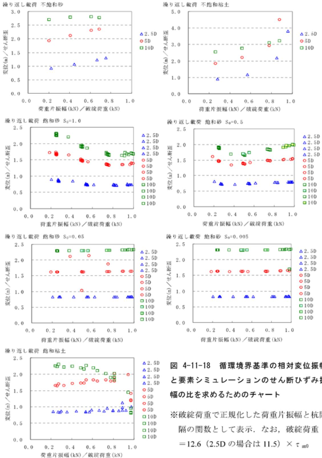
図 4-11-18 循環境界基準の相対変位振幅と要素シミュレーションのせん断ひずみ振幅の比を求めるためのチャート
