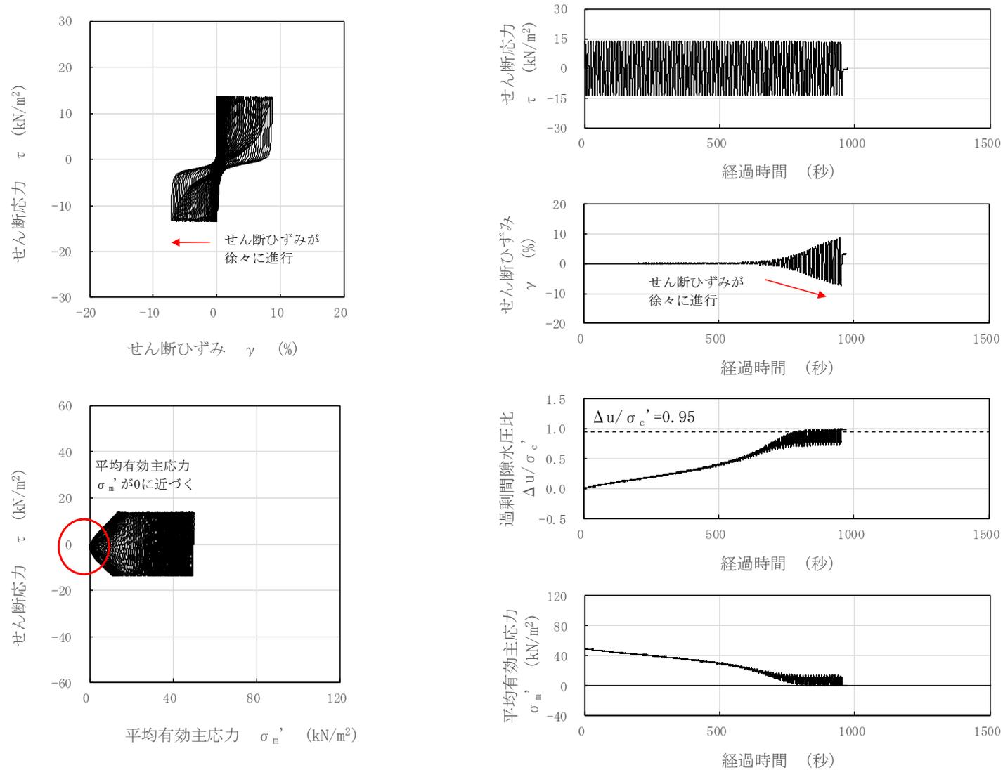
図 3-39 液状化試験結果 (埋戻土, GTG-S2-⑤, GL. -3.22~3.87m, 有効拘束圧 50kN/m<sup>2</sup>, せん断応力比=0.272)
