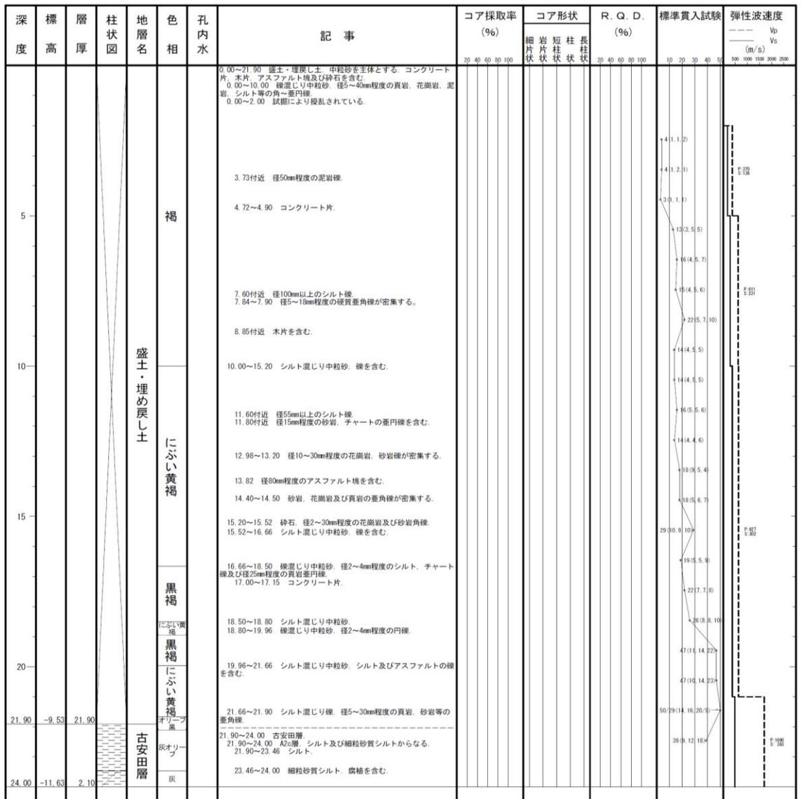
図 2-41 ボーリング柱状図 (SH7-1)
