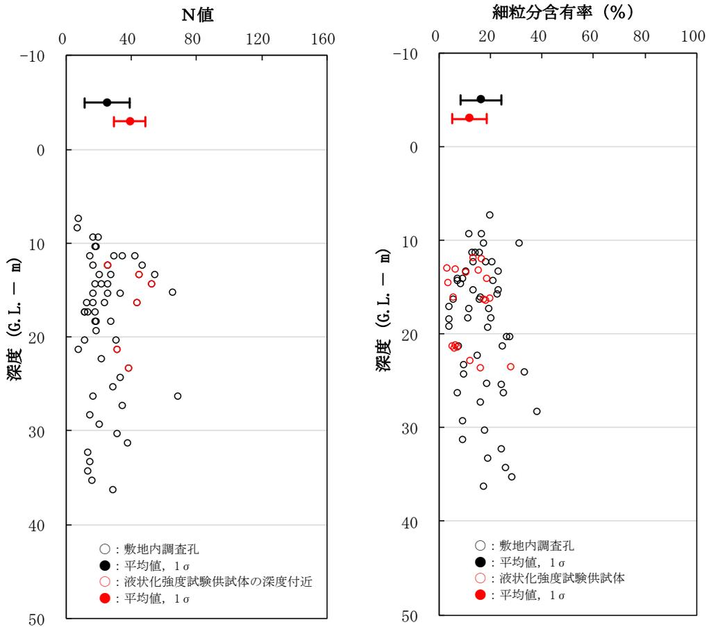
図 4-32 液状化強度試験箇所及び敷地内調査孔のN値，細粒分含有率  $F_c$  の比較
