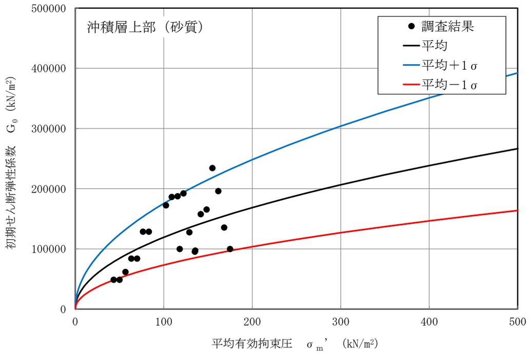
図 2-5  $G_0$  の  $\sigma_m'$  依存式 (沖積層上部 (砂質))
