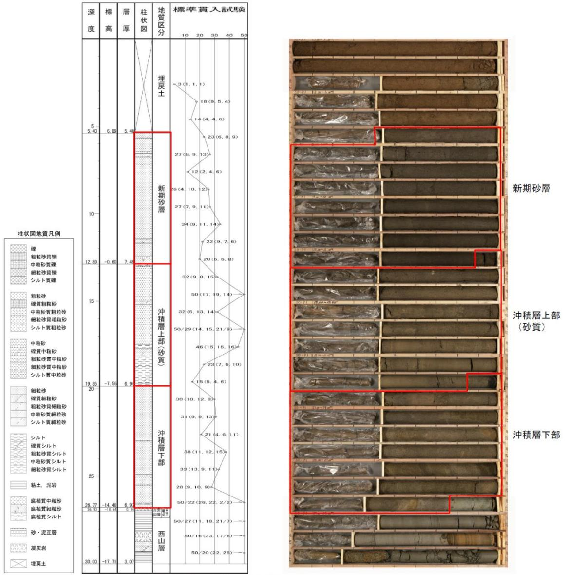
注：図中の赤枠は液状化強度試験の対象地層を示す。
