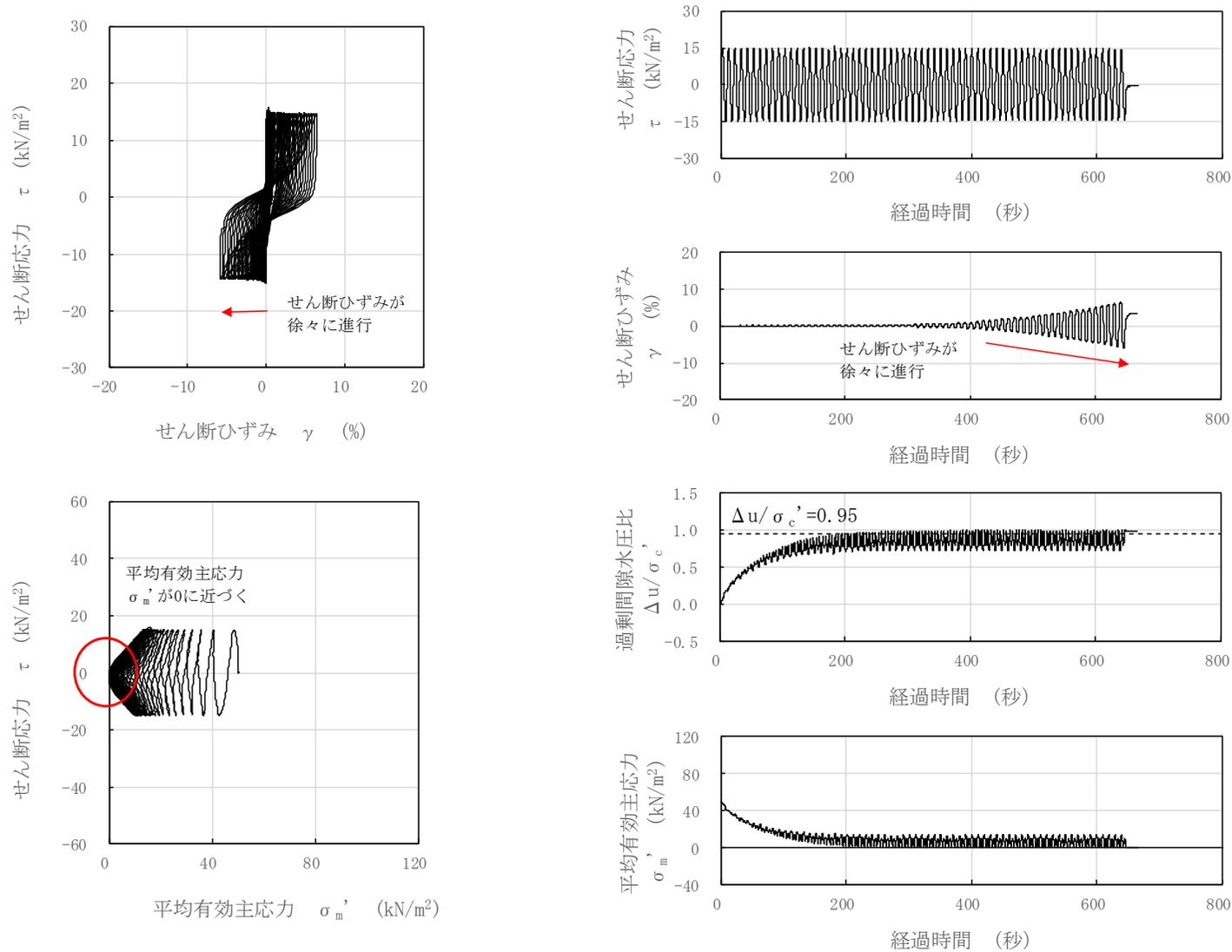
図 3-37 液状化試験結果 (埋戻土, GTG-S2-②, GL. -3.22~3.87m, 有効拘束圧 50kN/m<sup>2</sup>, せん断応力比=0.299)
