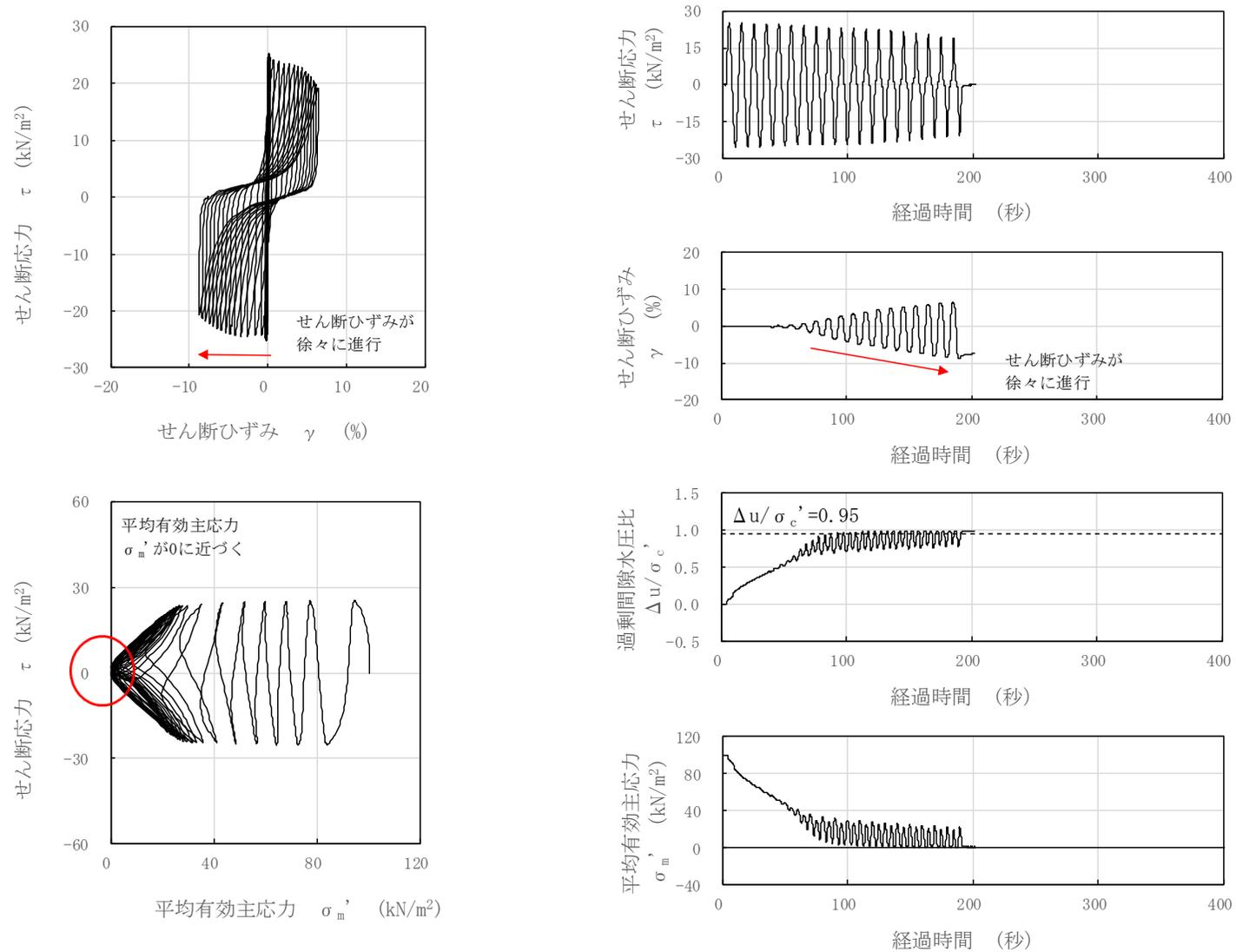
図 3-66 液状化試験結果 (新期砂層, S0-S1-2-4, GL. -7.92~8.04m, 有効拘束圧 100kN/m<sup>2</sup>, せん断応力比=0.249)
