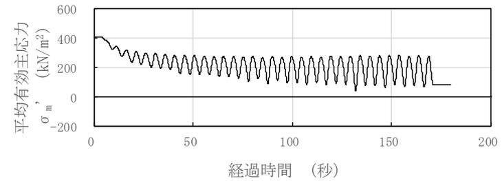
図 3-123 液状化試験結果 (A2s 層, FS02-2-16, GL. -24.30~24.45m, 有効拘束圧 412kN/m<sup>2</sup>, せん断応力比=0.555)
