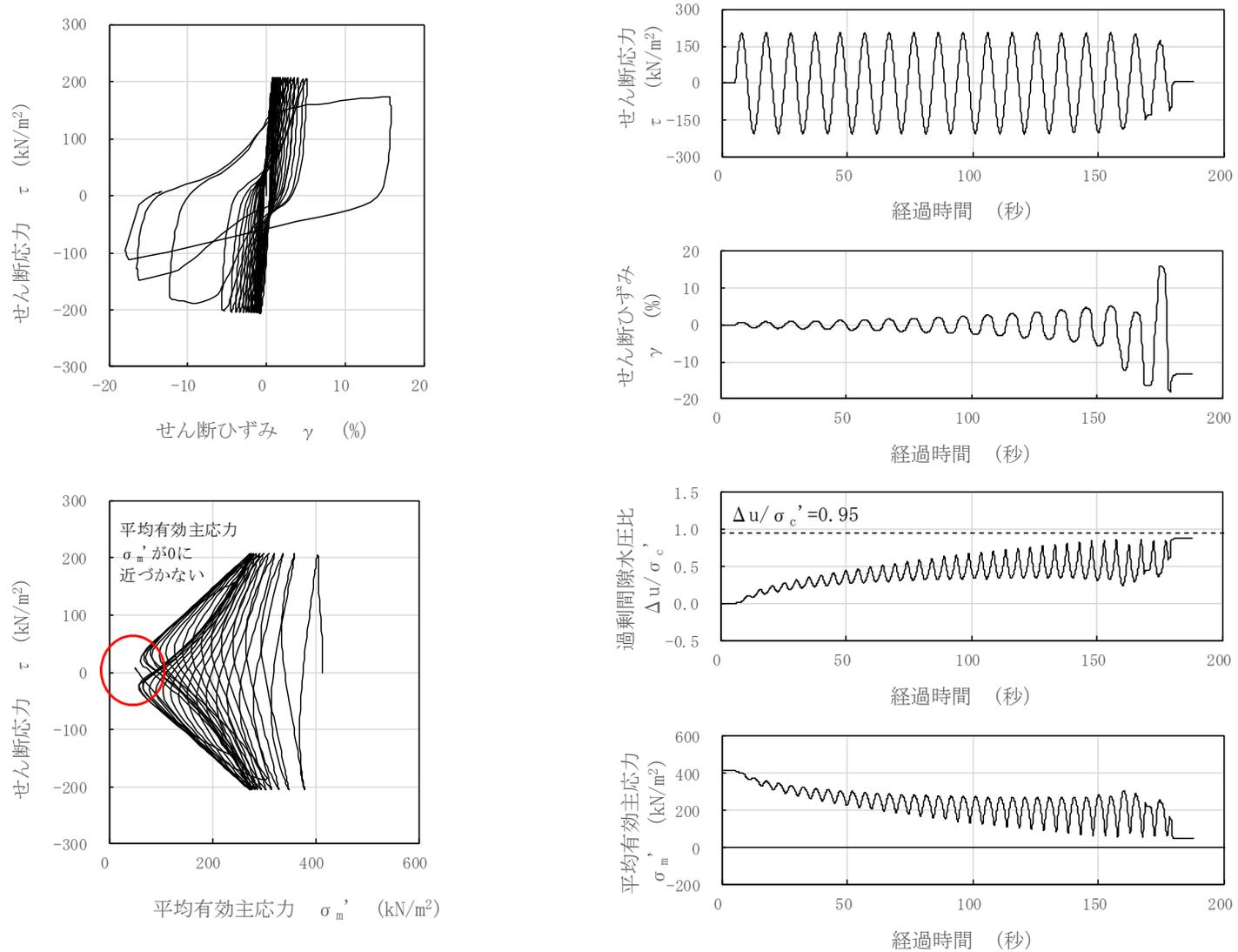
図 2-5 液状化試験結果 (A2s 層, FS02-2-8, GL. -22.70~22.85m, 有効拘束圧 412kN/m<sup>2</sup>, せん断応力比=0.499)
