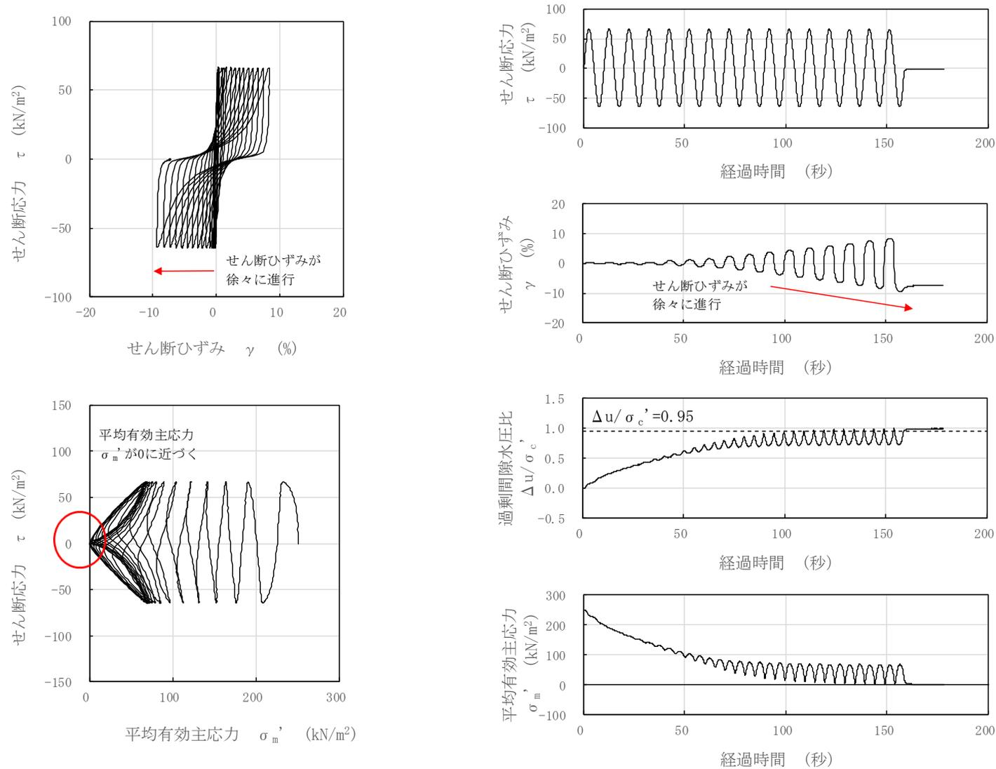
図 3-83 液状化試験結果 (沖積層下部, GTG-S6-⑤, GL. -15.70~16.65m, 有効拘束圧 250kN/m<sup>2</sup>, せん断応力比=0.262)
