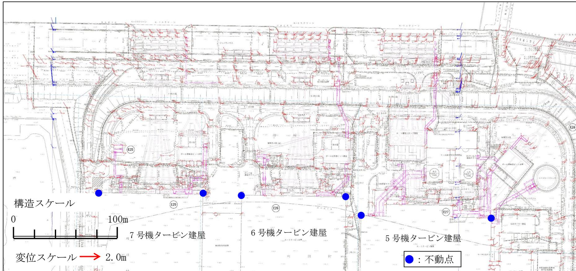
注1\* : 変位量は、「2006年4月撮影」と「2007年10月撮影」の航空写真測量結果の差分から算定している。
