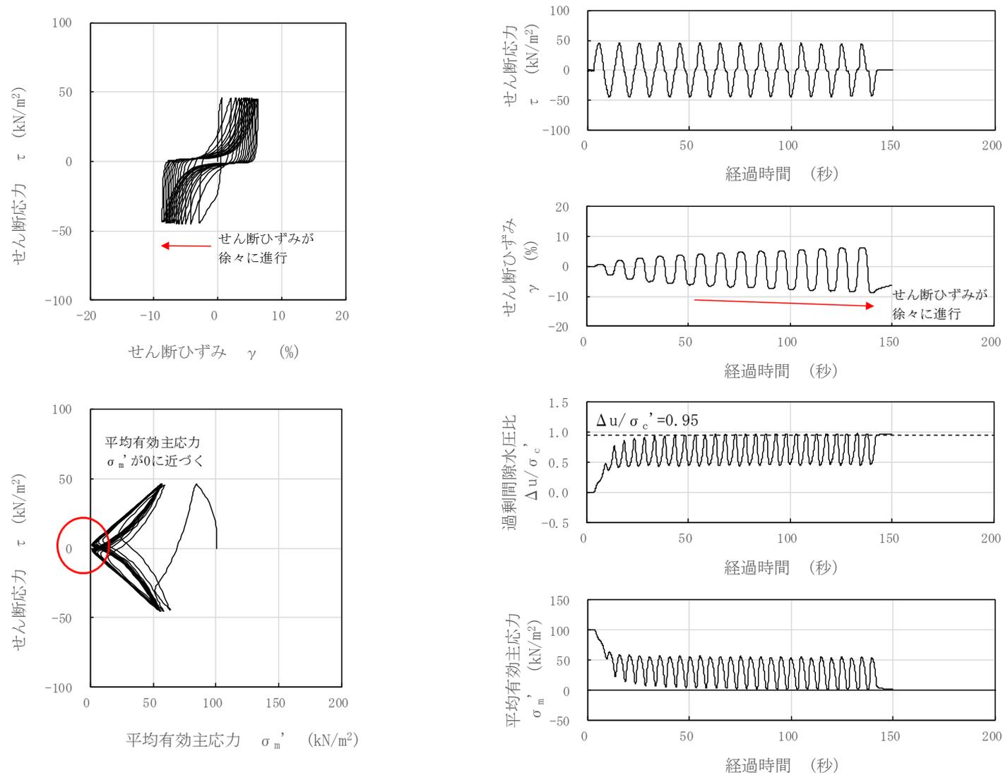
図 3-72 液状化試験結果 (沖積層上部 (砂質), S0-S1-7-4, GL. -13.47~13.59m, 有効拘束圧 100kN/m<sup>2</sup>, せん断応力比=0.450)
