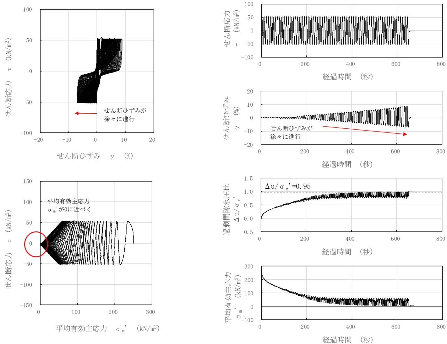
図 3-79 液状化試験結果 (沖積層下部, GTG-S6-⑦, GL. -11.70~14.70m, 有効拘束圧 250kN/m<sup>2</sup>, せん断応力比=0.209)
