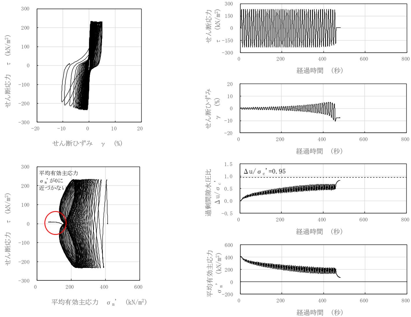
図 3-124 液状化試験結果 (A2s 層, FS02-3-9, GL. -23.73~23.88m, 有効拘束圧 412kN/m<sup>2</sup>, せん断応力比=0.567)
