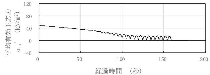
図 3-45 液状化試験結果 (埋戻土, GTG-S4-②, GL. -10.35~10.87m, 有効拘束圧 50kN/m<sup>2</sup>, せん断応力比=0.310)
