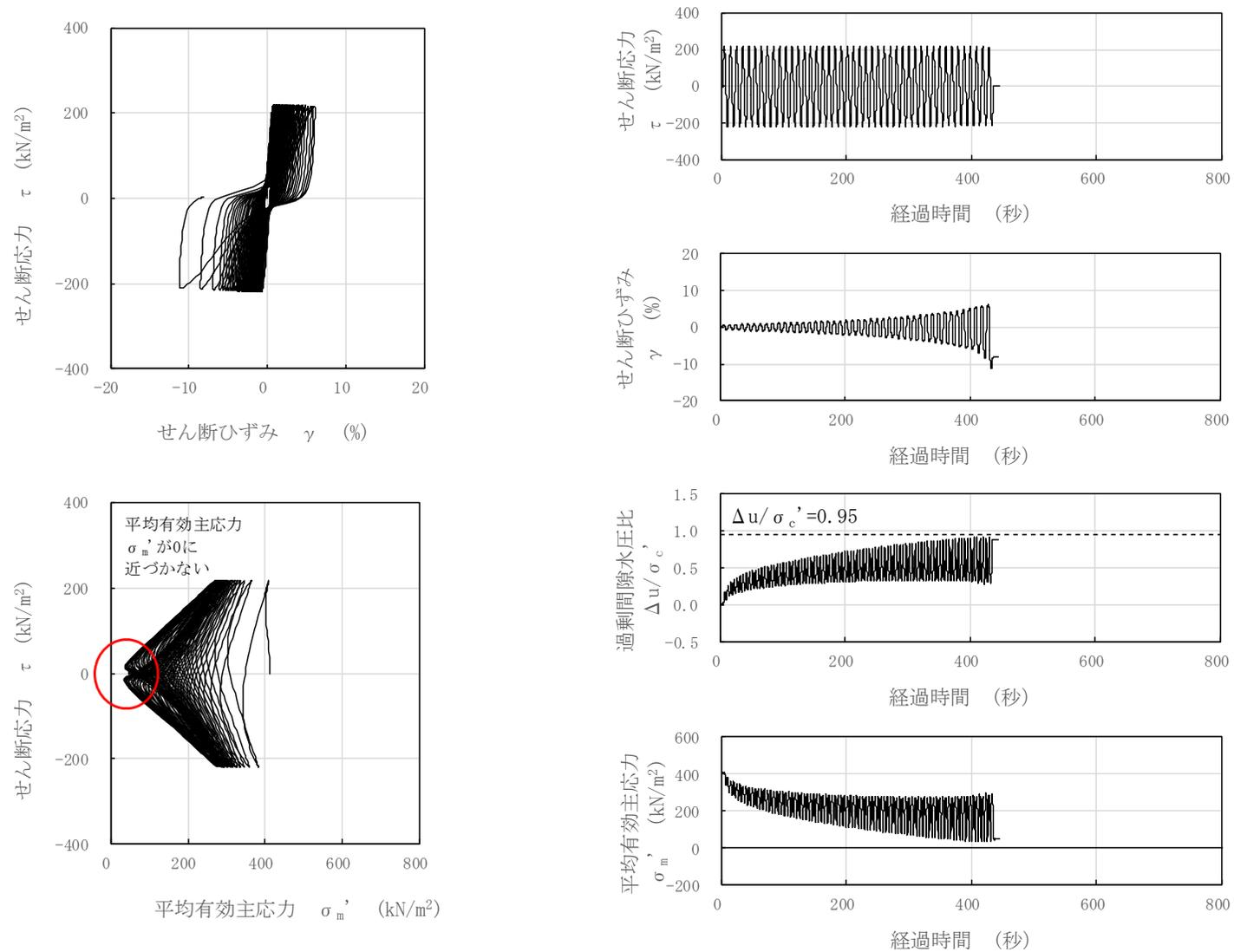
図 3-112 液状化試験結果 (A2s 層, FS-4-8-3, GL. -33.10~33.25m, 有効拘束圧 412kN/m<sup>2</sup>, せん断応力比=0.530)
