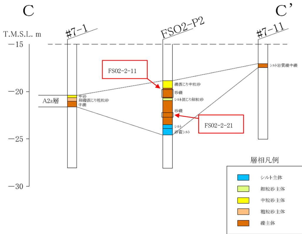
図 2-14 ボーリング柱状図 (C-C' 断面)
