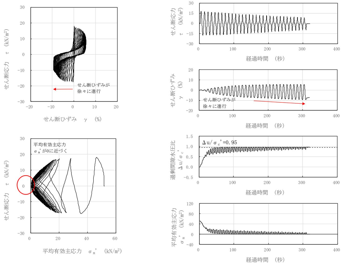
図 3-63 液状化試験結果 (新期砂層, S0-S1-1-3, GL. -6.85~6.97m, 有効拘束圧 50kN/m<sup>2</sup>, せん断応力比=0.339)
