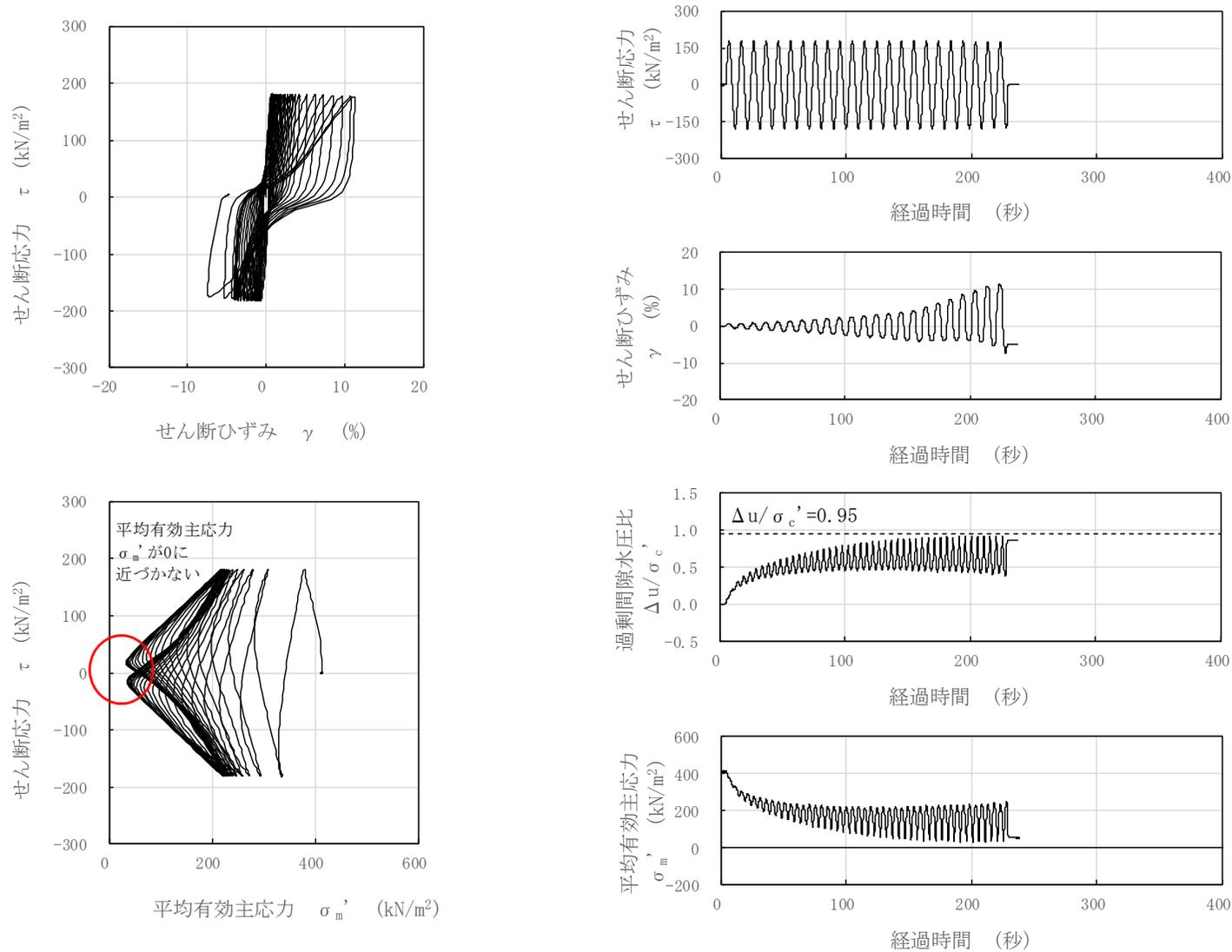
図 3-118 液状化試験結果 (A2s 層, FS02-2-11, GL. -23.15~23.30m, 有効拘束圧 412kN/m<sup>2</sup>, せん断応力比=0.440)
