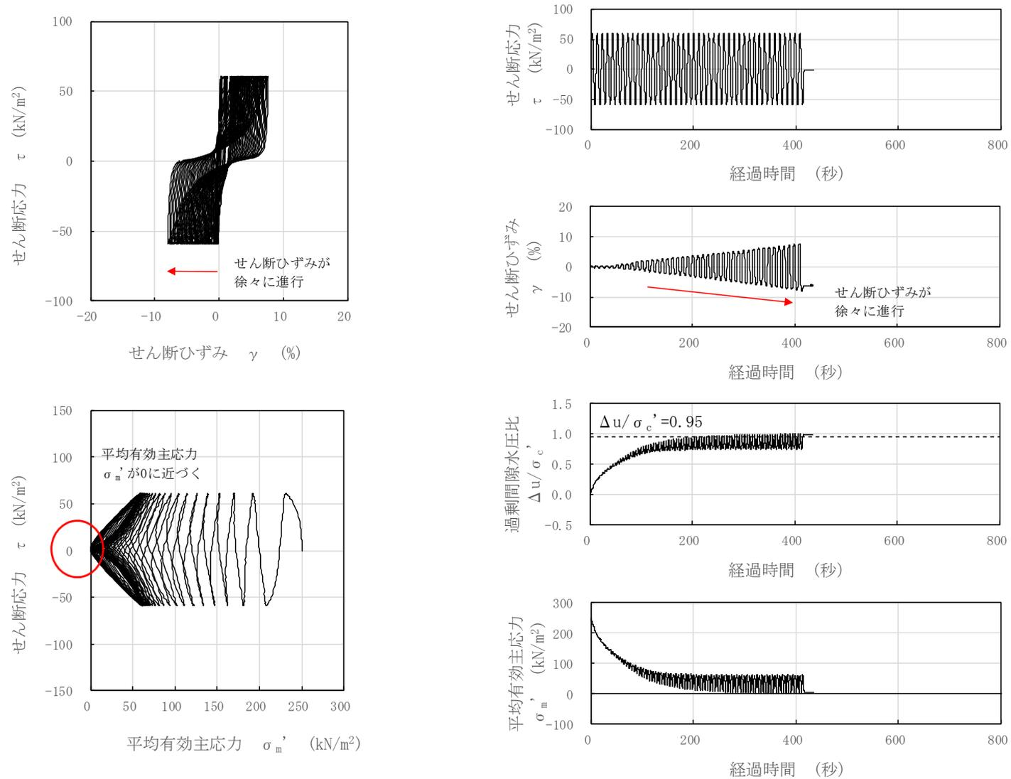
図 3-85 液状化試験結果 (沖積層下部, GTG-S6'-④, GL. -12.70~13.70m, 有効拘束圧 250kN/m<sup>2</sup>, せん断応力比=0.240)
