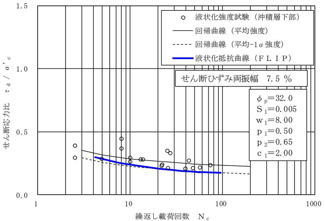
図 4-49 液状化抵抗曲線 (沖積層下部)
