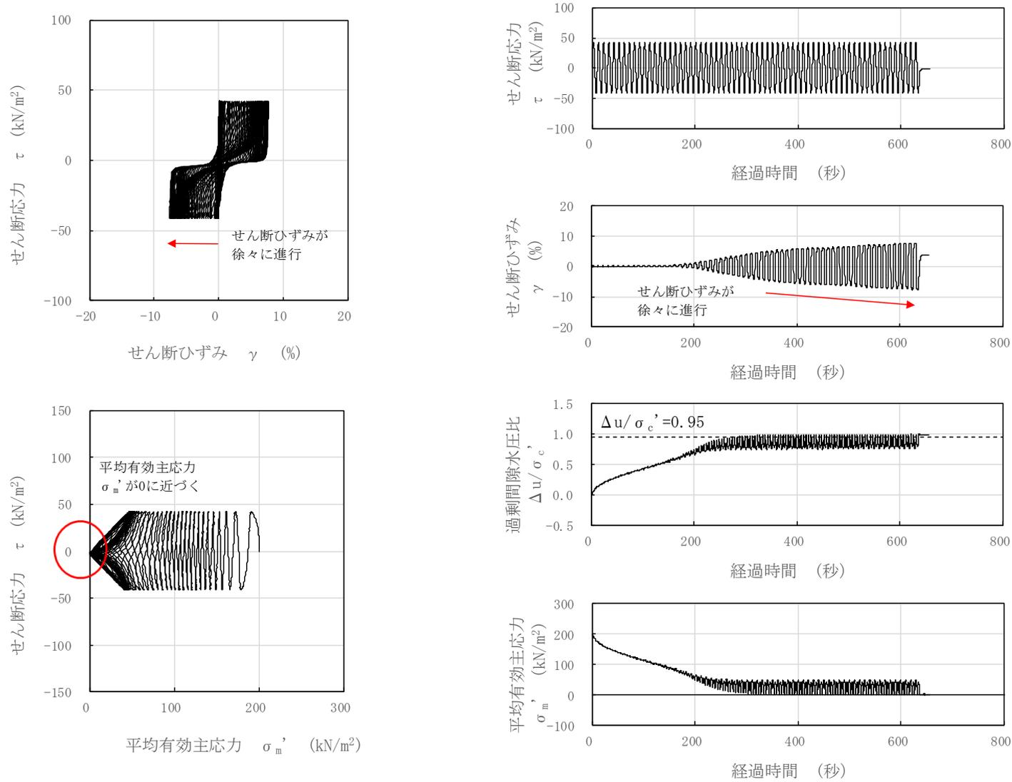
図 3-55 液状化試験結果 (新期砂層, GTG-S3-④, GL. -10.85~11.37m, 有効拘束圧 200kN/m<sup>2</sup>, せん断応力比=0.208)
