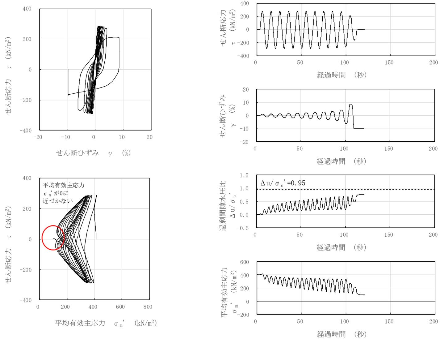
図 3-113 液状化試験結果 (A2s 層, FS-4-8-4, GL. -33.25~33.40m, 有効拘束圧 412kN/m<sup>2</sup>, せん断応力比=0.696)
