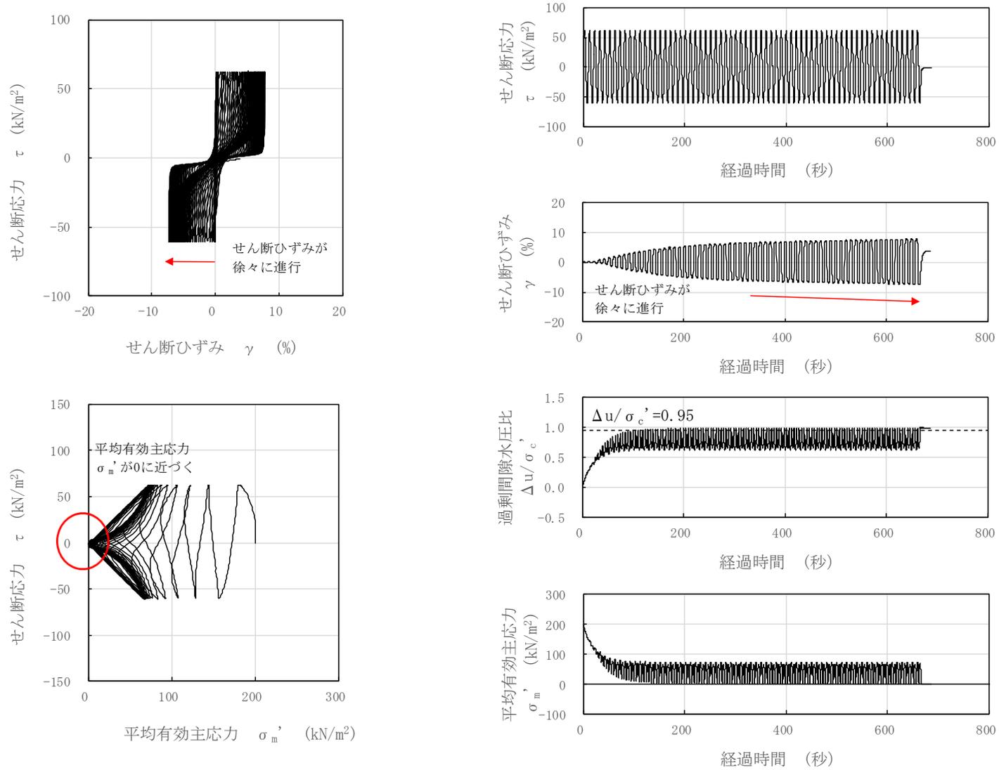
図 3-53 液状化試験結果 (新期砂層, GTG-S3-②, GL. -10.85~11.37m, 有効拘束圧 200kN/m<sup>2</sup>, せん断応力比=0.307)
