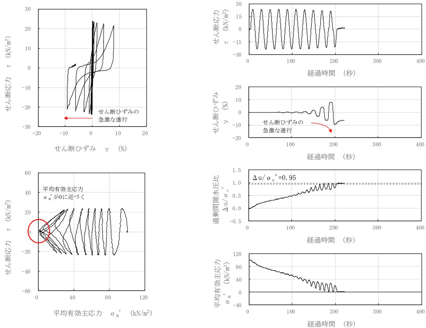
図 3-31 液状化試験結果 (埋戻土, S0-S2-1-6, GL. -3.51~3.63m, 有効拘束圧 100kN/m<sup>2</sup>, せん断応力比=0.237)
