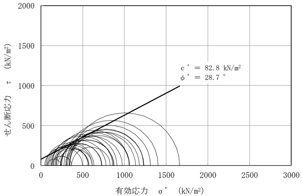
図 3-22 A2a1 層の三軸圧縮試験結果及び強度定数
