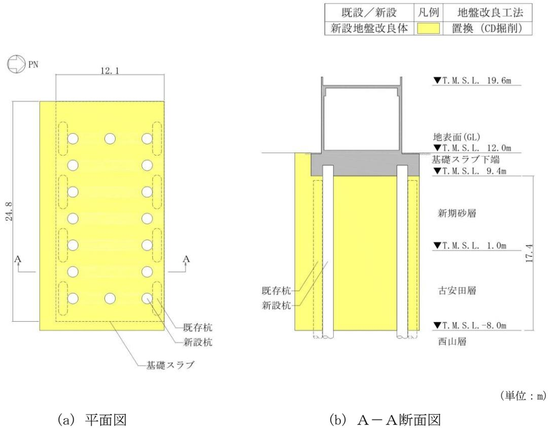
図 2-2 地盤改良体の配置図 (大物搬入建屋)
