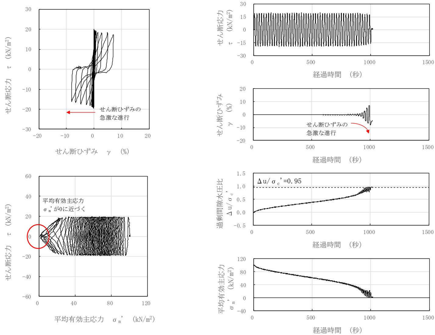
図 3-30 液状化試験結果 (埋戻土, S0-S2-1-5, GL. -3.39~3.51m, 有効拘束圧 100kN/m<sup>2</sup>, せん断応力比=0.191)
