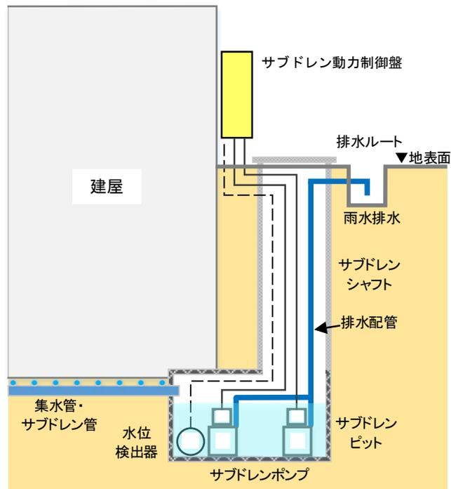
図 3-3 地下水排水設備の設備概要
