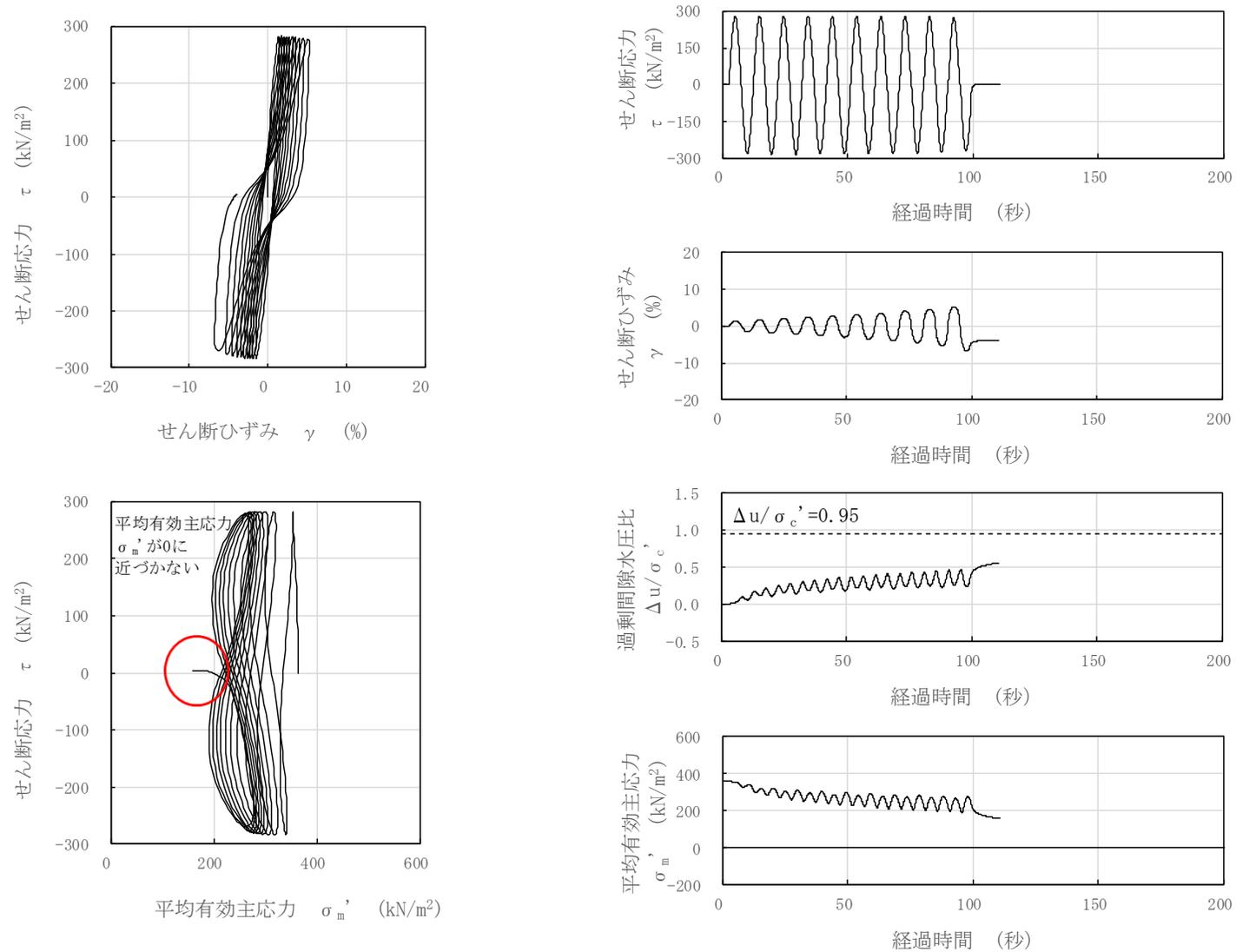
図 3-101 液状化試験結果 (A2s 層, FS-4-1-4, GL. -27.29~27.46m, 有効拘束圧 363kN/m<sup>2</sup>, せん断応力比=0.779)
