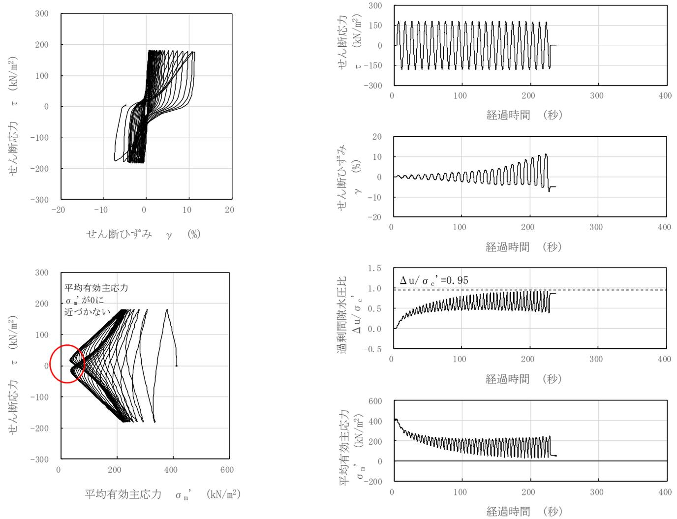
図 2-6 液状化試験結果 (A2s 層, FS02-2-11, GL. -23.15~23.30m, 有効拘束圧 412kN/m<sup>2</sup>, せん断応力比=0.440)
