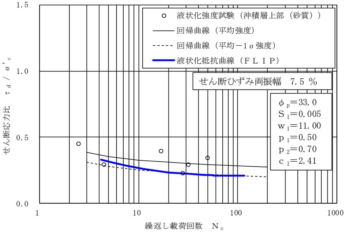
図 4-48 液状化抵抗曲線 (沖積層上部 (砂質))
