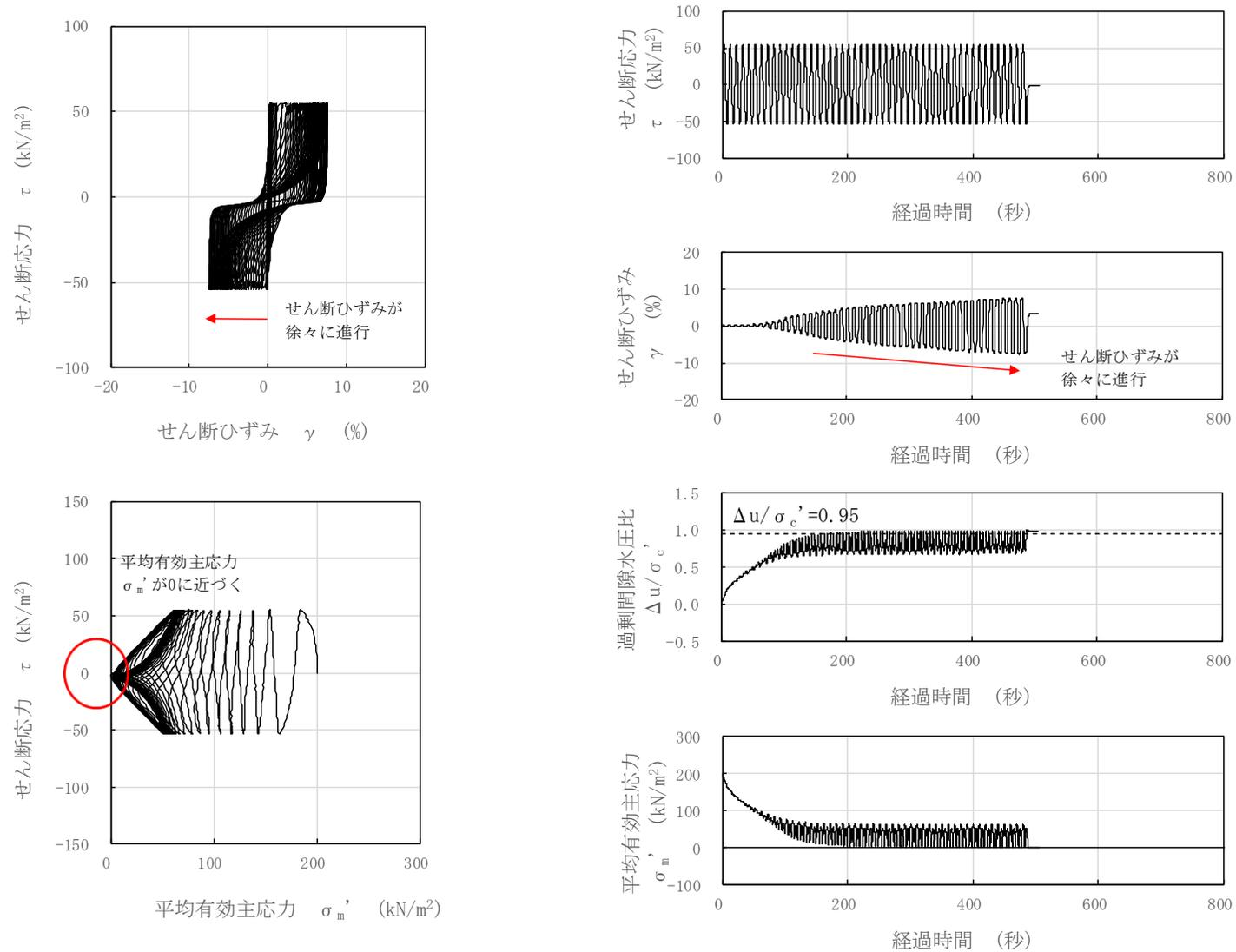
図 3-54 液状化試験結果 (新期砂層, GTG-S3-③, GL. -10.85~11.37m, 有効拘束圧 200kN/m<sup>2</sup>, せん断応力比=0.271)
