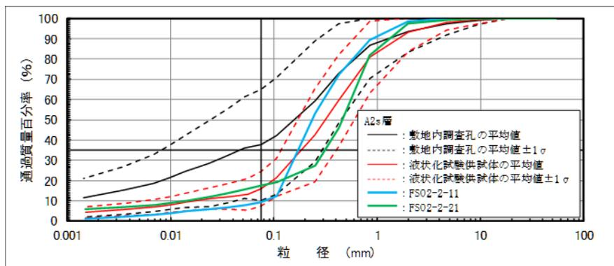
(b) A2s 層 (液状化強度試験供試体)
