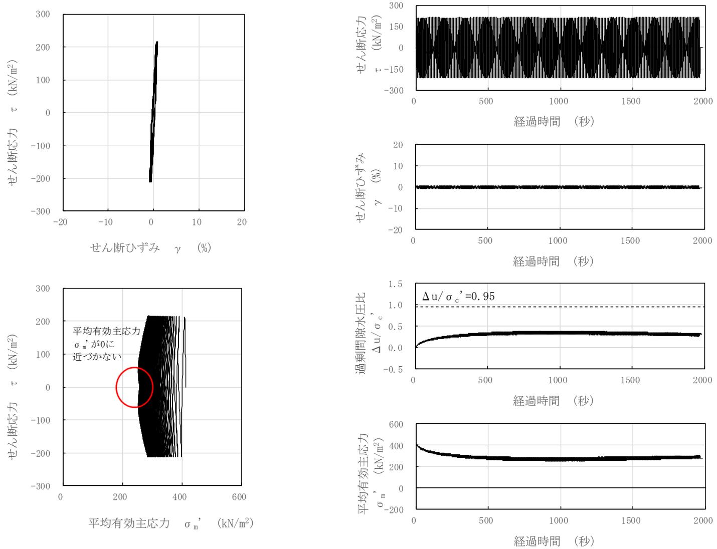
図 3-120 液状化試験結果 (A2s 層, FS02-2-13, GL. -23.78~23.93m, 有効拘束圧 412kN/m<sup>2</sup>, せん断応力比=0.517)
