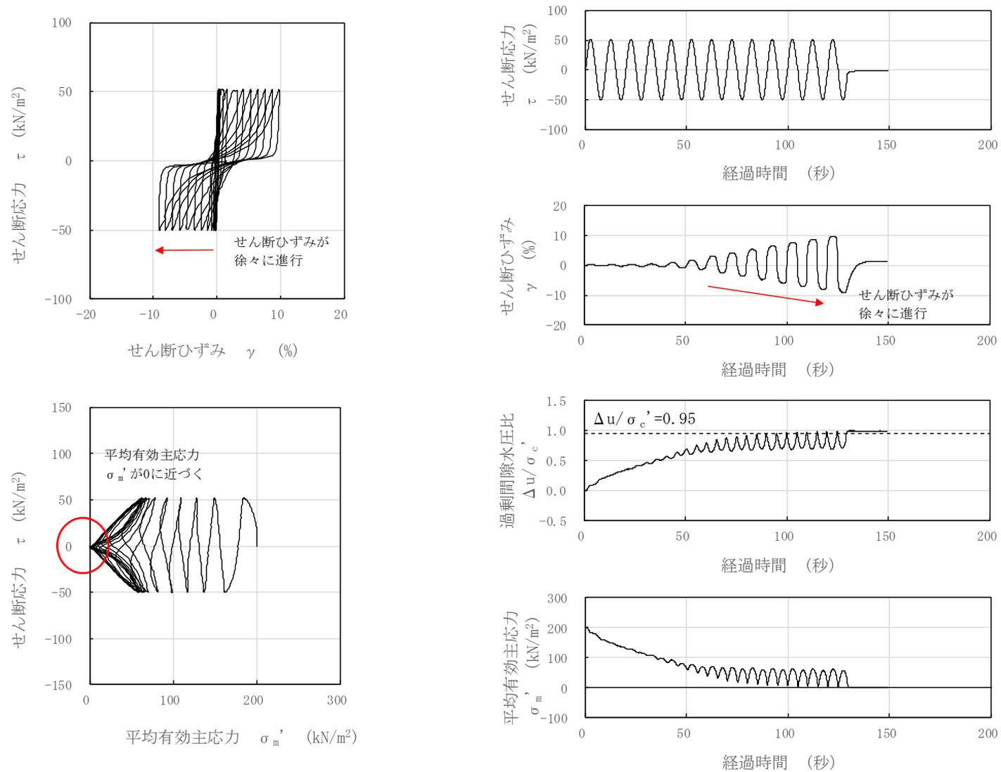
図 3-52 液状化試験結果 (新期砂層, GTG-S3-⑥, GL. -6.72~7.24m, 有効拘束圧 200kN/m<sup>2</sup>, せん断応力比=0.255)
