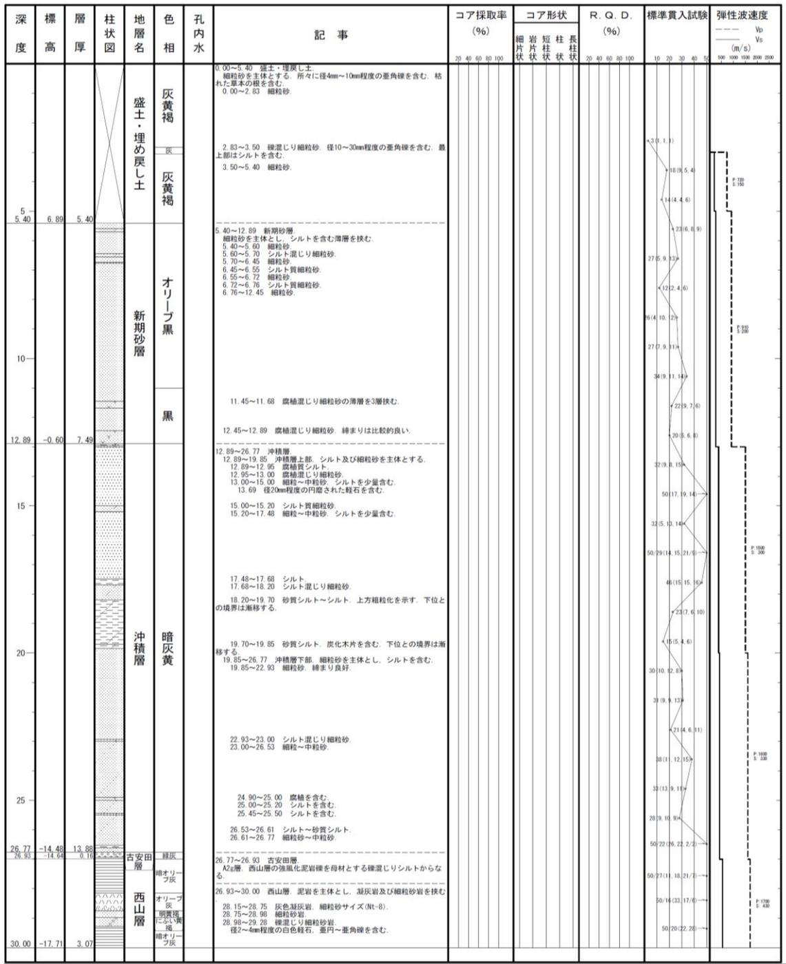
図 2-42 ボーリング柱状図 (S0-P1)
