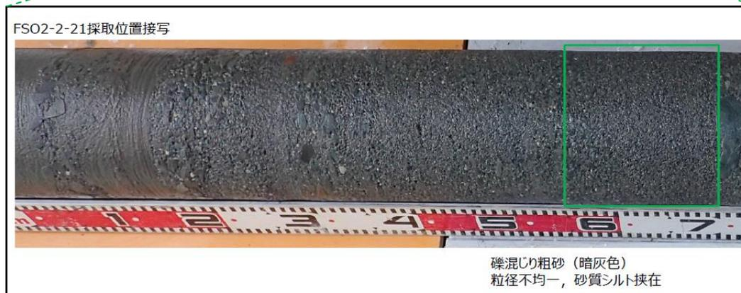
図 2-5 凍結サンプリング写真及び観察スケッチ (供試体番号 : FS02-2-21)
