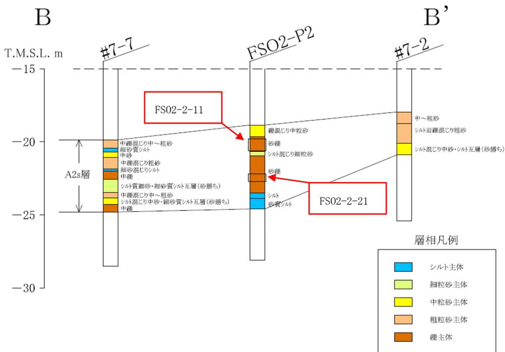
図 2-13 ボーリング柱状図 (B-B' 断面)
