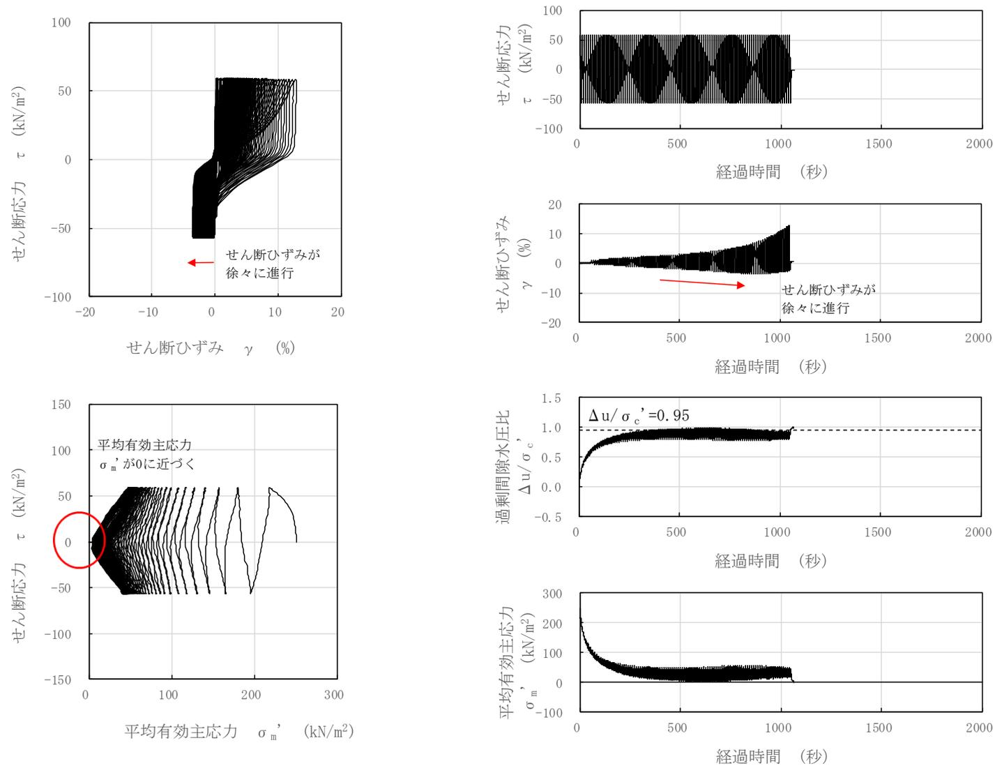
図 3-82 液状化試験結果 (沖積層下部, GTG-S6-④, GL. -15.70~16.65m, 有効拘束圧 250kN/m<sup>2</sup>, せん断応力比=0.233)
