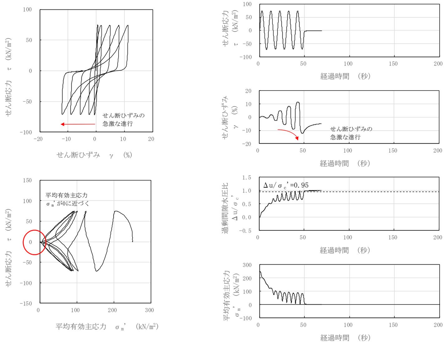
図 3-86 液状化試験結果 (沖積層下部, GTG-S6'-⑤, GL. -12.70~13.70m, 有効拘束圧 250kN/m<sup>2</sup>, せん断応力比=0.293)
