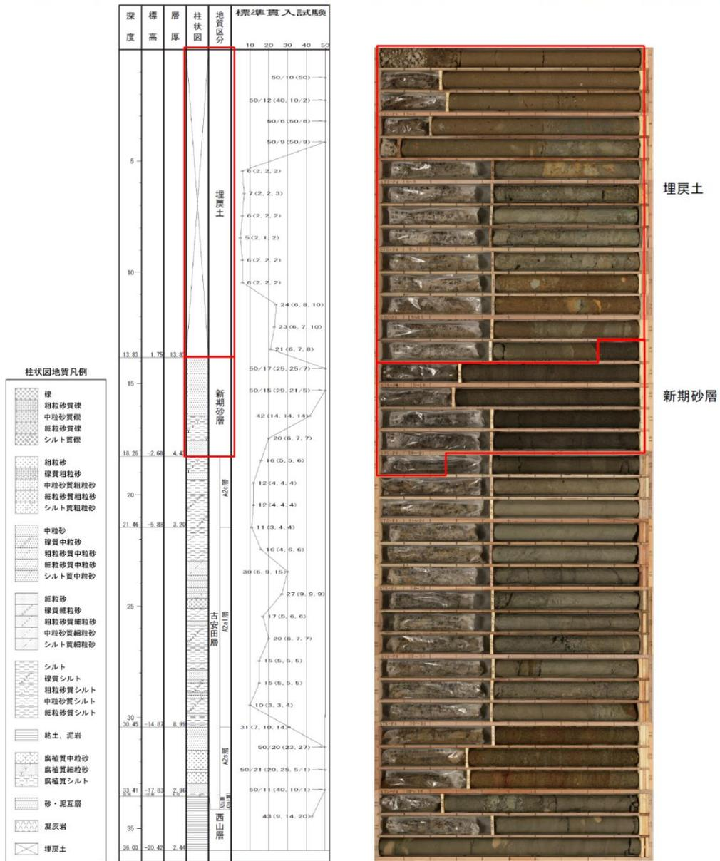
注 : 図中の赤枠は液状化強度試験の対象地層を示す。
