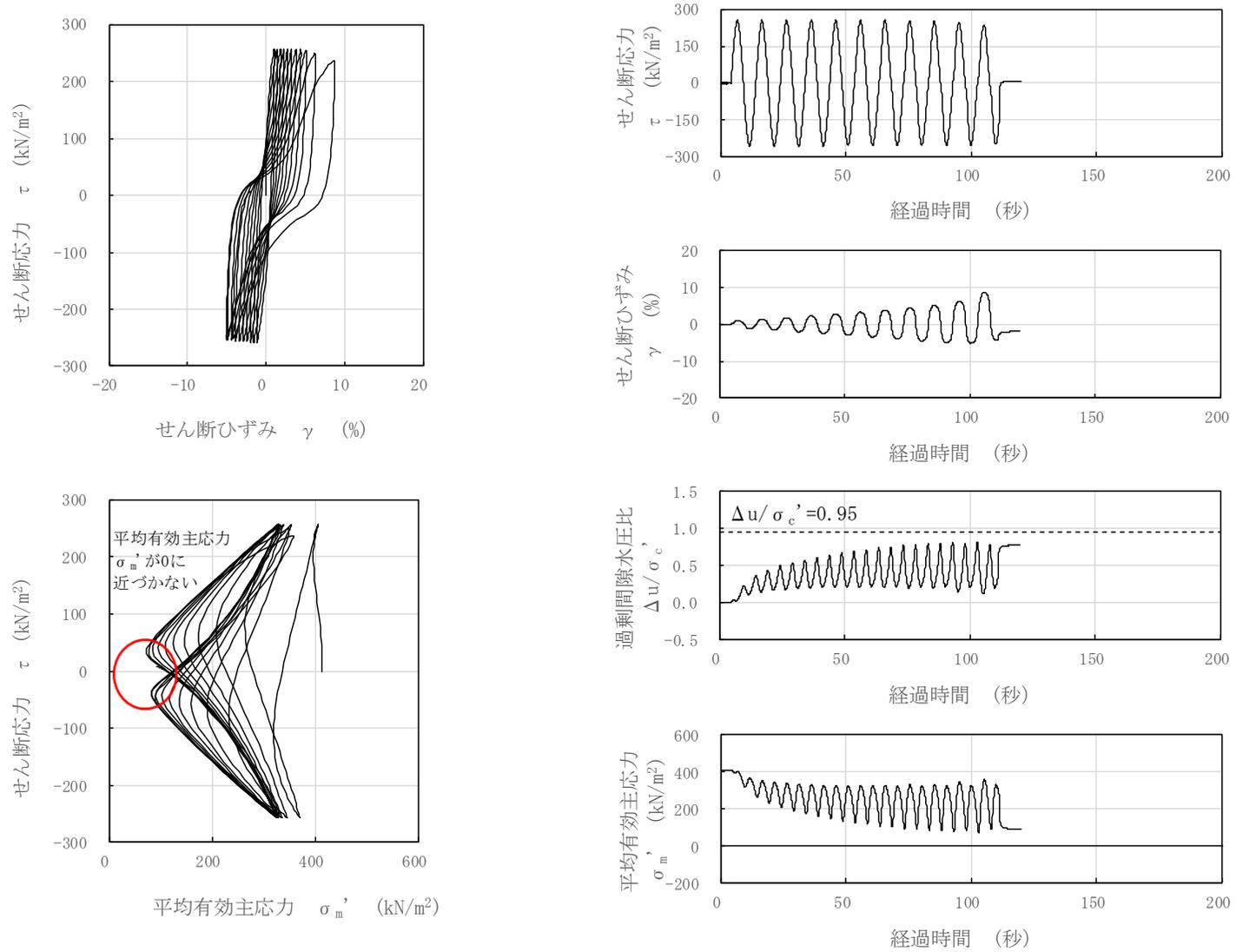
図 3-122 液状化試験結果 (A2s 層, FS02-2-15, GL. -24.15~24.30m, 有効拘束圧 412kN/m<sup>2</sup>, せん断応力比=0.625)
