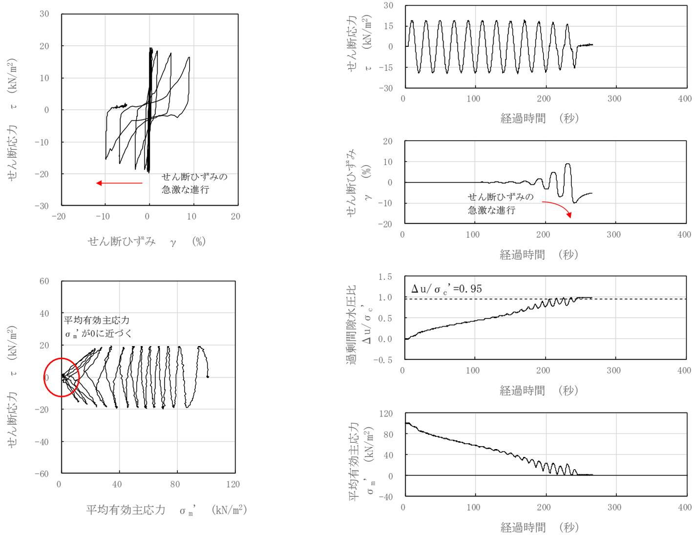
図 3-33 液状化試験結果 (埋戻土, S0-S2-3-4, GL. -5.27~5.39m, 有効拘束圧 100kN/m<sup>2</sup>, せん断応力比=0.190)
