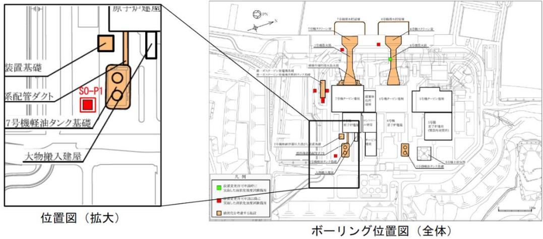
孔名：S0-P1 孔口標高：T.M.S.L. 12.29m 掘進長：L=30.0m (設置変更許可申請以降の液状化強度試験箇所)
