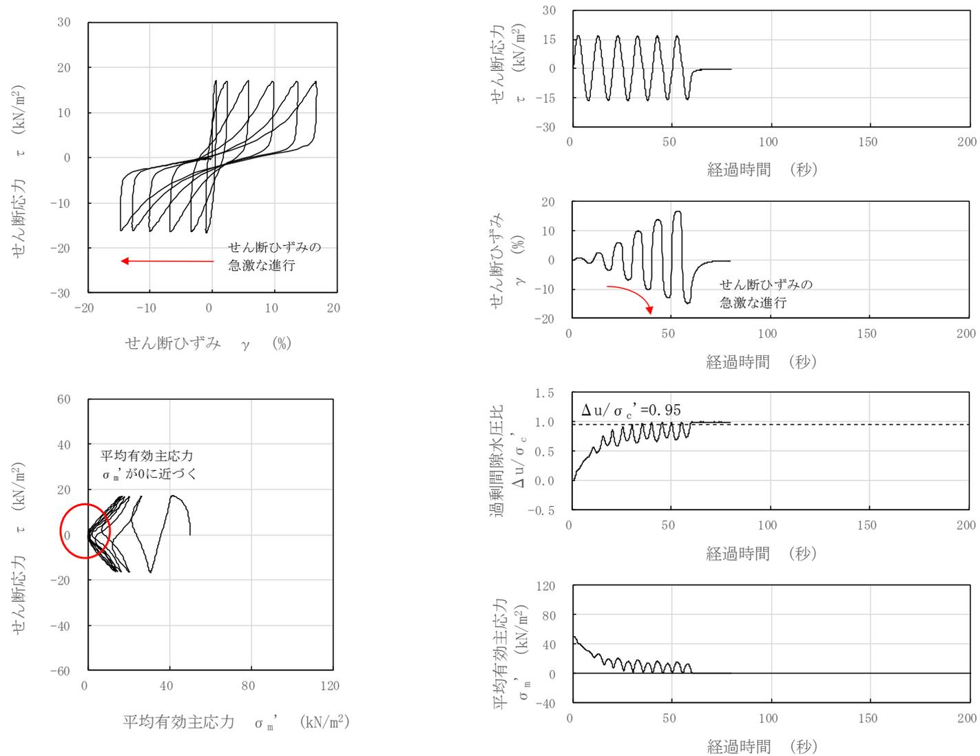
図 3-38 液状化試験結果 (埋戻土, GTG-S2-④, GL. -3.22~3.87m, 有効拘束圧 50kN/m<sup>2</sup>, せん断応力比=0.338)
