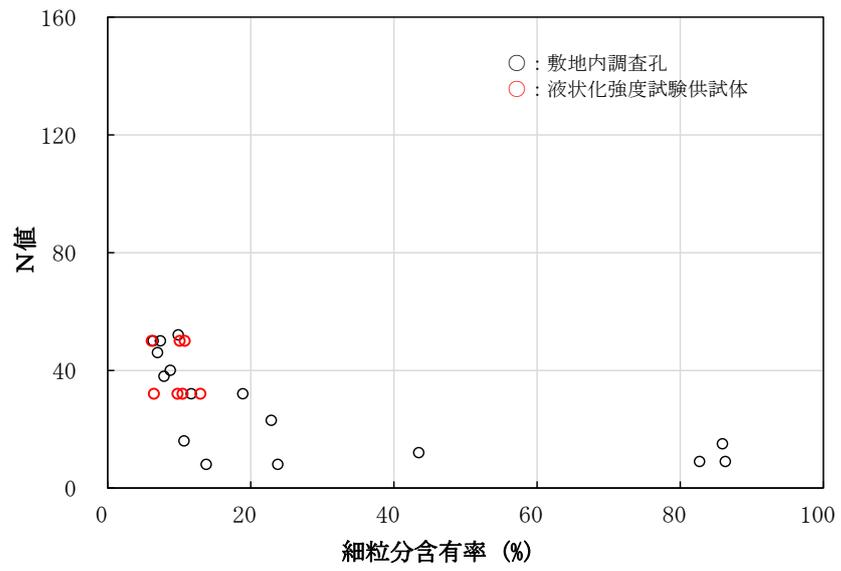
図 4-29 液状化強度試験箇所及び敷地内調査孔の細粒分含有率  $F_c$  と N 値の関係
