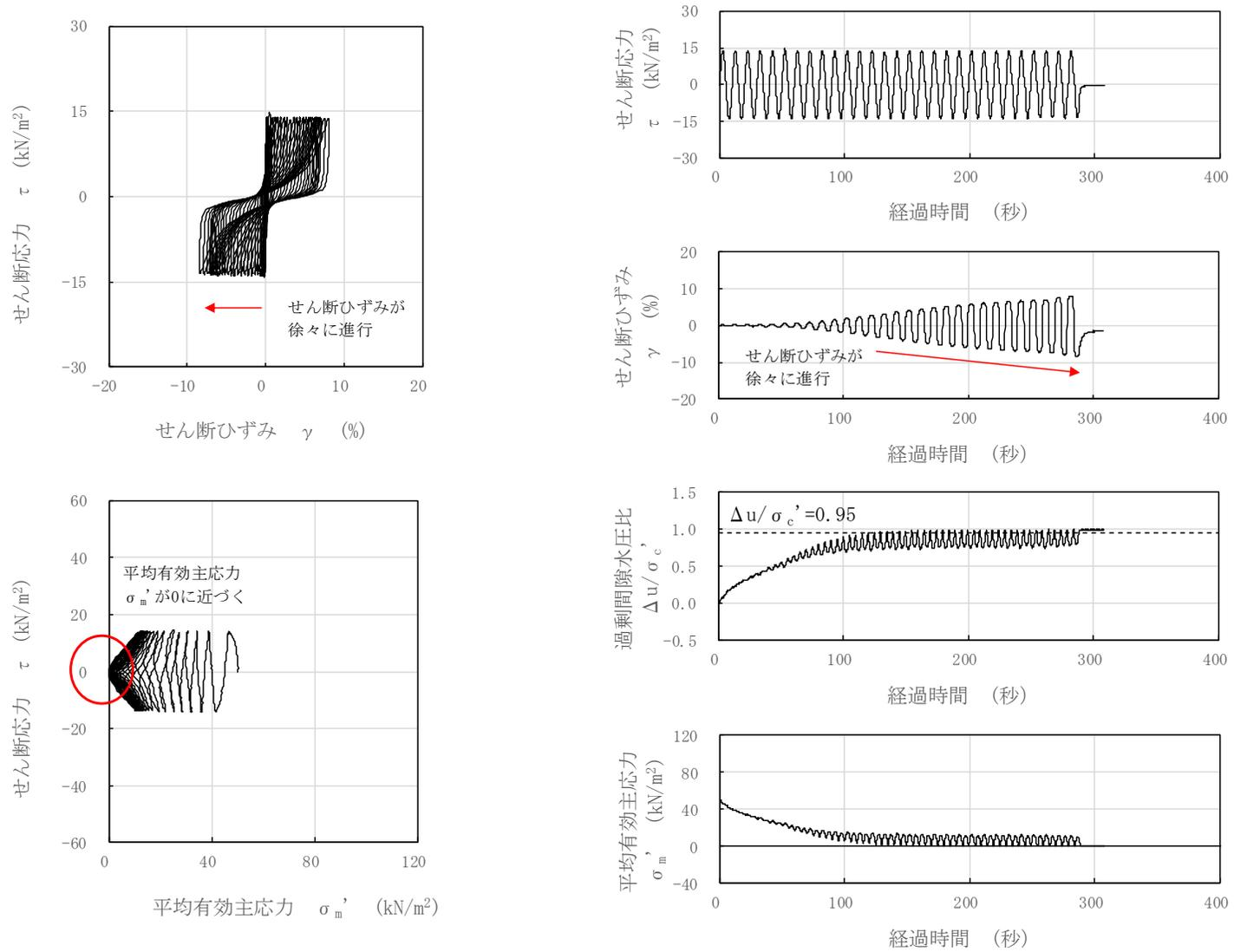
図 3-40 液状化試験結果 (埋戻土, GTG-S2-⑥, GL. -3.22~3.87m, 有効拘束圧 50kN/m<sup>2</sup>, せん断応力比=0.233)
