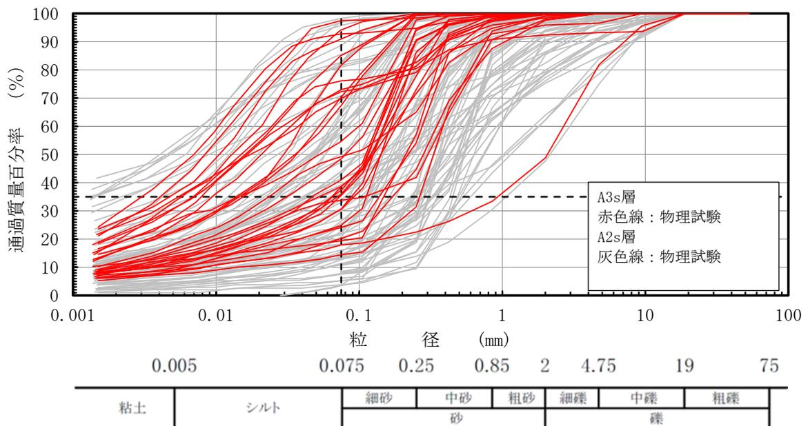
図 3-3 A3s 層と A2s 層の粒径加積曲線
