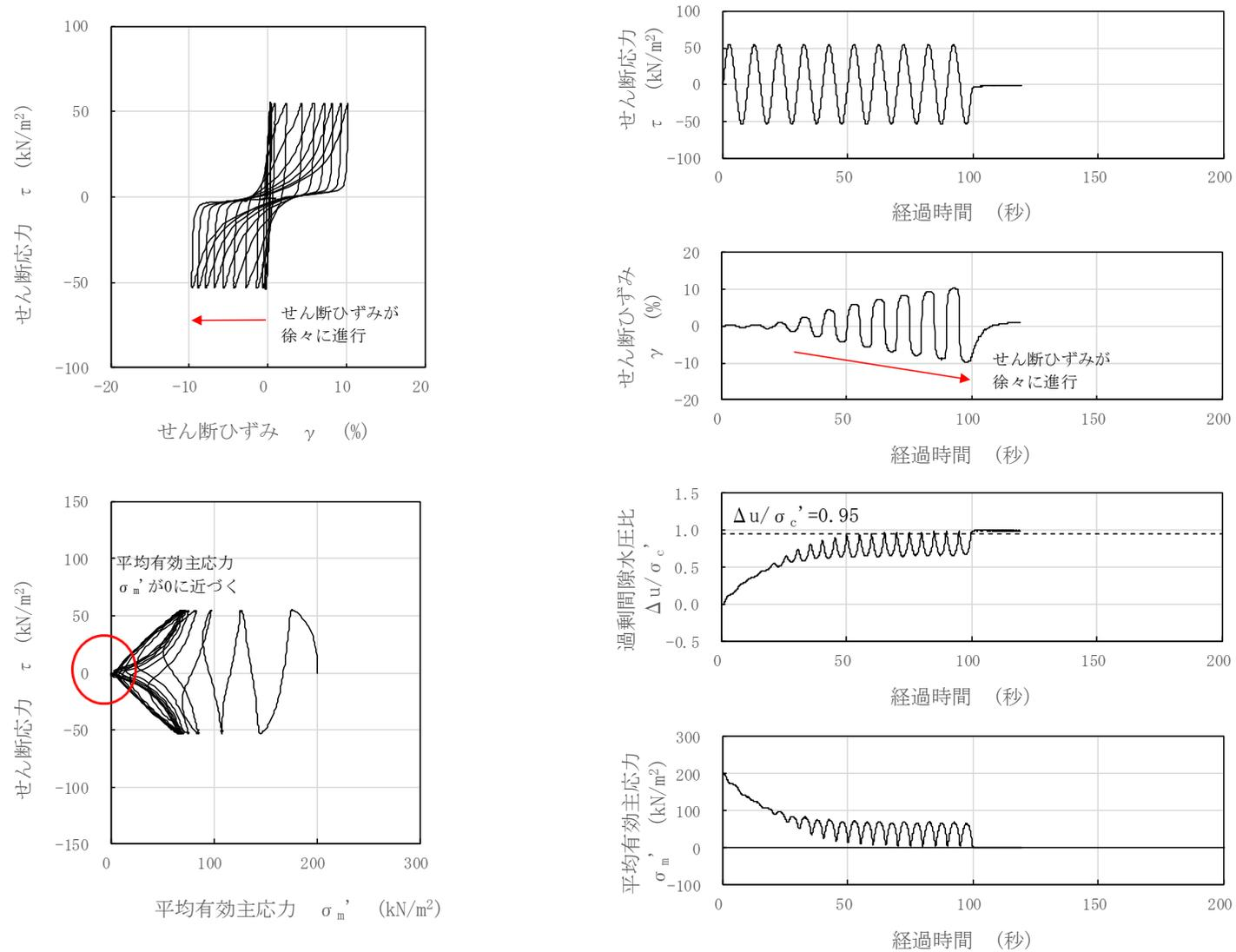
図 3-50 液状化試験結果 (新期砂層, GTG-S3-④, GL. -6.72~7.24m, 有効拘束圧 200kN/m<sup>2</sup>, せん断応力比=0.273)
