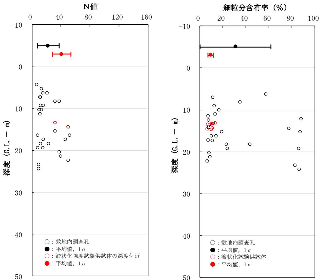
図 4-28 液状化強度試験箇所及び敷地内調査孔のN値，細粒分含有率  $F_c$  の比較
