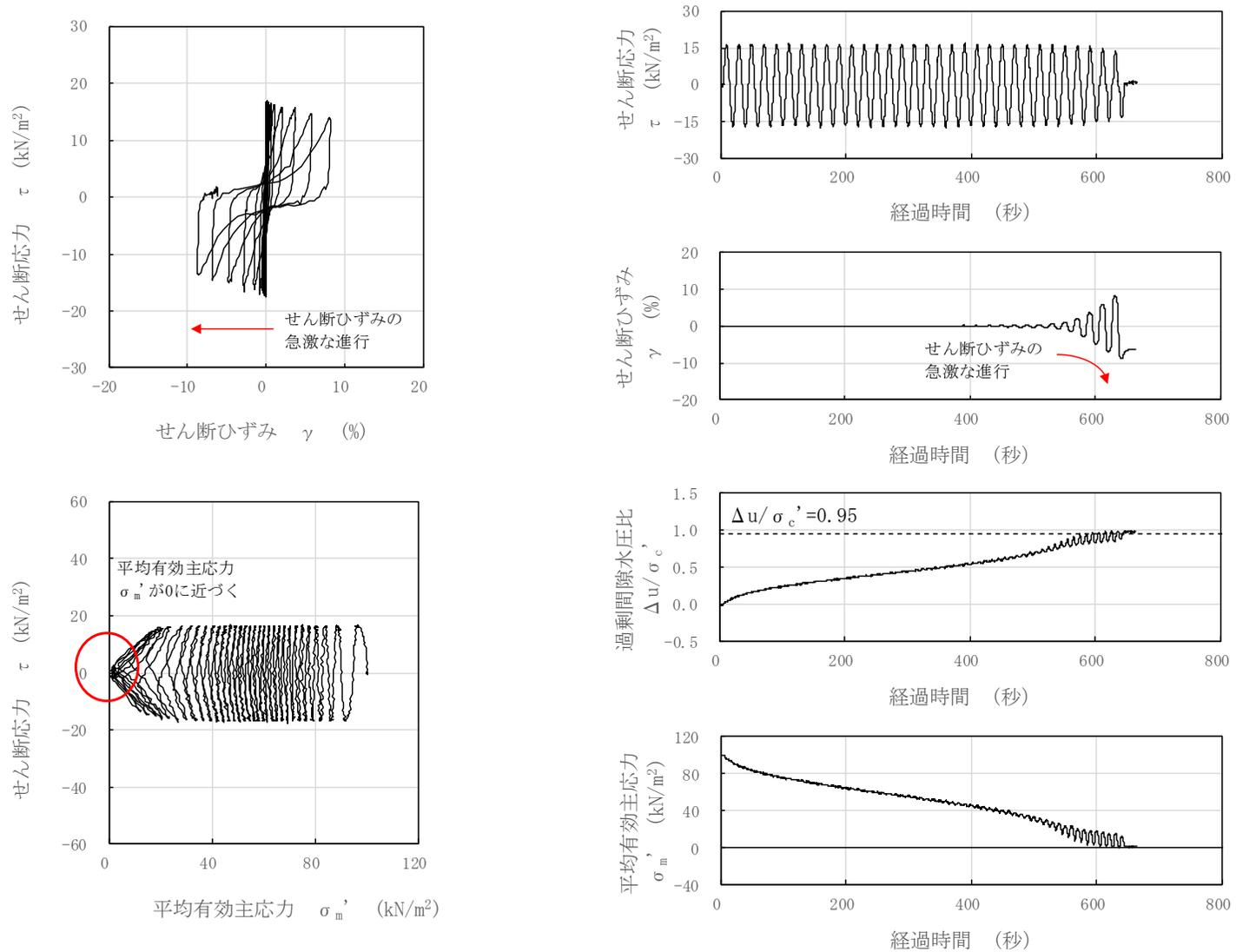
図 2-1 液状化試験結果 (埋戻土, S0-S2'-3-2, GL. -5.13~5.25m, 有効拘束圧 100kN/m<sup>2</sup>, せん断応力比=0.168)
