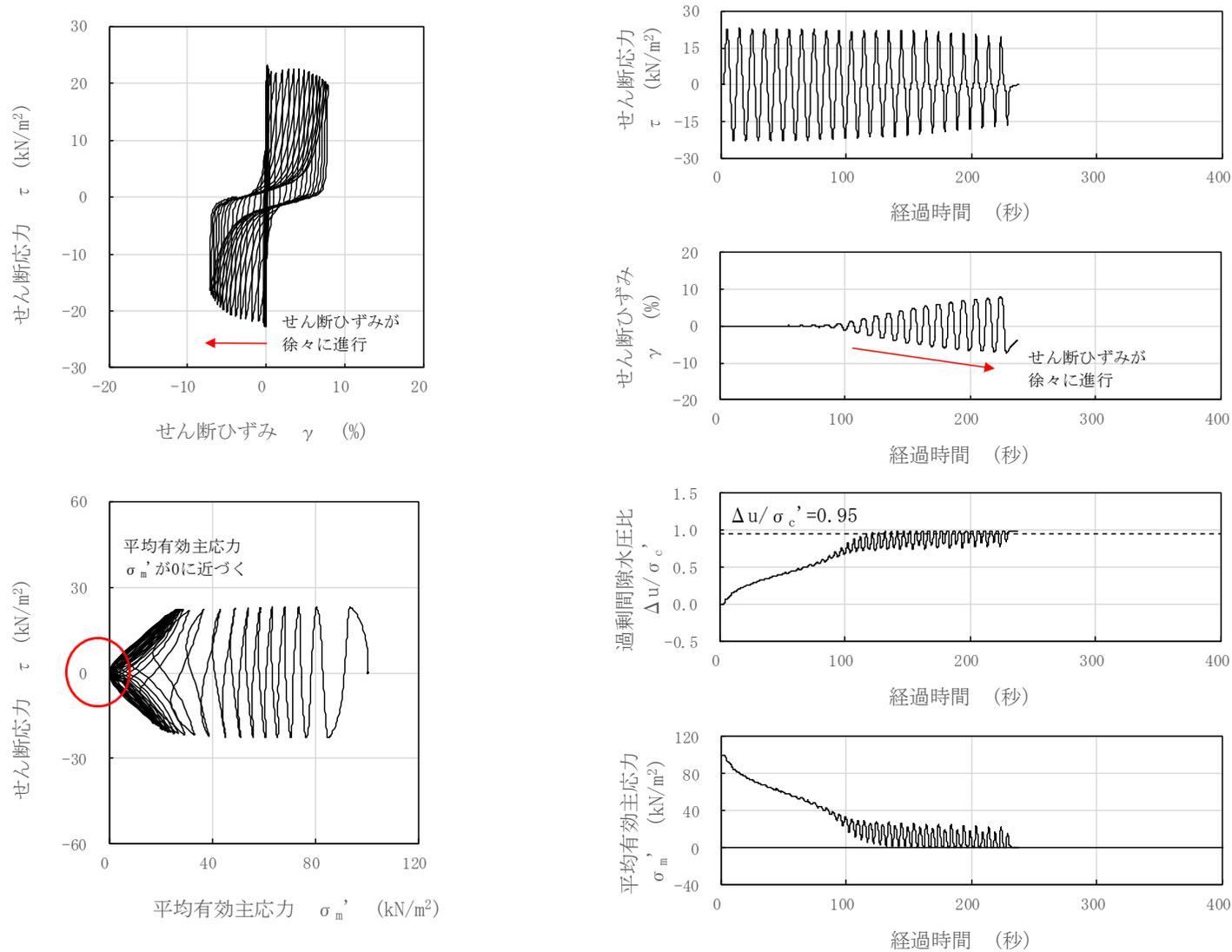
図 3-68 液状化試験結果 (新期砂層, S0-S1-2-6, GL. -8.16~8.28m, 有効拘束圧 100kN/m<sup>2</sup>, せん断応力比=0.227)
