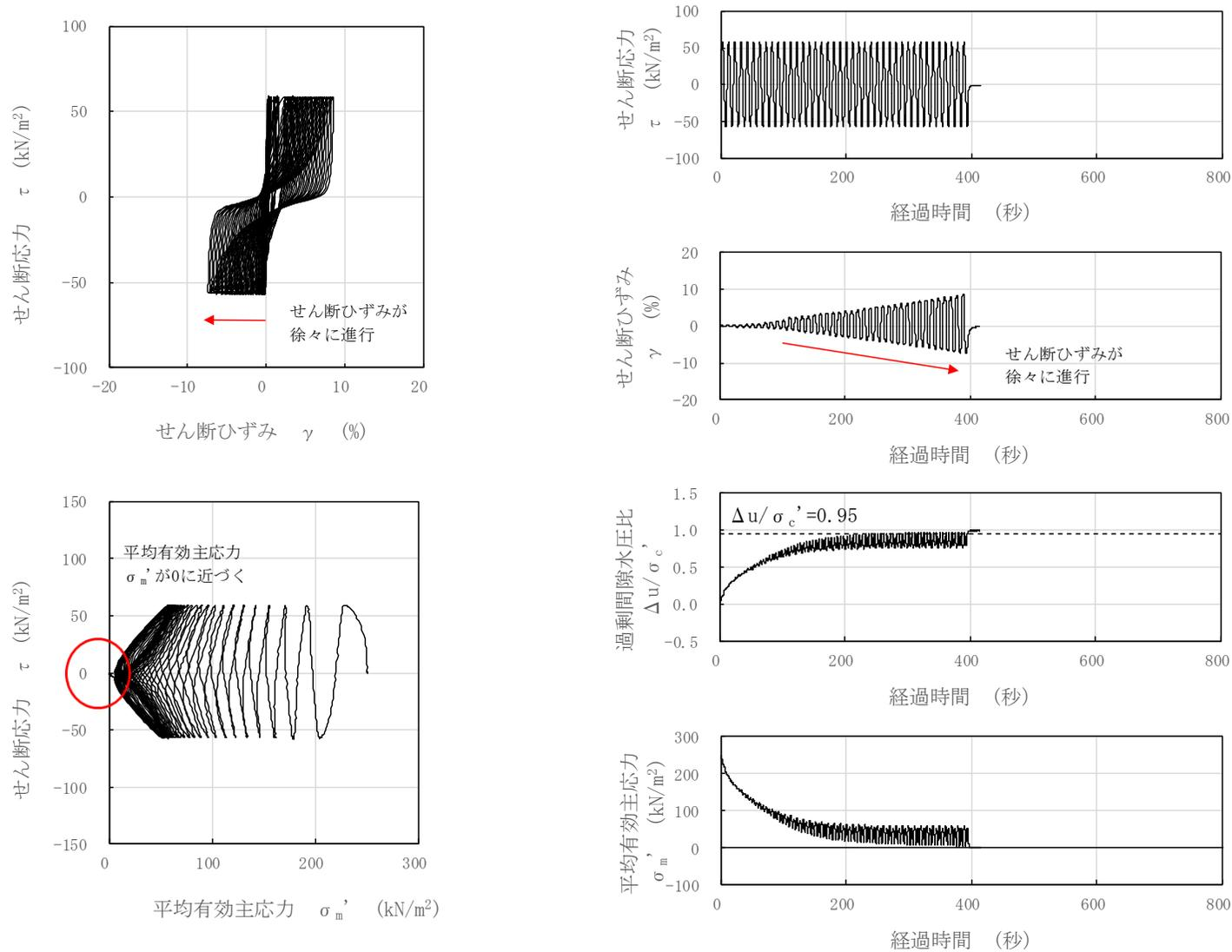
図 3-78 液状化試験結果 (沖積層下部, GTG-S6-⑥, GL. -11.70~14.70m, 有効拘束圧 250kN/m<sup>2</sup>, せん断応力比=0.232)
