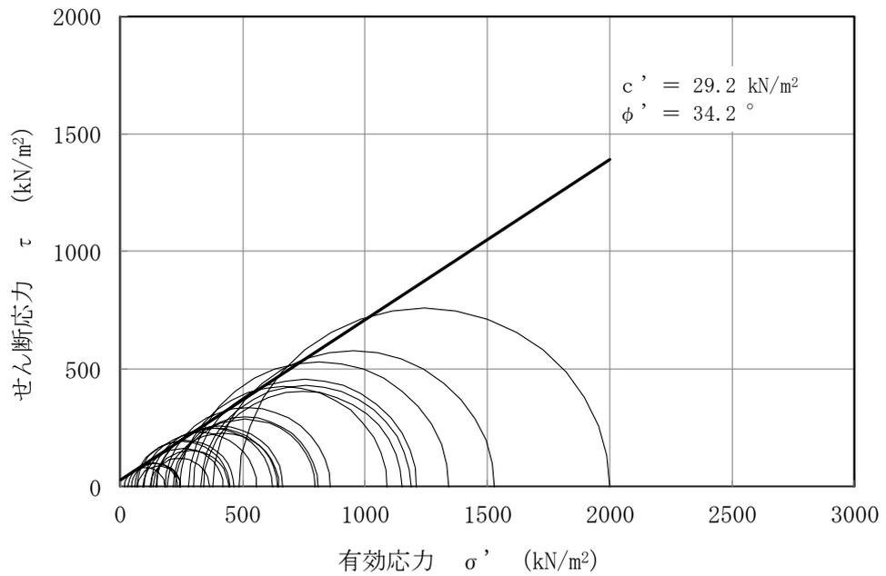
図 3-20 A3a1 層の三軸圧縮試験結果及び強度定数
