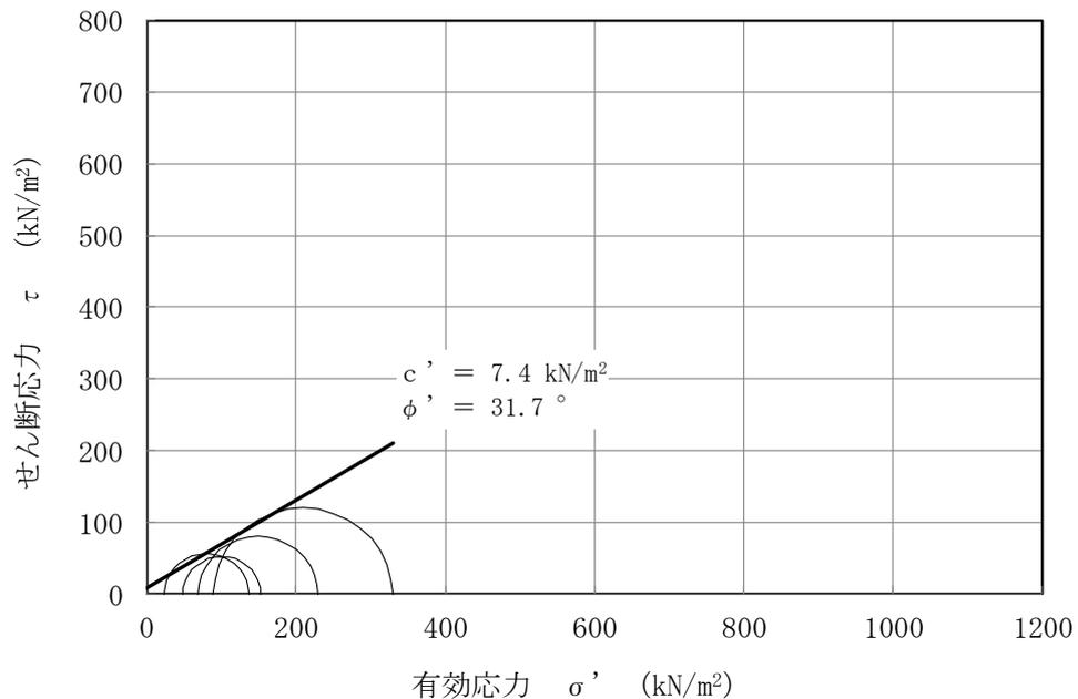
図 3-14 埋戻土Ⅱの三軸圧縮試験結果及び強度定数
