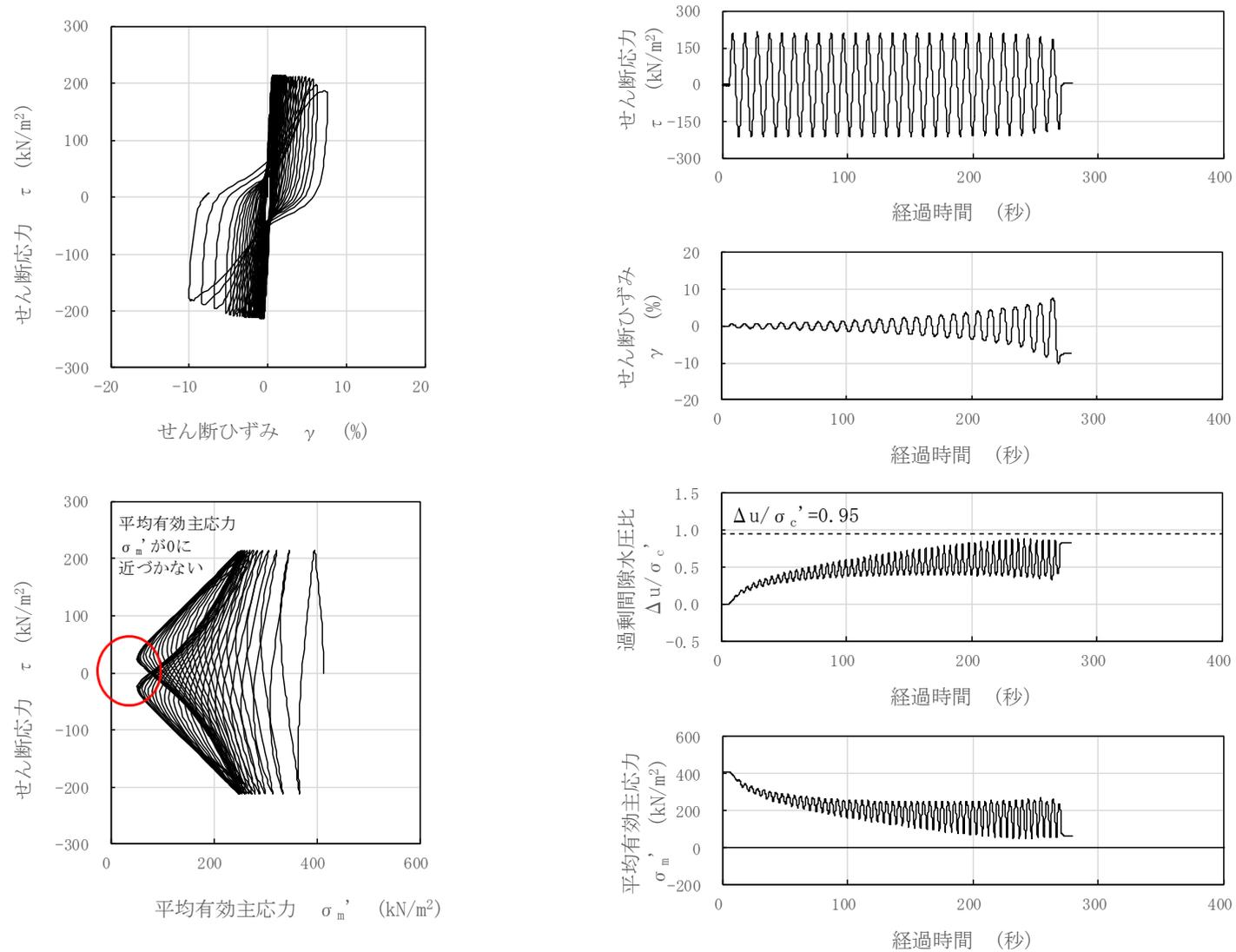
図 3-125 液状化試験結果 (A2s 層, FS02-2-18, GL. -25.10~25.25m, 有効拘束圧 412kN/m<sup>2</sup>, せん断応力比=0.519)
