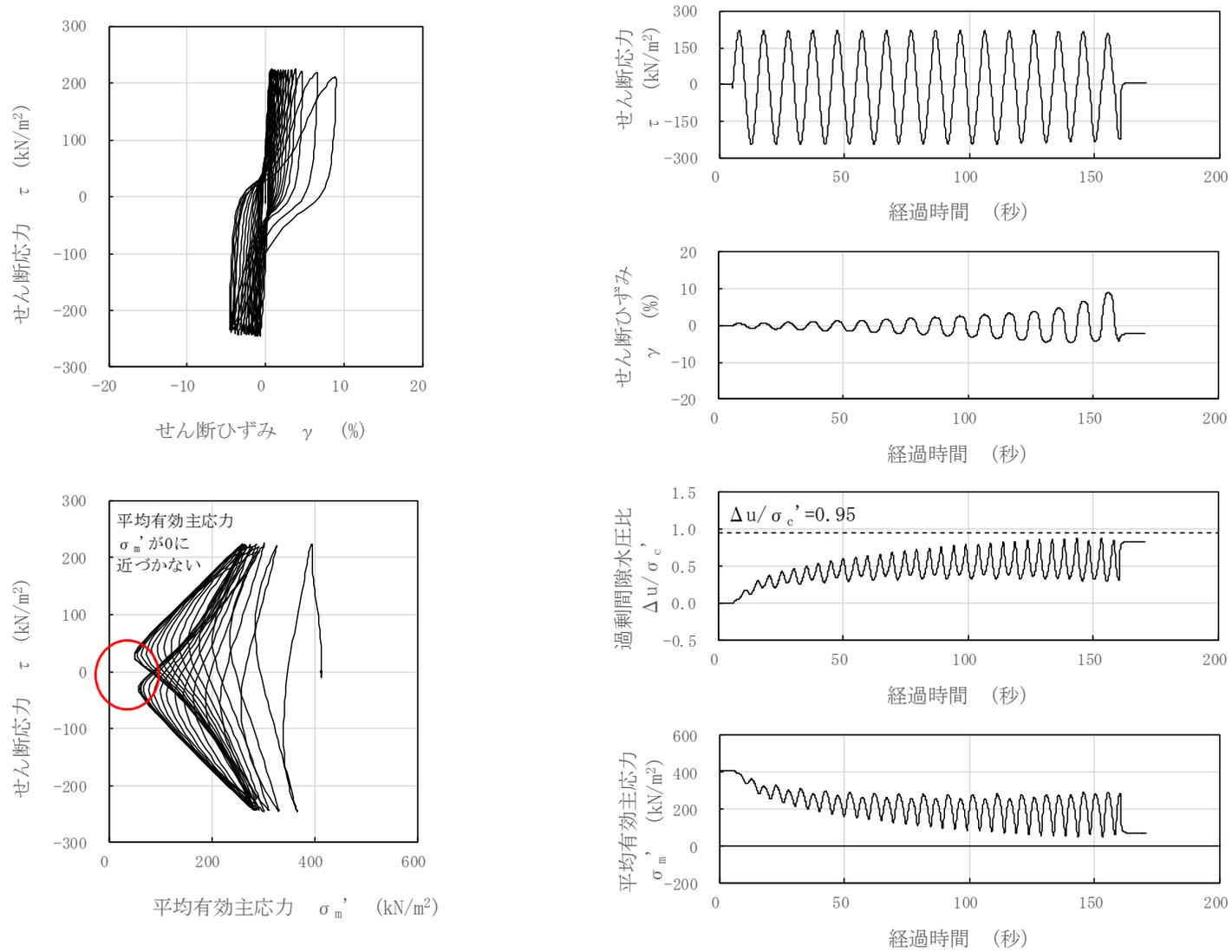
図 3-126 液状化試験結果 (A2s 層, FS02-2-19, GL. -25.25~25.40m, 有効拘束圧 412kN/m<sup>2</sup>, せん断応力比=0.567)
