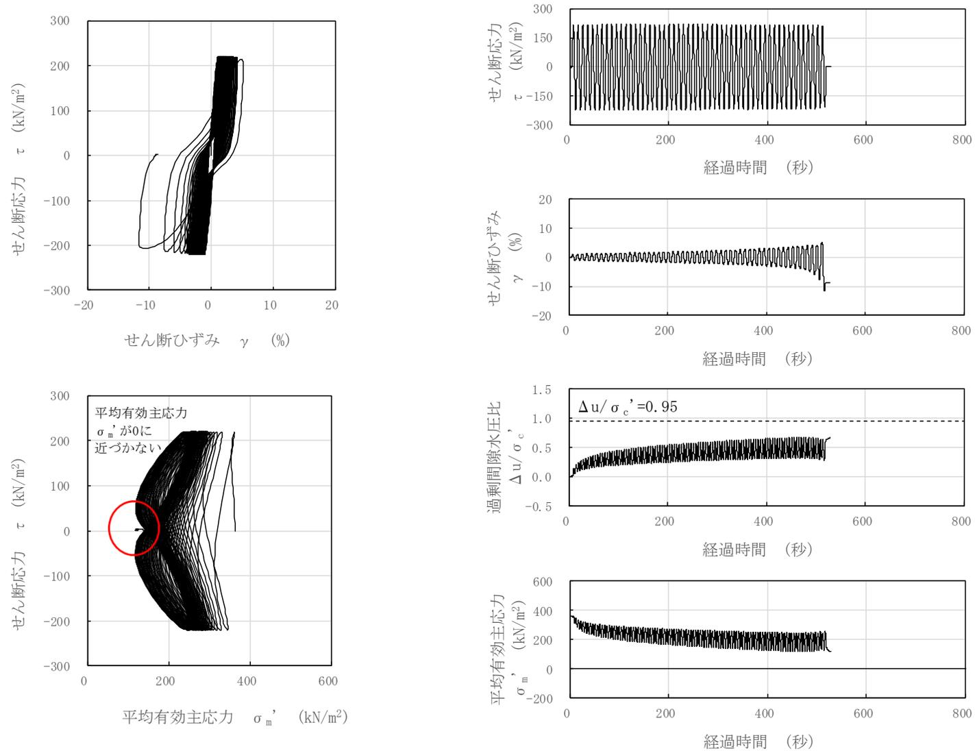
図 3-100 液状化試験結果 (A2s 層, FS-4-1-3, GL. -27.12~27.29m, 有効拘束圧 363kN/m<sup>2</sup>, せん断応力比=0.605)
