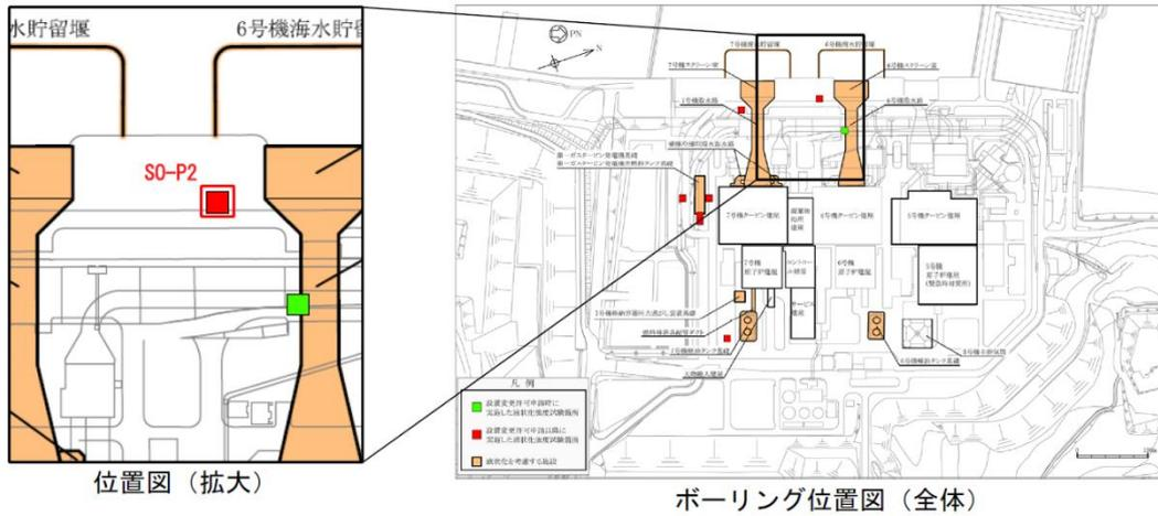
孔名 : S0-P2 孔口標高 : T. M. S. L. 3.01m 掘進長 : L=10.0m (設置変更許可申請以降の液状化強度試験箇所)
