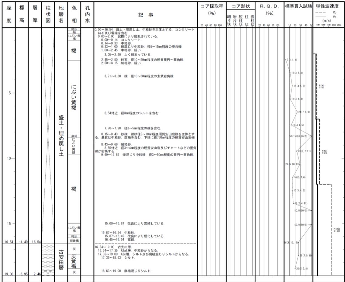
図 2-40 ボーリング柱状図 (SH6-1)
