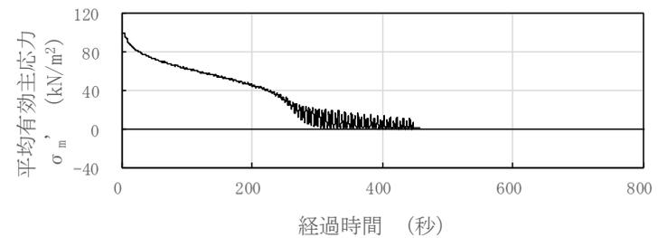
図 3-67 液状化試験結果 (新期砂層, S0-S1-2-5, GL. -8.04~8.16m, 有効拘束圧 100kN/m<sup>2</sup>, せん断応力比=0.195)
