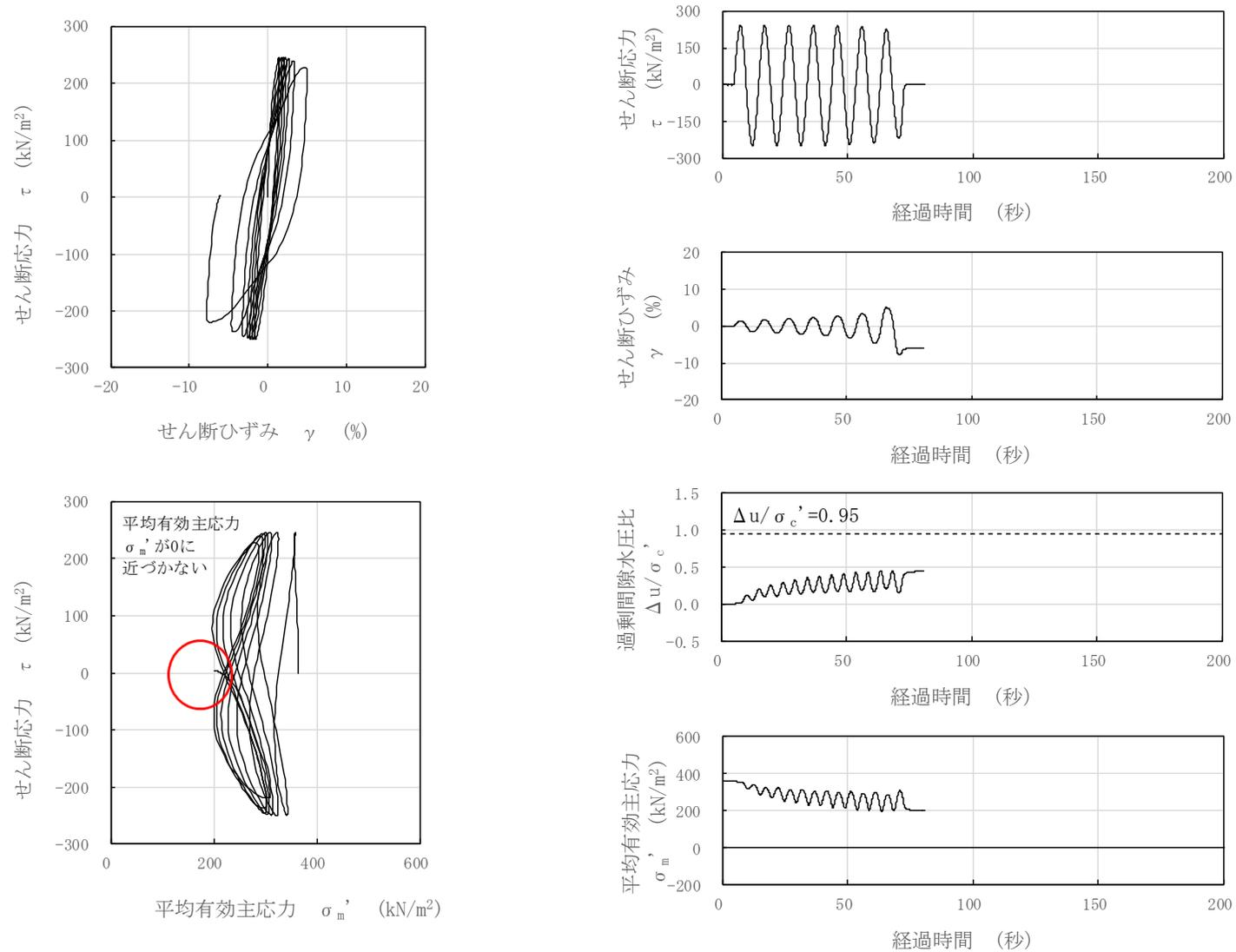
図 3-102 液状化試験結果 (A2s 層, FS-4-1-5, GL. -27.46~27.63m, 有効拘束圧 363kN/m<sup>2</sup>, せん断応力比=0.683)
