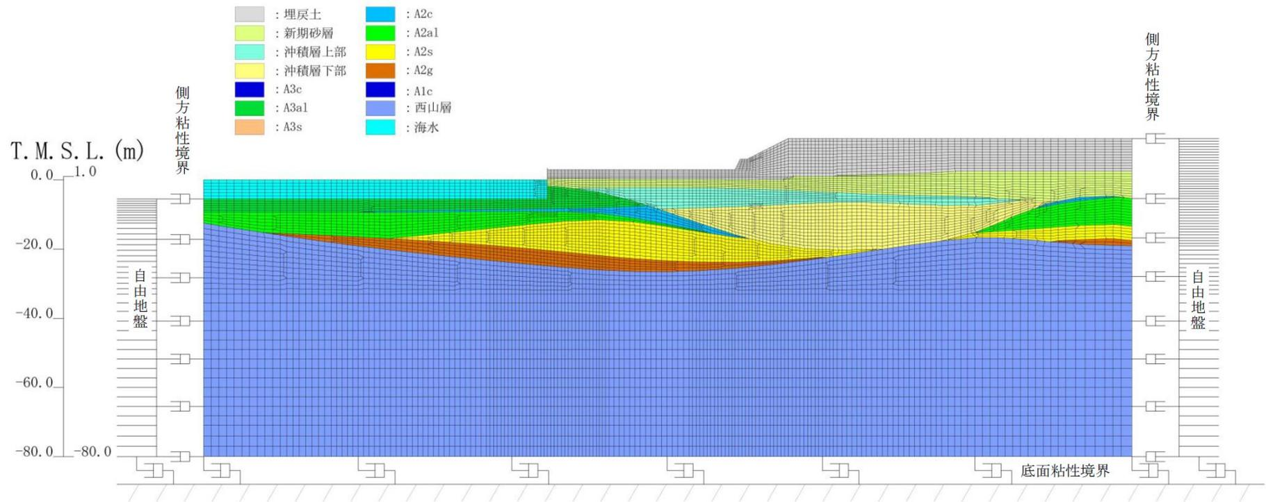
図 3-3 再現解析の解析モデル (南断面)
