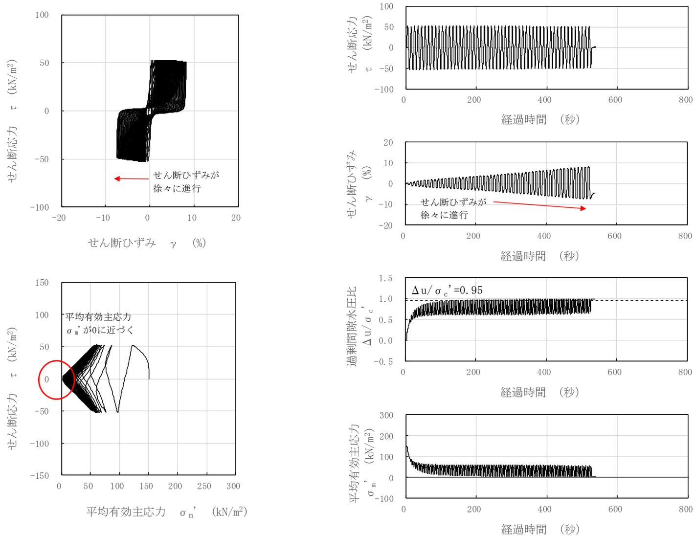
図 3-92 液状化試験結果（沖積層下部，S0-S1-13-7，GL. -22.83~22.95m，有効拘束圧 150kN/m<sup>2</sup>，せん断応力比=0.349）
