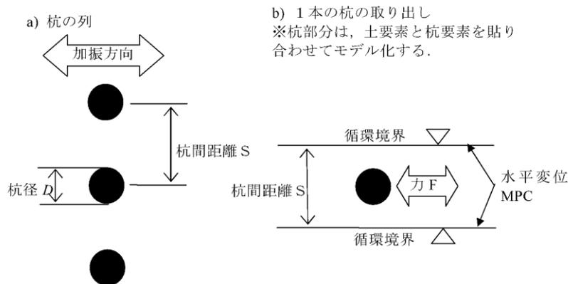
図 4-11-1 杭荷重-相対変位関係を調べるための水平断面モデル<sup>1)</sup>
