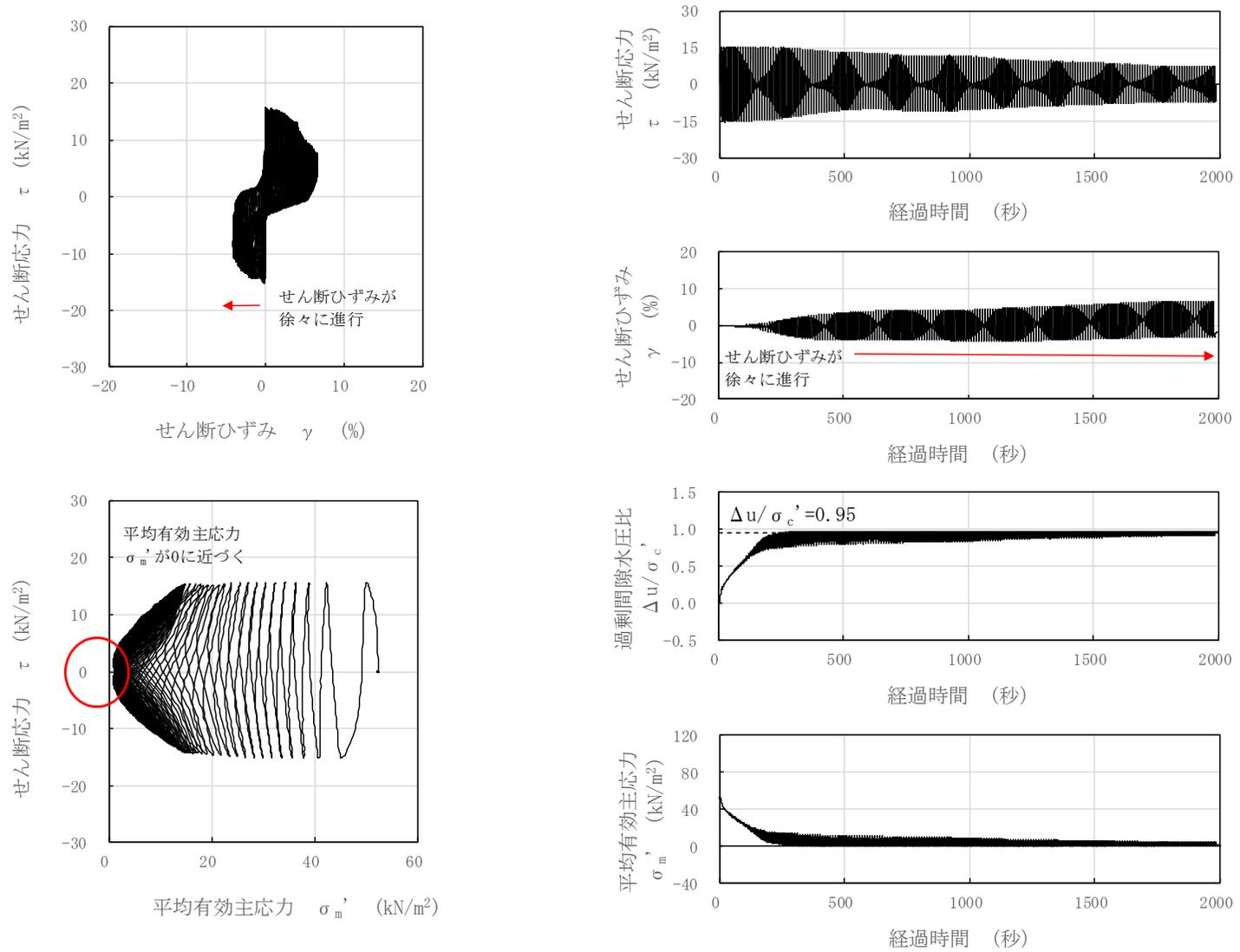
図 3-61 液状化試験結果 (新期砂層, S0-S1-1-1, GL. -6.61~6.73m, 有効拘束圧 50kN/m<sup>2</sup>, せん断応力比=0.293)
