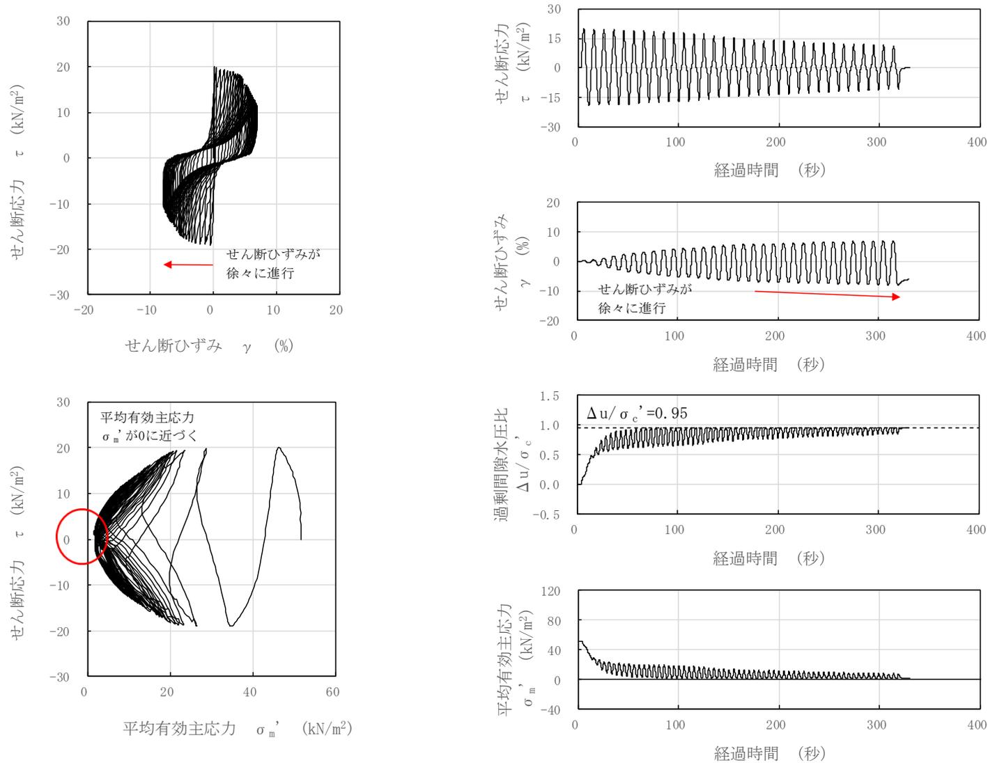
図 3-62 液状化試験結果 (新期砂層, S0-S1-1-2, GL. -6.73~6.85m, 有効拘束圧 50kN/m<sup>2</sup>, せん断応力比=0.377)
