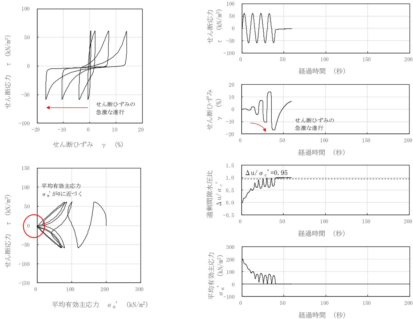
図 3-57 液状化試験結果 (新期砂層, GTG-S4-②, GL. -14.22~14.87m, 有効拘束圧 200kN/m<sup>2</sup>, せん断応力比=0.299)
