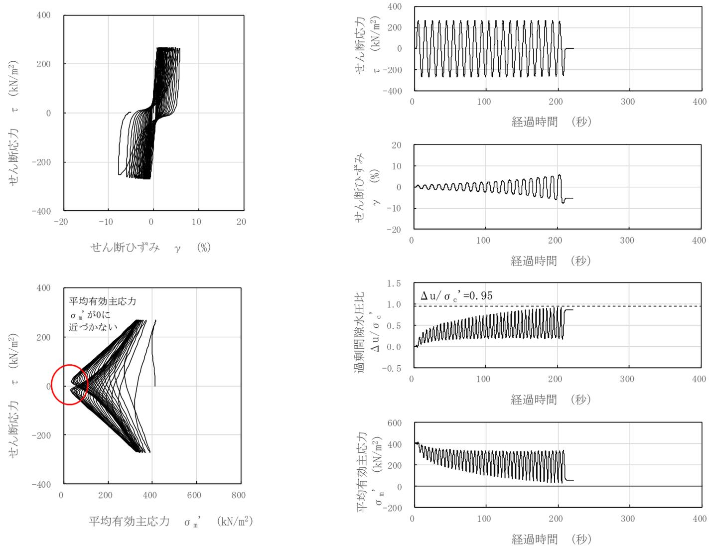
図 3-114 液状化試験結果 (A2s 層, FS-4-8-5, GL. -33.40~33.55m, 有効拘束圧 412kN/m<sup>2</sup>, せん断応力比=0.651)
