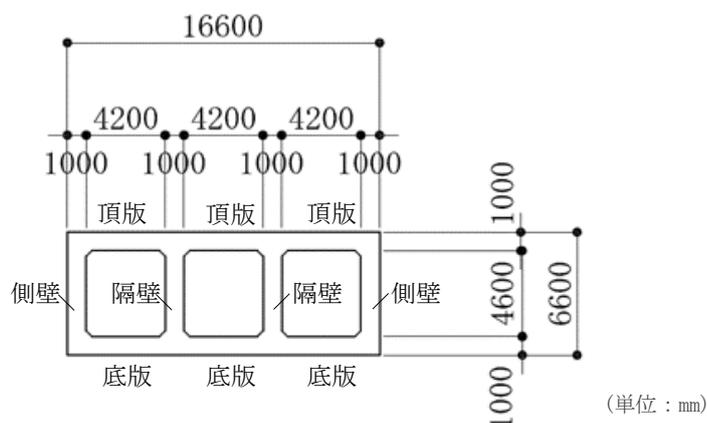
図 3-3 取水路（一般部）の構造と評価部位
