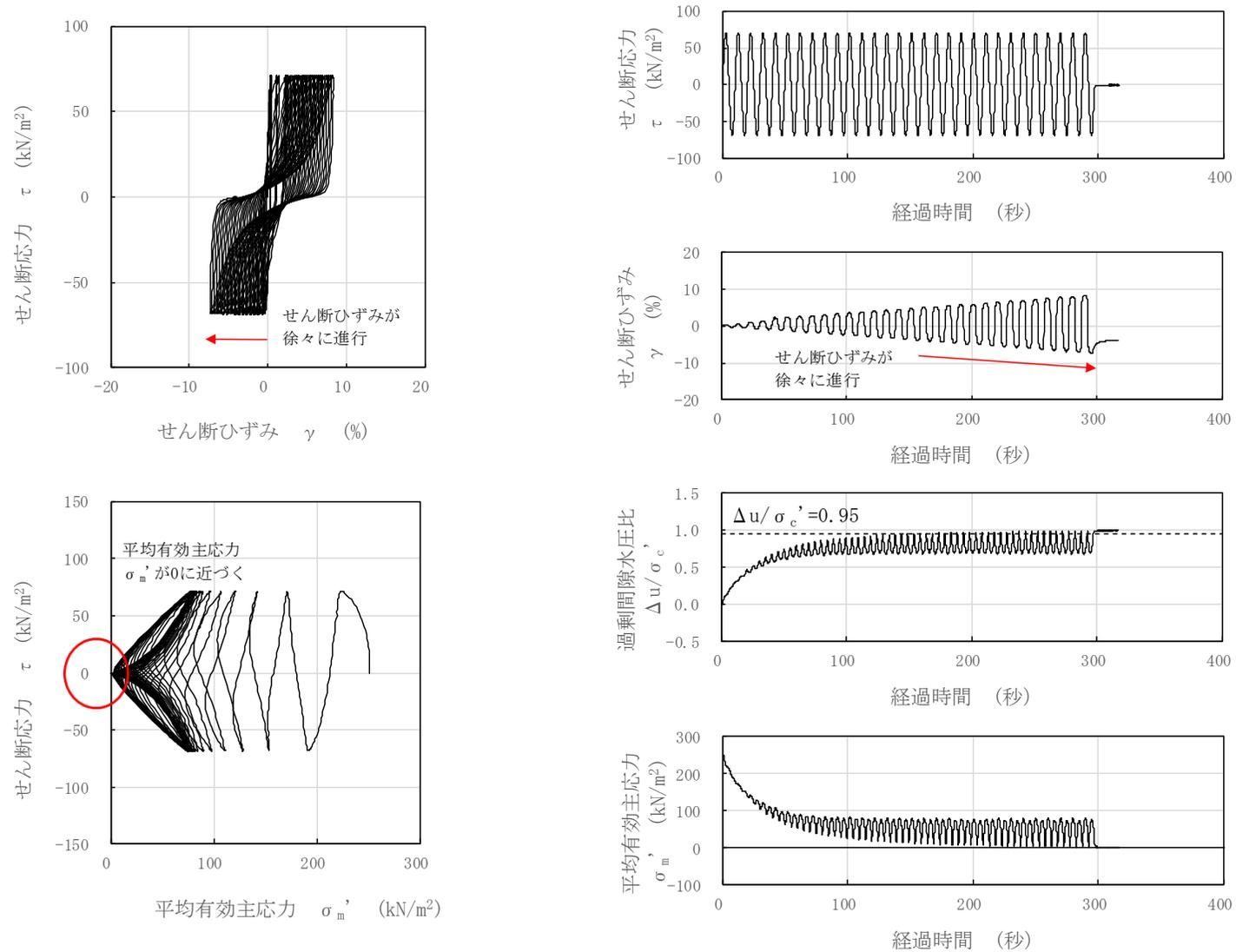
図 3-84 液状化試験結果 (沖積層下部, GTG-S6'-③, GL. -12.70~13.70m, 有効拘束圧 250kN/m<sup>2</sup>, せん断応力比=0.280)
