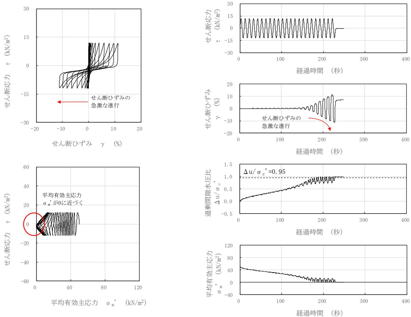
図 3-48 液状化試験結果 (埋戻土, GTG-S4-⑤, GL. -10.35~10.87m, 有効拘束圧  $50 \text{ kN/m}^2$ , せん断応力比=0.238)
