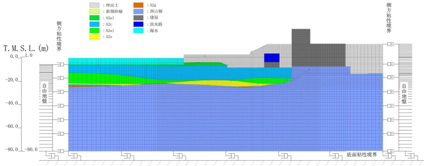
図 3-2 再現解析の解析モデル (北断面)
