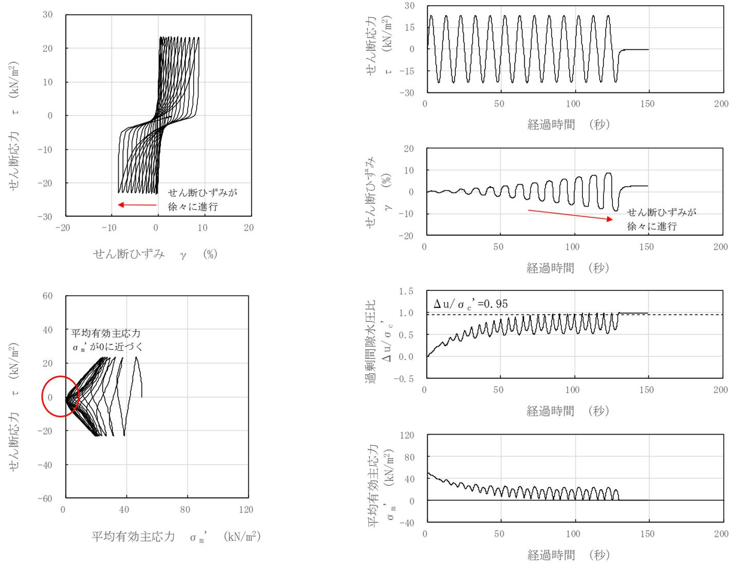
図 3-43 液状化試験結果 (埋戻土, GTG-S3-④, GL. -5.05~5.57m, 有効拘束圧 50kN/m<sup>2</sup>, せん断応力比=0.465)
