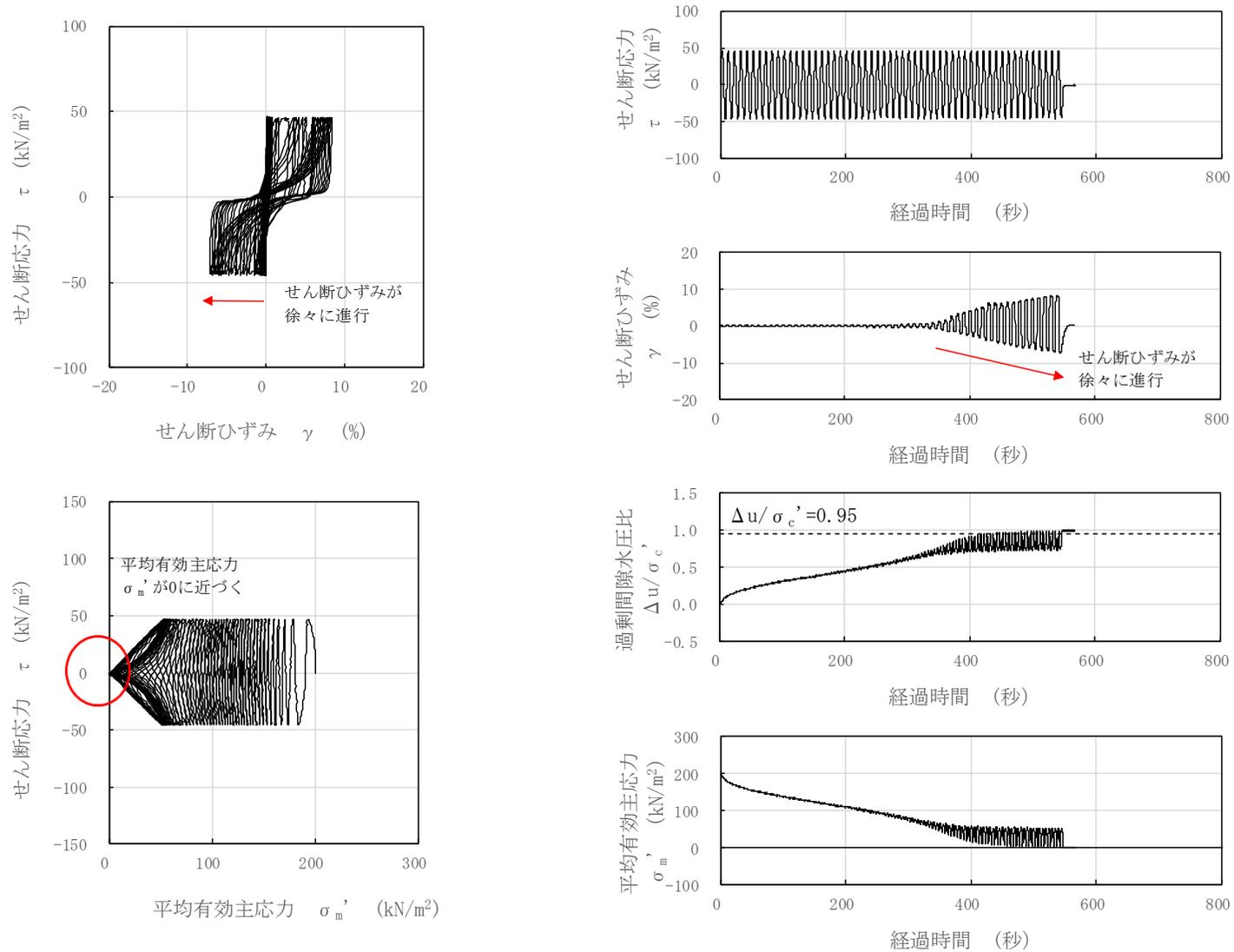
図 3-51 液状化試験結果 (新期砂層, GTG-S3-⑤, GL. -6.72~7.24m, 有効拘束圧 200kN/m<sup>2</sup>, せん断応力比=0.231)
