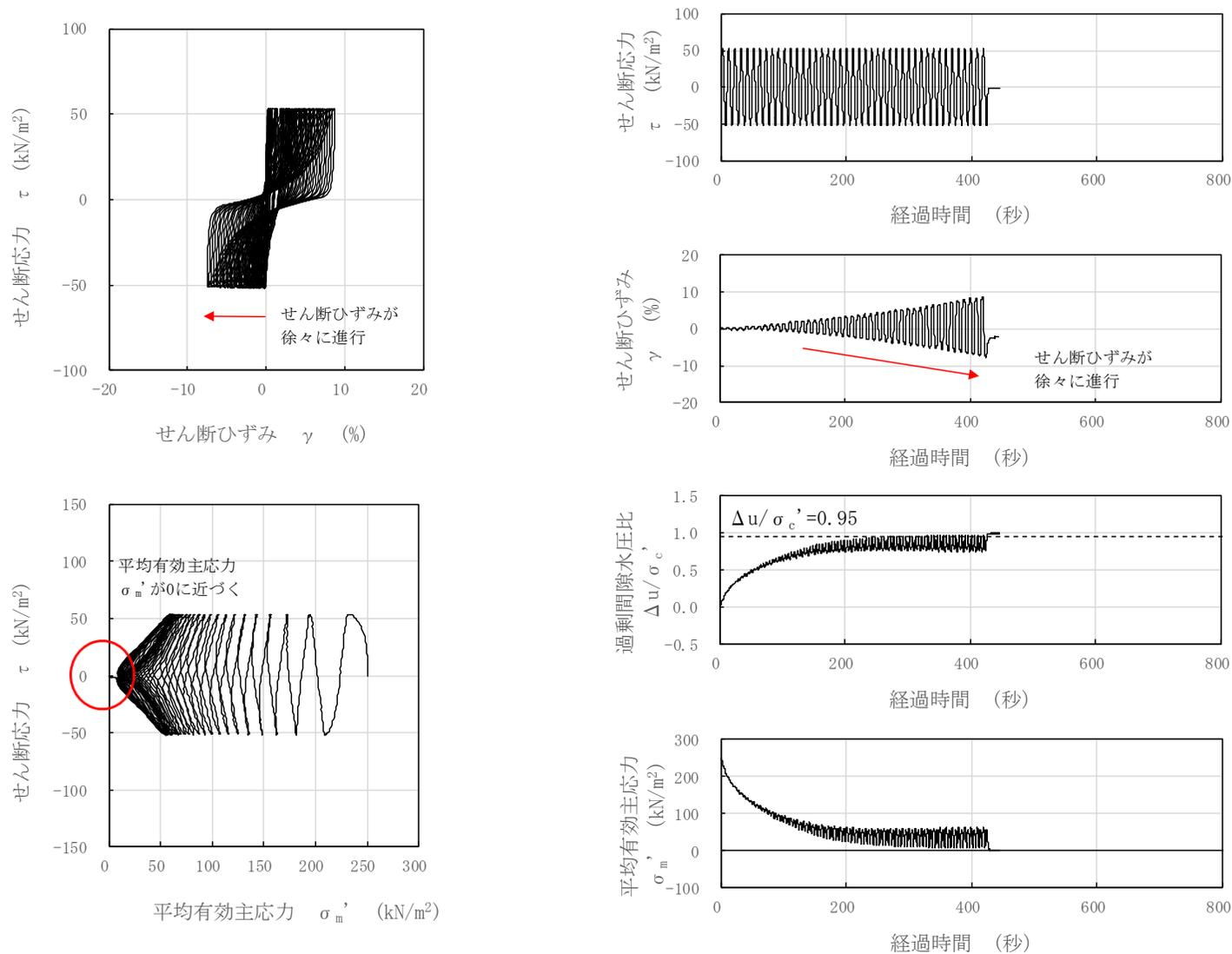
図 2-4 液状化試験結果 (沖積層下部, GTG-S6-⑤, GL. -11.70~14.70m, 有効拘束圧 250kN/m<sup>2</sup>, せん断応力比=0.211)
