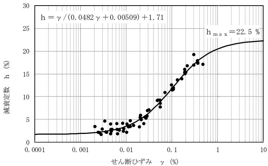
図3-2 埋戻土の動せん断弾性係数及び減衰定数のひずみ依存特性
