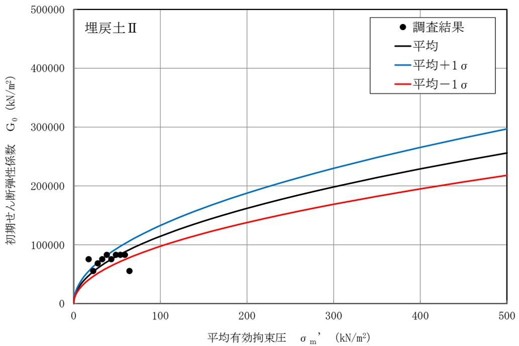
図 2-2  $G_0$  の  $\sigma'_m$  依存式 (埋戻土 II)
