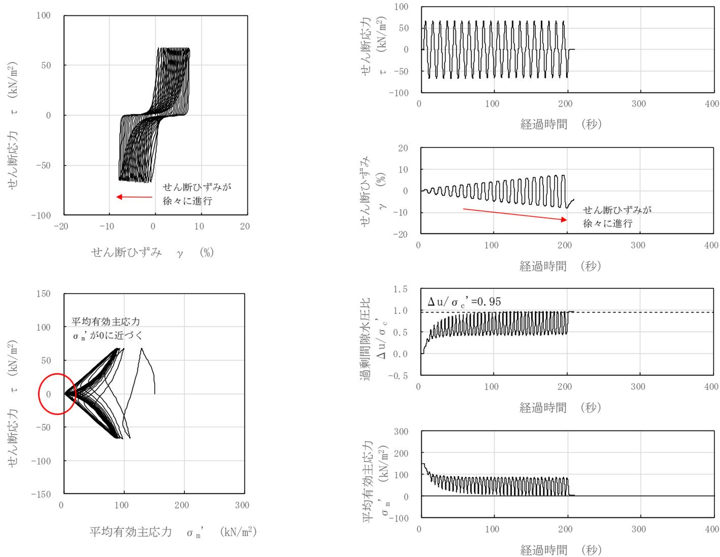
図 3-91 液状化試験結果 (沖積層下部, S0-S1-12-4, GL. -21.46~21.58m, 有効拘束圧 150kN/m<sup>2</sup>, せん断応力比=0.447)
