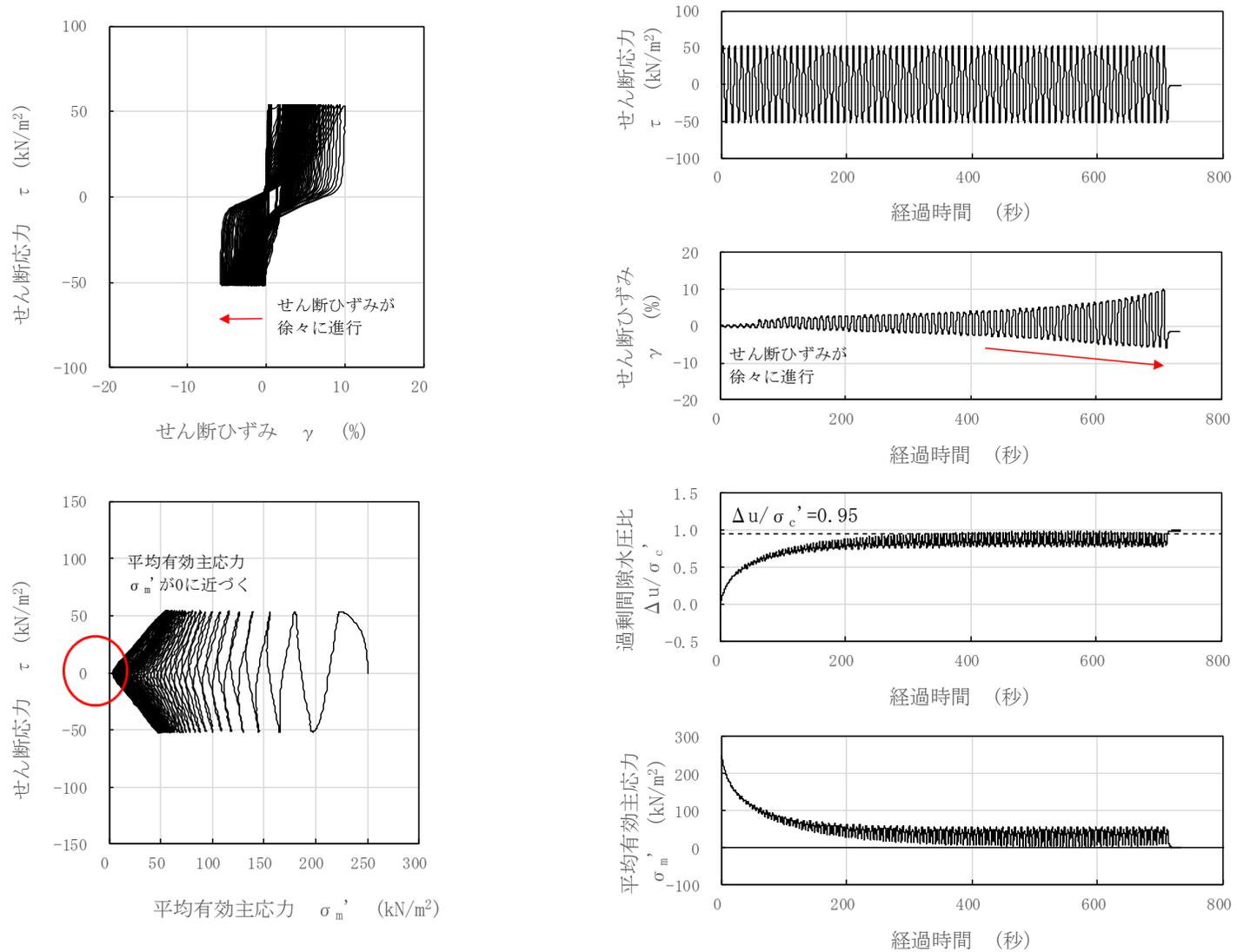
図 3-81 液状化試験結果 (沖積層下部, GTG-S6-③, GL. -15.70~16.65m, 有効拘束圧 250kN/m<sup>2</sup>, せん断応力比=0.211)
