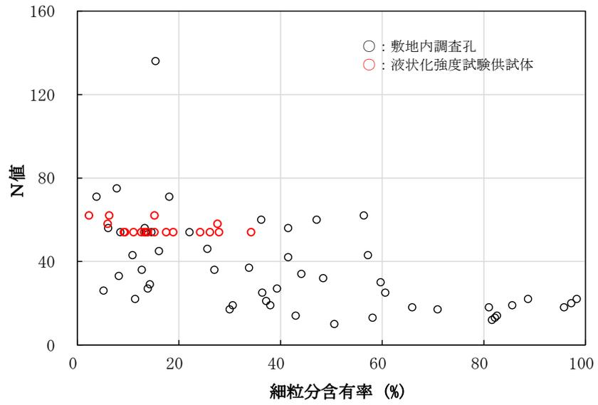
図 4-37 液状化強度試験箇所及び敷地内調査孔の細粒分含有率  $F_c$  と N 値の関係
