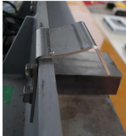
図 2-1 クリップの固定状態及び脱落状態
