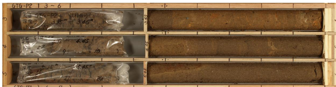
(a) 埋戻土のコア写真 (GTG-P2)
