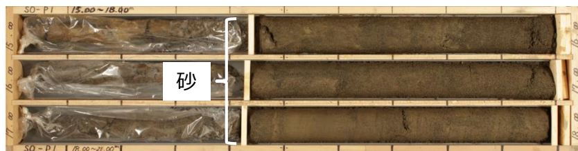
(c) 沖積層上部 (砂質) (SO-P1) のコア写真
