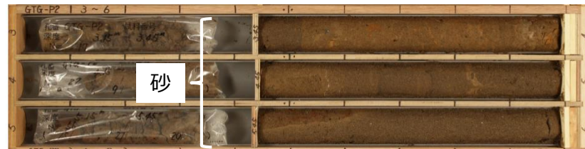
(a) 埋戻土のコア写真 (GTG-P2)
