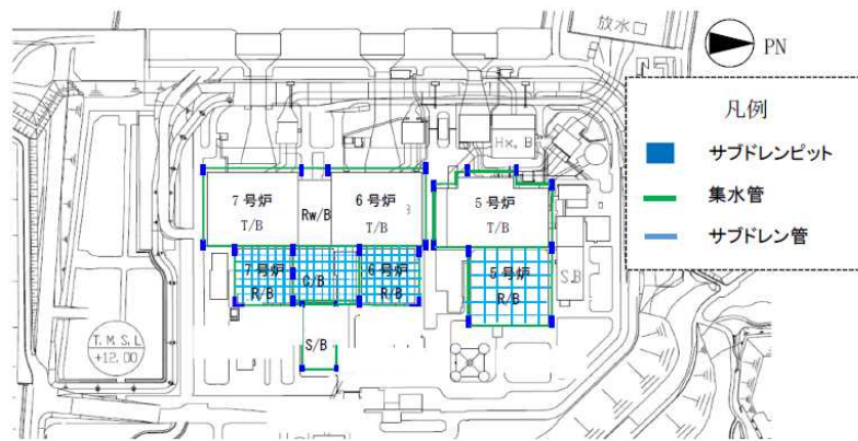
図1 5～7号炉地下水排水設備配置図
