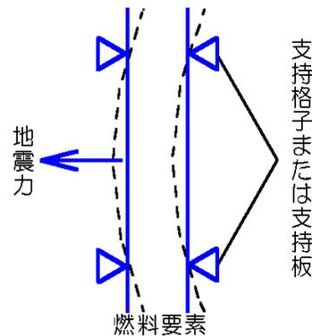
(10) チャンネルボックスの水平地震力によるたわみに基づく応力
