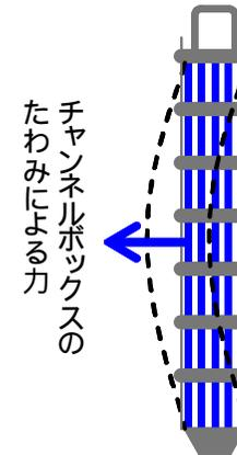
(11) 鉛直方向地震加速度に基づく応力
