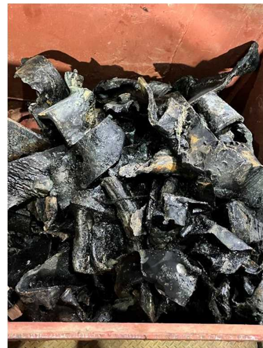
鉄片※ （30cm程度） ※損傷した流域下水管と推察
