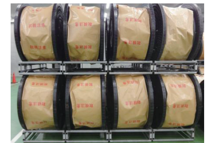
電線ドラム用パレットを活用したプラスチックドラムの保管方法
