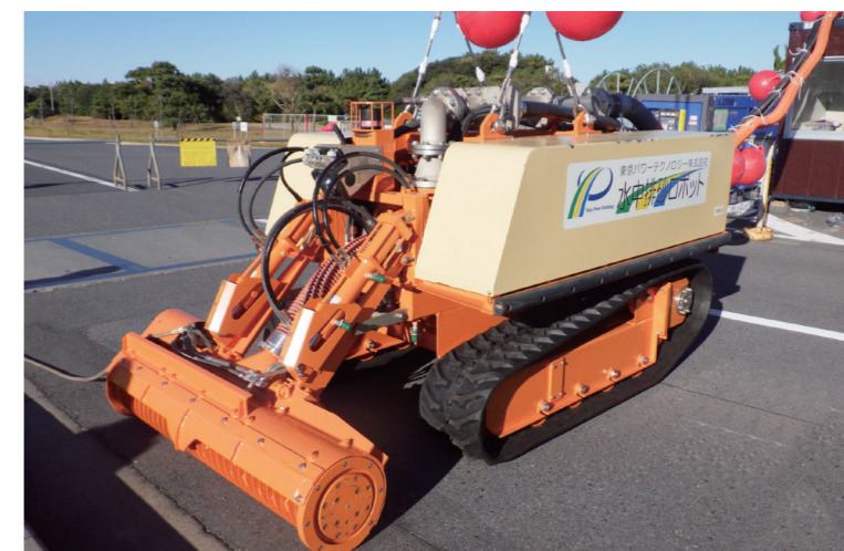
水中排砂ロボット
