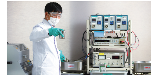
絶縁油分析/劣化診断
