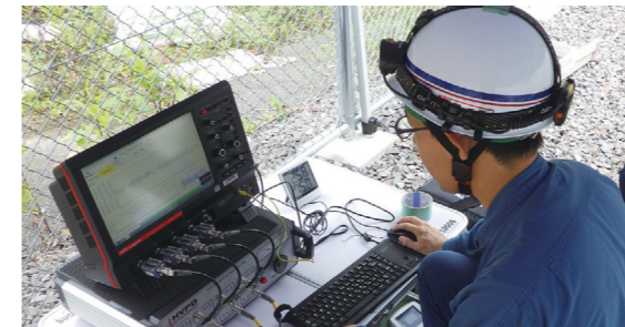
部分放電測定
