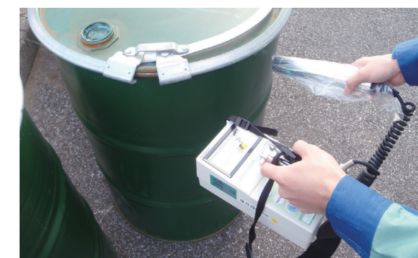
NaIシンチレーションサーベイメーター：放射線量(γ線)測定
