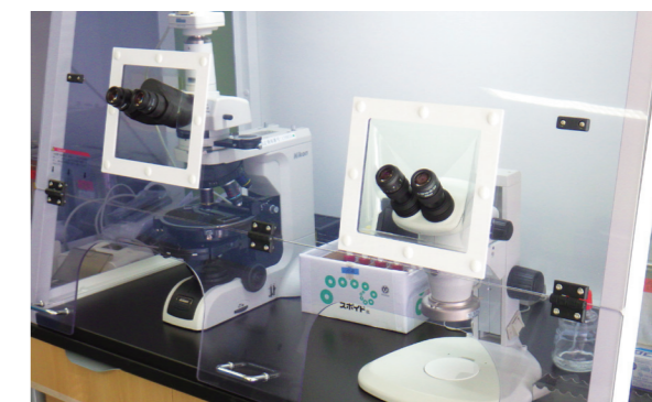
アスベスト用顕微鏡：アスベスト定性分析
