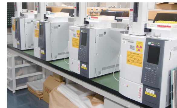
ガスクロマトグラフ(ECD検出器)：PCB分析
