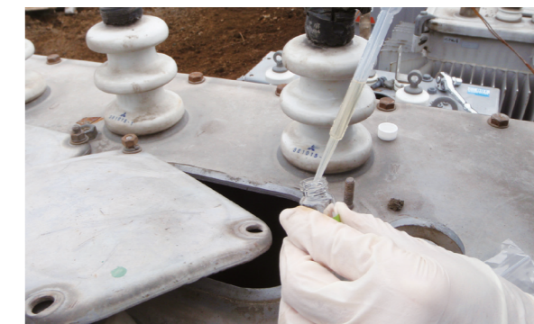
トランス内絶縁油採取：絶縁油中PCB分析
