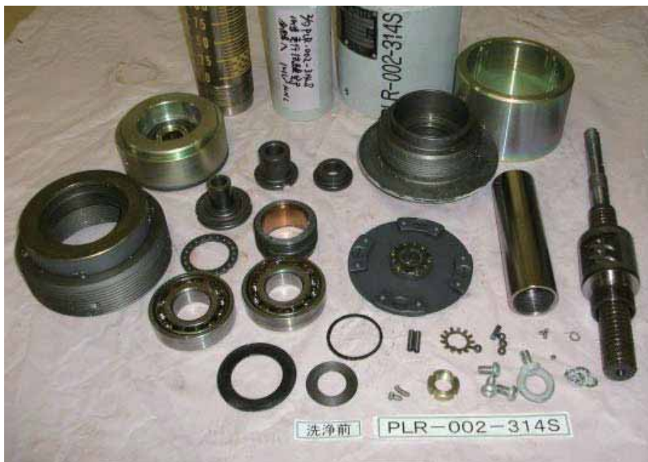
図 A3-2-3. メカニカルスナッパの分解点検結果（メカニカルスナッパ A）
