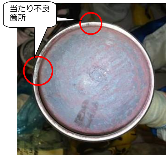
シート面の当たり状況（手入前）
