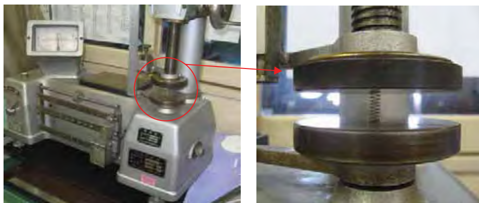
図-5 バネ力測定試験状況
