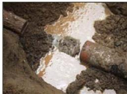
埋設消火配管の損傷
