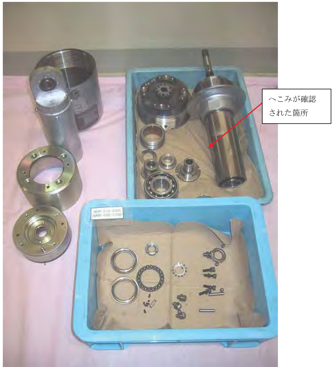
残留熱除去系配管メカニカルスナッパ 分解写真
