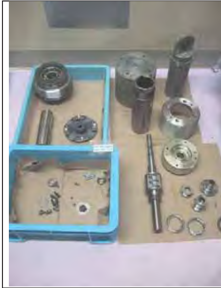
残留熱除去系配管メカニカルスナッパ
