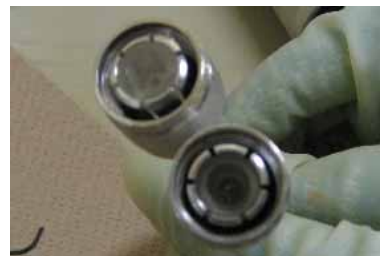
図6 コネクタ内への浸水の影響
