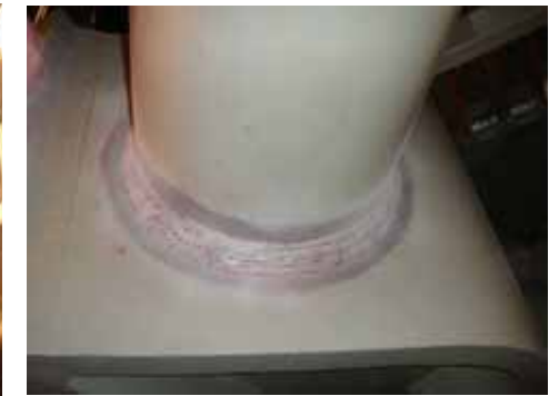
浸透探傷試験結果
