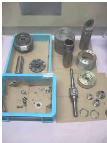
残留熱除去系配管メカニカルスナップ
