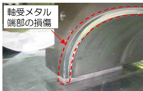
軸受メタルの損傷状況
