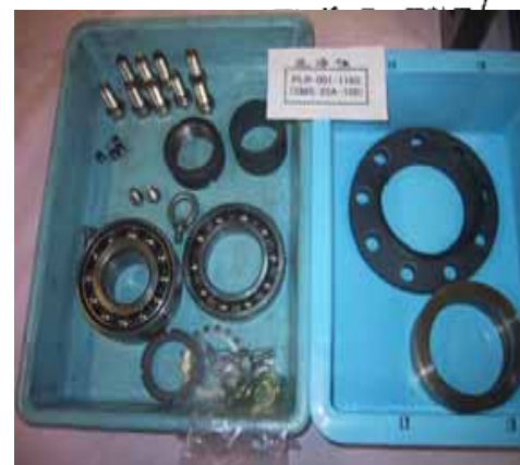
原子炉冷却材再循環系配管メカニカルスナップ
