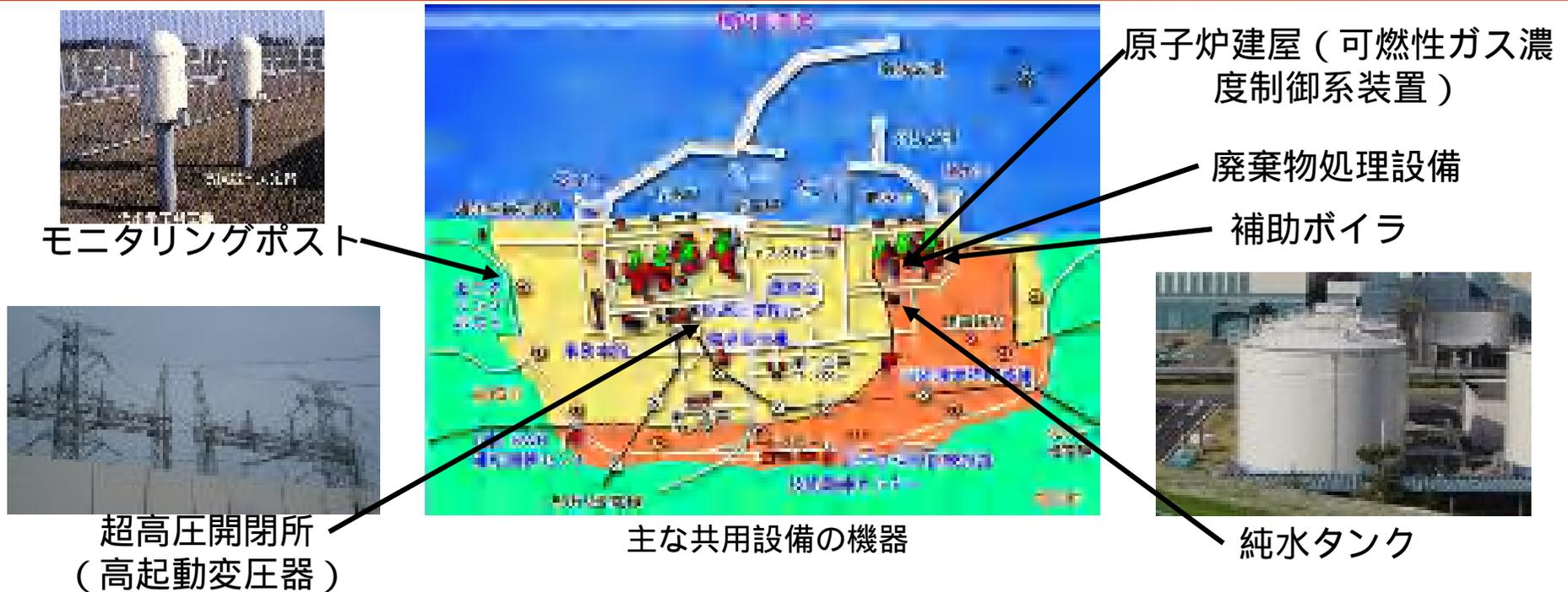
7号機のプラント全体の機能試験に必要な共用設備として477機器を抽出し、機器レベルの点検を実施した。25機器に不適合が確認されたが、いずれも原子炉安全を阻害する可能性はない事象であった（地震影響あり21機器、その他経年劣化事象4機器）。その中で、構造強度や機能維持へ影響を及ぼす可能性のあるものは4機器であったが、いずれも補修、取替により原型復旧できる事象であった。なお、これらの機器はすべて補修が完了済み。また、共用設備の系統レベルの機能試験として補助ボイラ試運転検査など実施し、異常がないことも確認済み。
