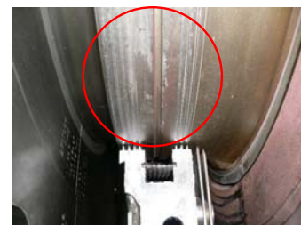
タービン軸 (タービンロータ) の軽微な接触痕
