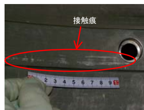
ジャーナル軸受の軽微な接触痕
