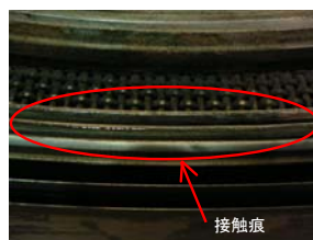
軸受油切りの軽微な接触痕
