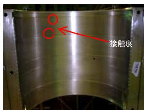
ジャーナル軸受の軽微な接触痕
