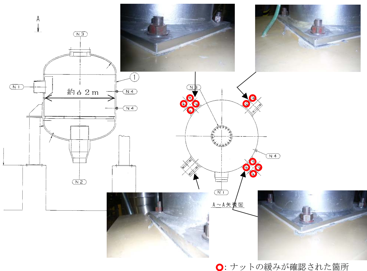
図-2 原子炉冷却材浄化系再生熱交換器の事象
