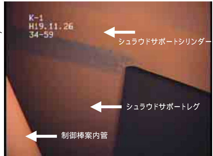
シュラウドサポートレグを炉心側から目視点検する様子
