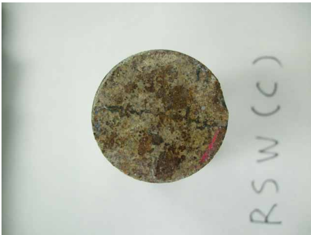
図-1.6 KK-6 T/B RSW (C)コンクリートコア (床面側)
