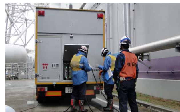
「訓練の充実・強化」 柏崎刈羽における電源車や消防車を使った緊急安全対策訓練の様子 (平成23年4月11日に実施)
