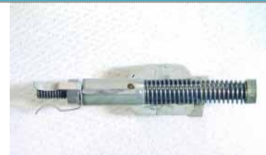
上部タイプレートの孔食の例 (90℃、Cl - 濃度:2500ppm、2000時間、上部端栓は照射材)
