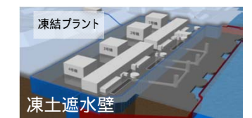
(延長: 約1,500m、凍土量: 約7万m 3 )
