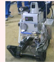
汚染状況調査用ロボット（ガンカメラ搭載）
