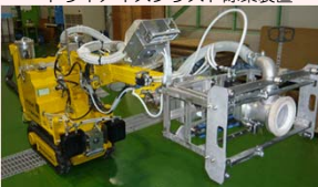
高圧水除染装置
