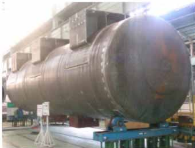
製作中の鉄製スラッジ貯蔵タンク (外観)
