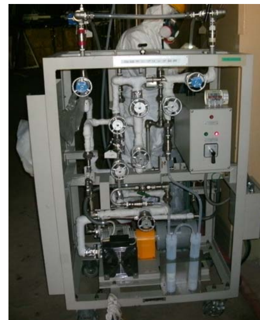
福島第一1号機原子炉格納容器仮設ガスサンプリング装置 撮影者：東京電力株式会社 撮影日：平成23年9月14日
