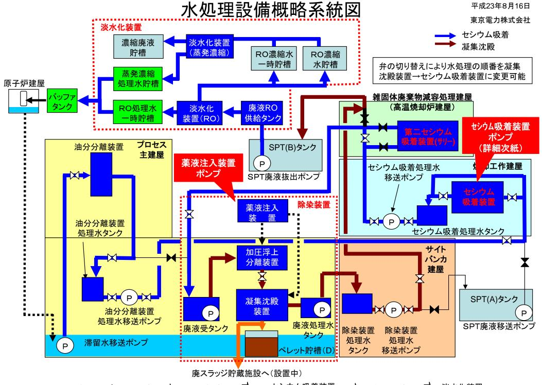
水の流れ: プロセス主建屋 □ 油分分離装置 □ セシウム吸着装置 □ 凝集沈殿装置 □ 淡水化装置 (第二セシウム吸着装置)
