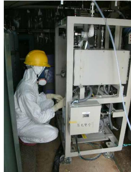
福島第一2号機原子炉格納容器仮設ガスサンプリング装置
